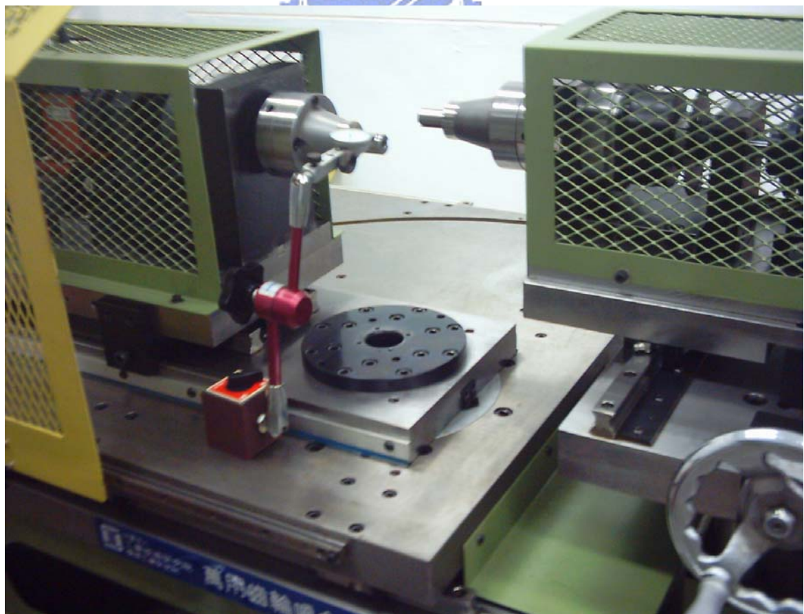
圖 3.18 齒輪接頭安裝之平行度校驗(水平方向)照片
