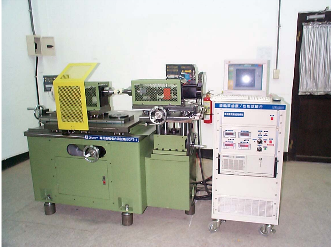
圖 3.10 九十二年六月組立完成之泛用型齒輪測試機照片
