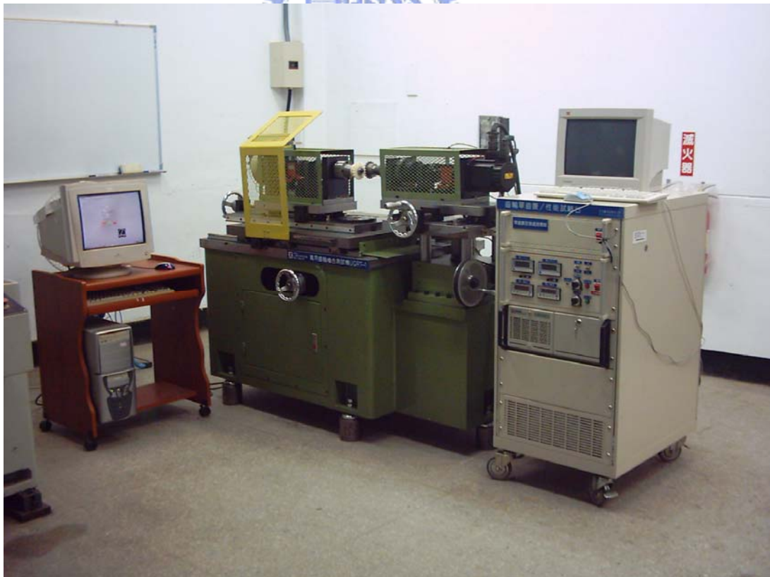
圖 3.11 九十三年五月發展完成之泛用型齒輪測試機照片 (另加一組個人電腦作齒輪傳動誤差之數據擷取及處理)
