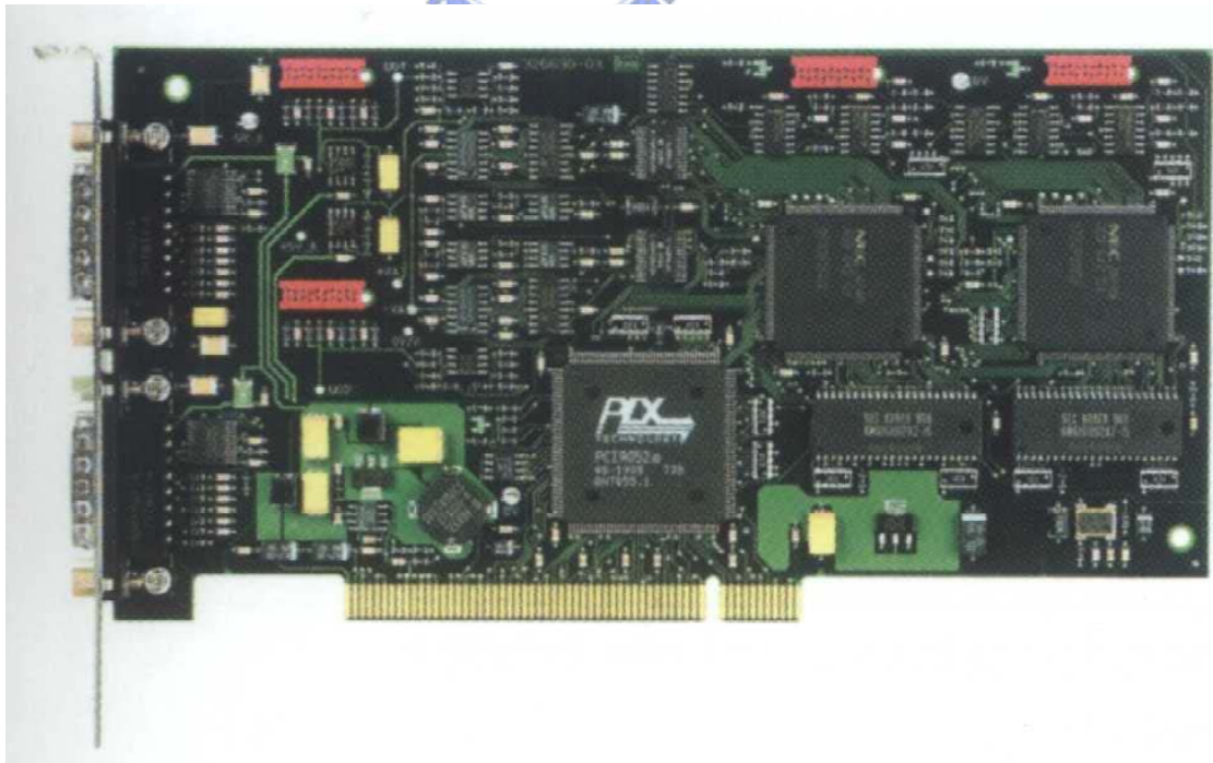
圖 3.4 泛用型齒輪測試機之數據擷取卡外觀圖
