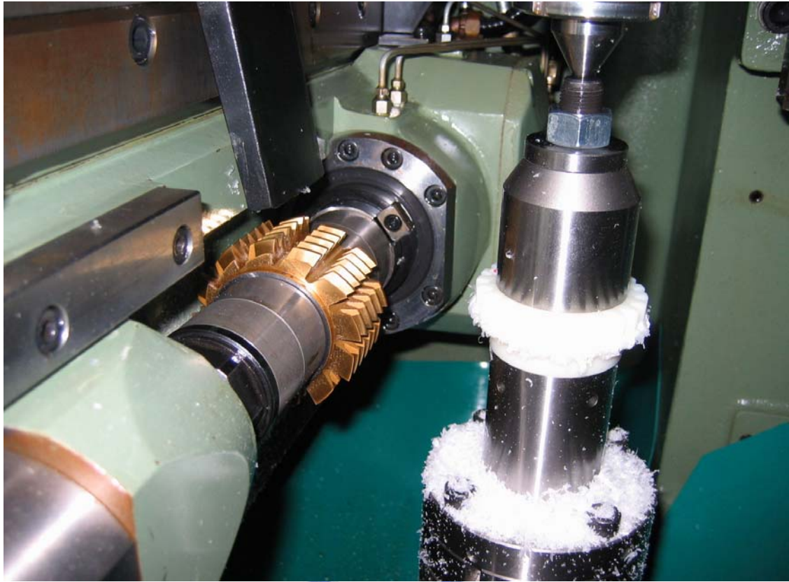
圖 3.16 測試齒輪之滾齒加工照片
