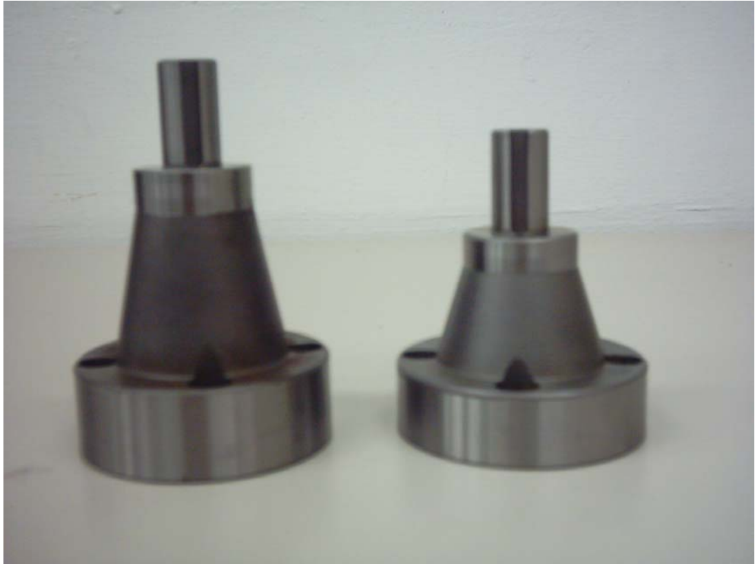
圖 3.12 泛用型齒輪測試機之輸入軸與輸出軸凸緣照片
