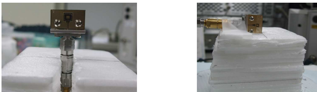
圖 4.8.4 左圖是量測 H-Plane 製具現場，右圖是量測 E-Plane 製具現場
