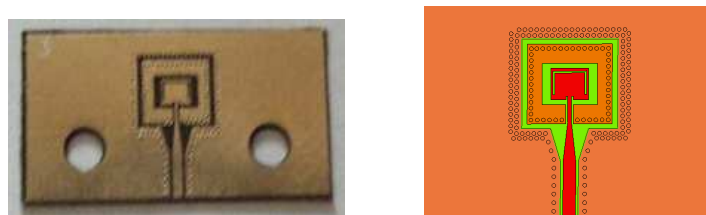
圖 4.8.9 U 型縫隙背腔式共振腔天線實做與模擬圖
