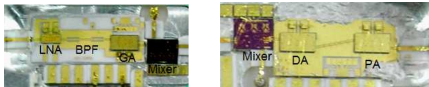
圖 5.4 60 GHz 收發機內部電路放大圖(左圖接收端電路、右發射端電路)
