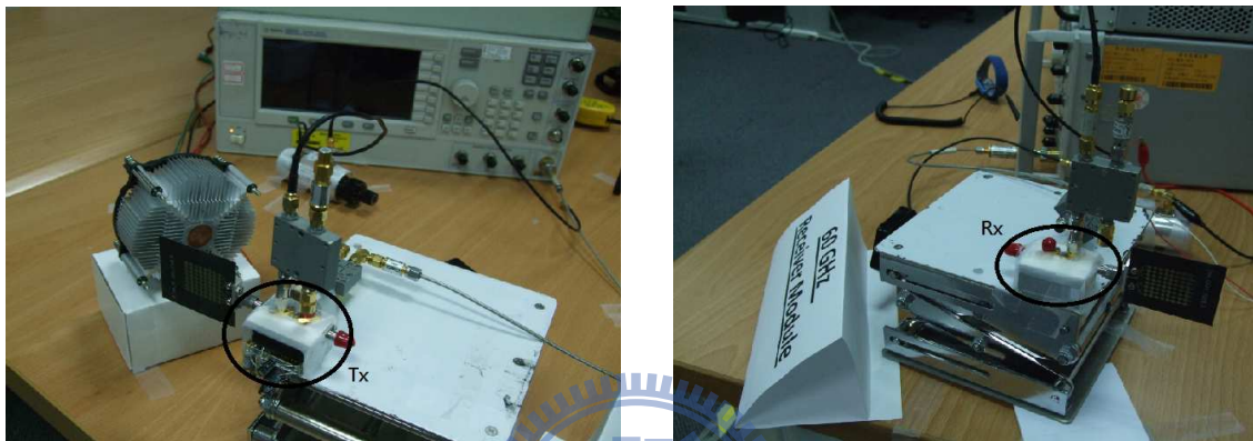
圖 5.20 60GHz 毫米波系統對傳近照(左邊:發射端模組、右邊:接收端模組)
