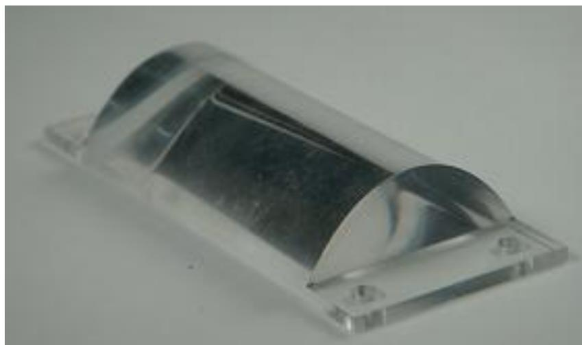
圖 3-15 柱狀透鏡照片
