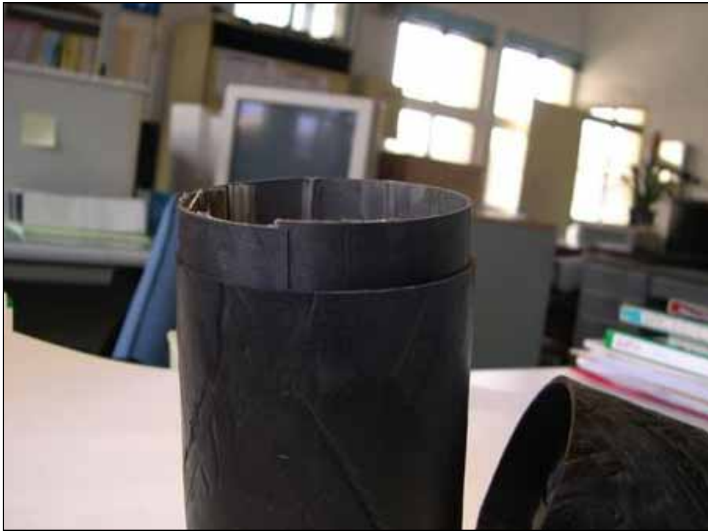
圖 6-15 預浸材與纏繞部份已脫離
