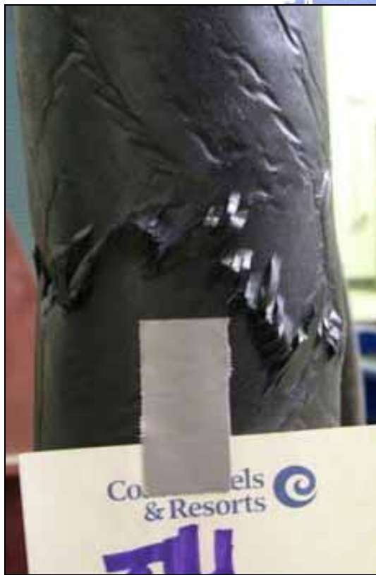
圖 6-18 圓桿受壓力破壞紀錄(1)
