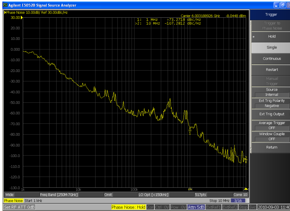
圖 4.23 Agilent E5052B Signal Source Analyzer 的 phase noise 測試
