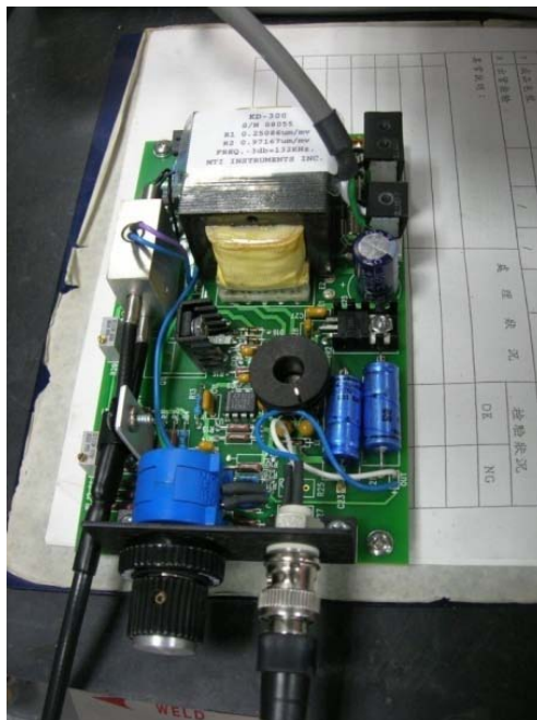
圖 E-1：MTI KD-300 光纖位移感測器
