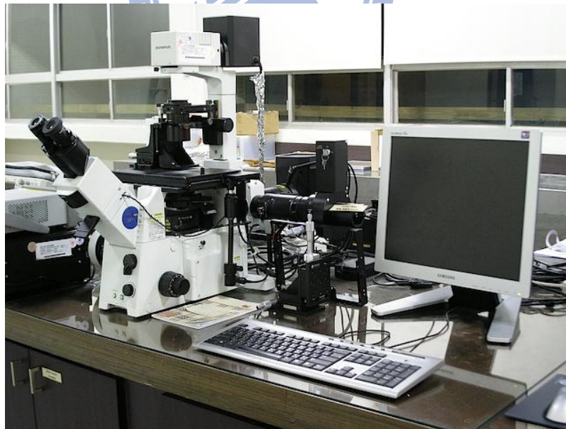
圖 16 倒立式螢光顯微鏡
