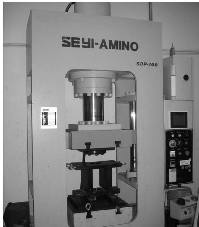
圖 3-13 100 噸油壓壓床
