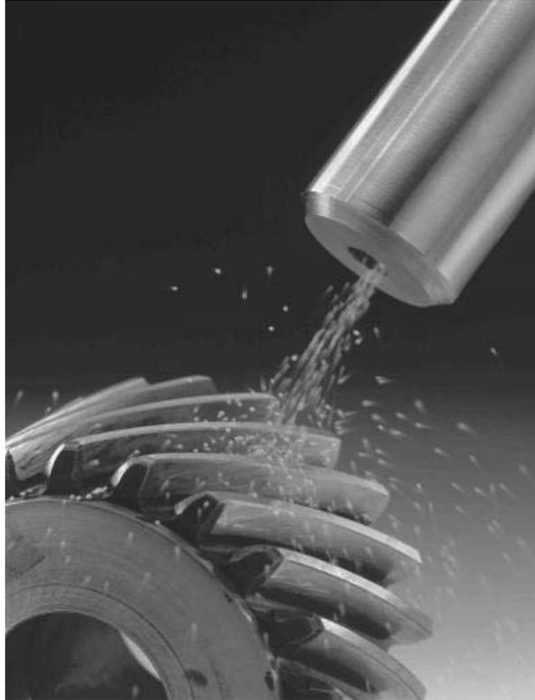
圖 2-4 超音速鋼球撞擊
