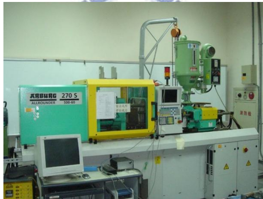
圖 3.1 ARBURG 製 ALLROUNDER 270 S 射出成形機
