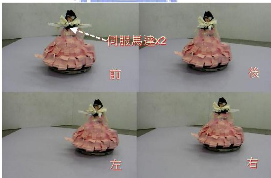
圖 5.16 伺服馬達裝於機器人手部之實驗動作圖
