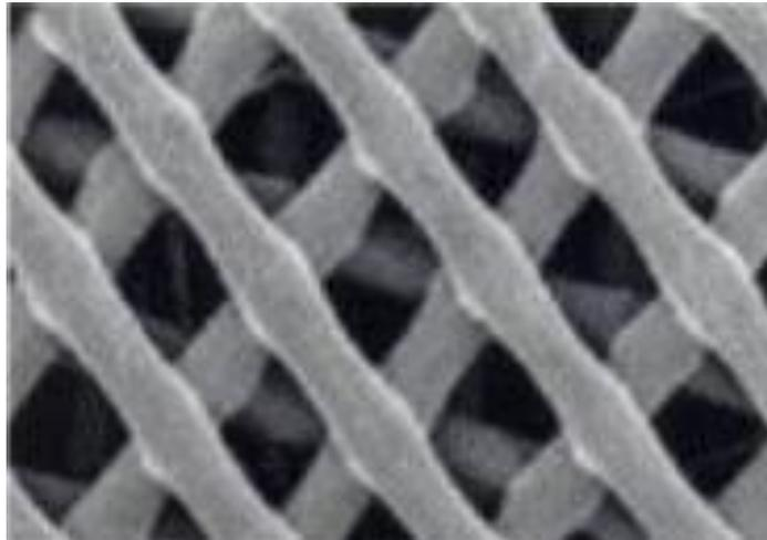
圖 1-1 多孔性細胞支架結構
