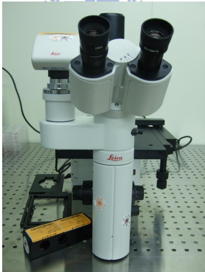
圖 3-13 倒立式光學顯微鏡
