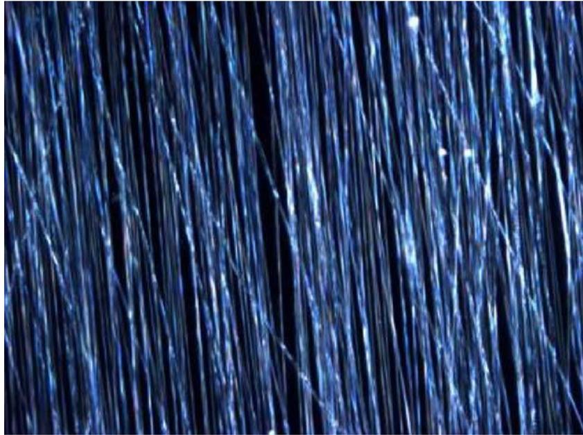
圖2-5 光學顯微鏡觀測下之具直線性纖維支架
