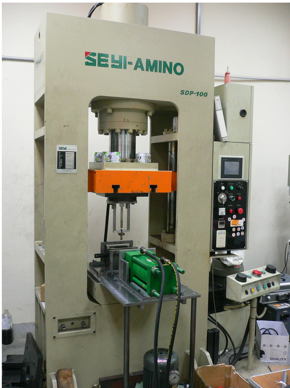
圖 4-3 100 噸油壓式壓床
