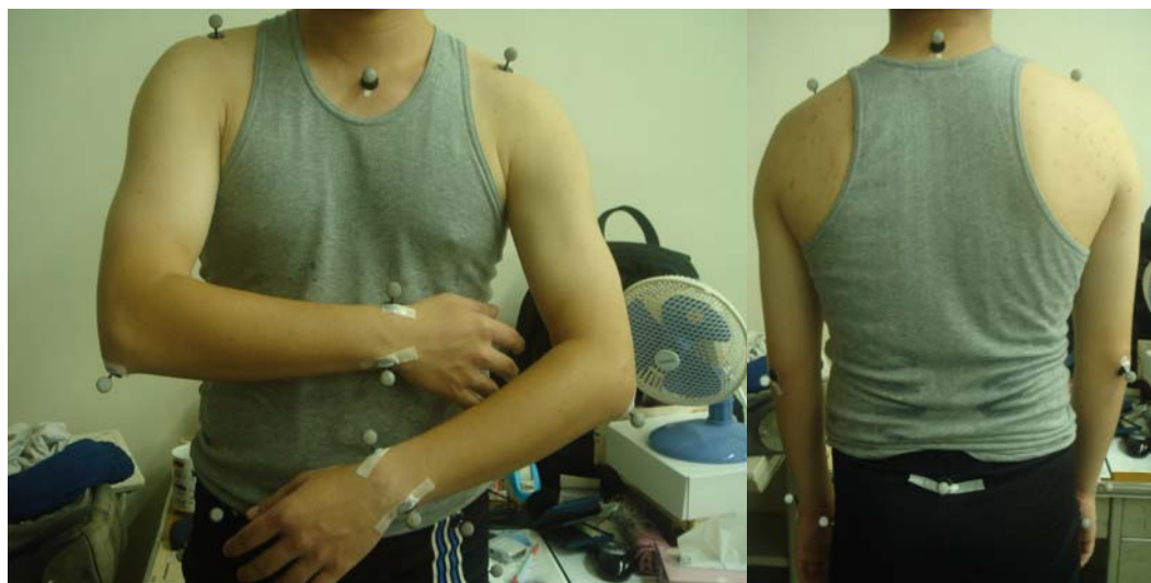
圖 5 受測者的反光式標記(reflective markers)設置
