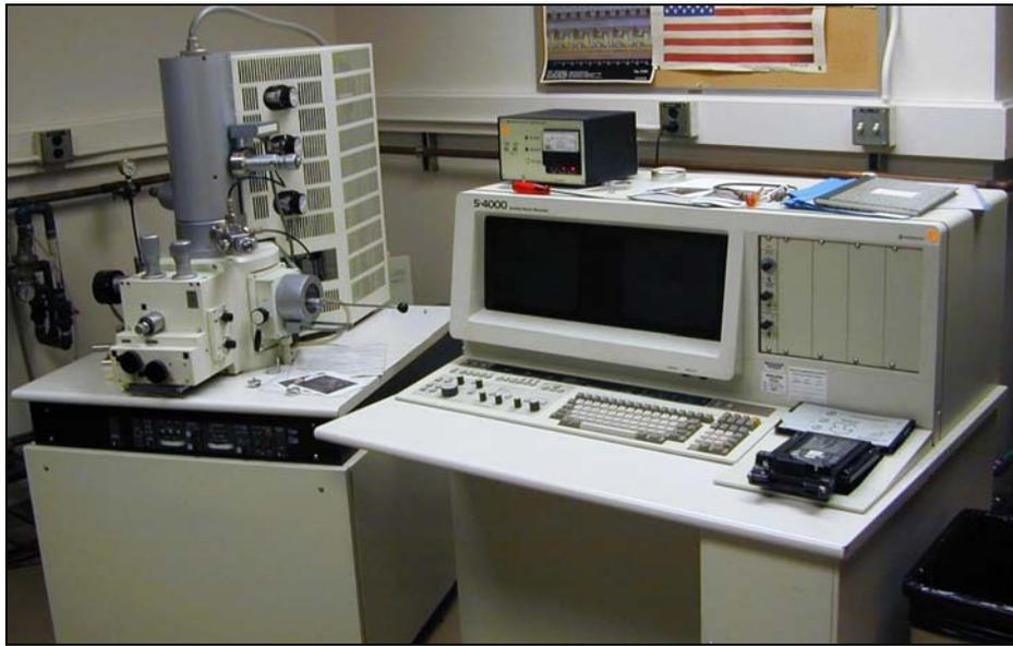
圖 3-3 掃瞄式電子顯微鏡
