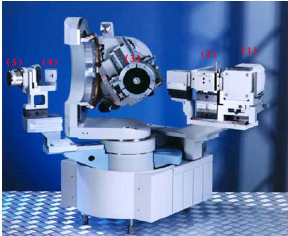
圖3-5 X光繞射儀
