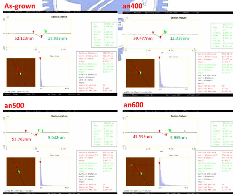
圖 4-30  $\text{Si}_{0.8}\text{Ge}_{0.2}/\text{Si}$  異質接面結構 as-grown、an400、an500 和 an600 之 nanoindenter FM 一次負載 10mN AFM-剖面圖 (5  $\mu\text{m}$ ) 綜合分析圖。
