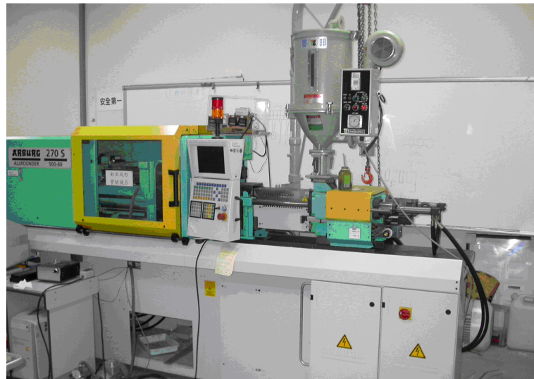
圖 3.1 ARBURG ALLROUNDER 270S 射出成形機示意圖
