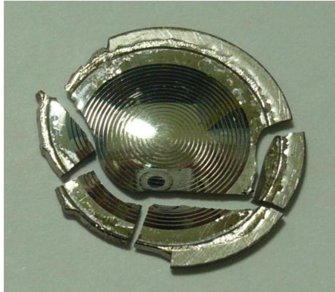
圖 4.19 微結構實驗後模仁破裂外觀圖
