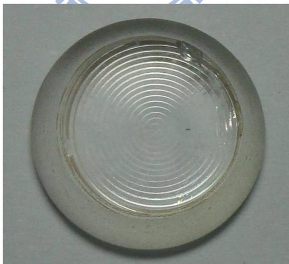
圖 3.28 玻璃熱壓微結構成品
