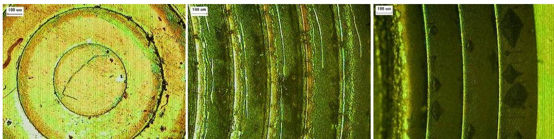
圖 3.30 鎳鈷合金模仁實驗後顯微鏡圖，左圖為結構中央處，中圖為模仁 Fresnel 溝槽結構與玻璃接觸處，右圖為模仁 Fresnel 溝槽結構未接觸到玻璃
