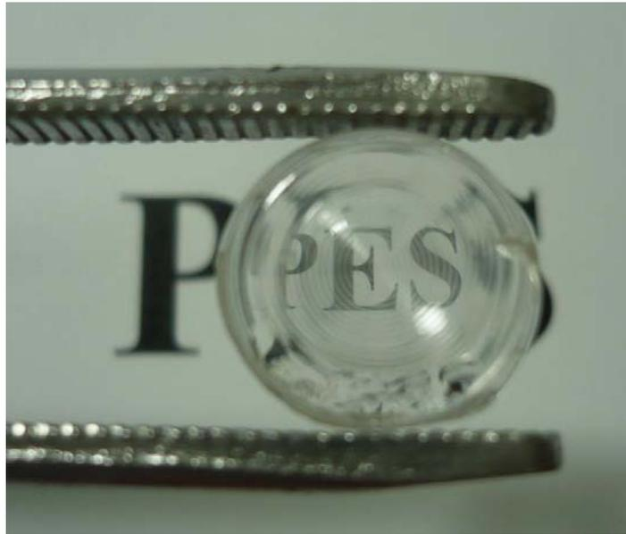
圖 4.18 Fresnel 結構之凹透鏡光學效果
