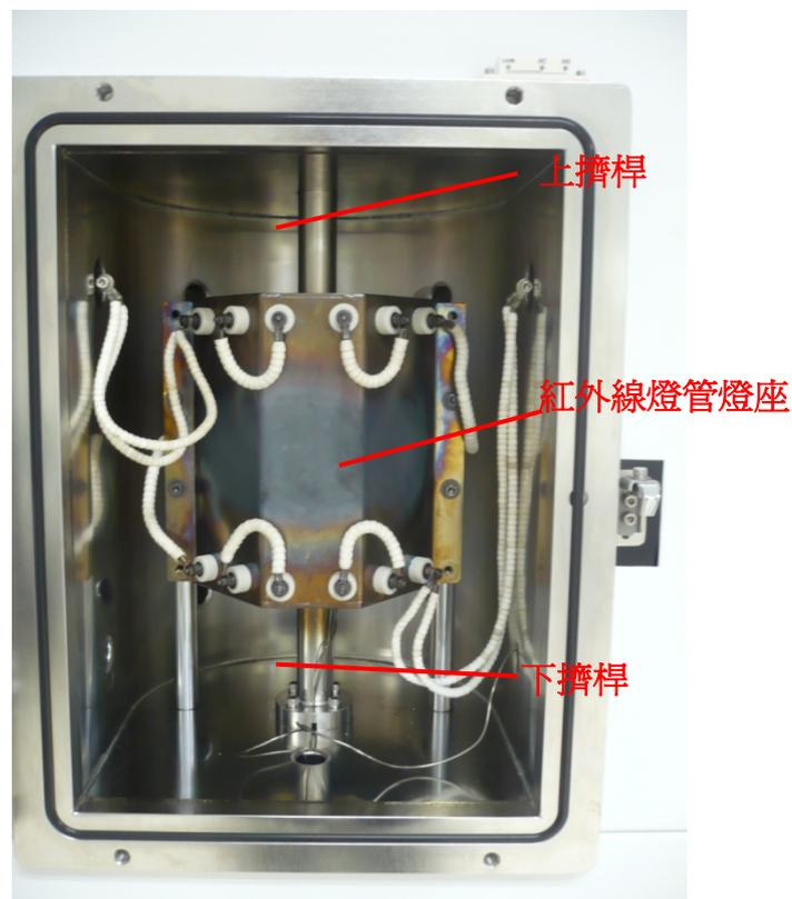
圖 4.3 實驗設備燈管與擠桿配置外觀圖
