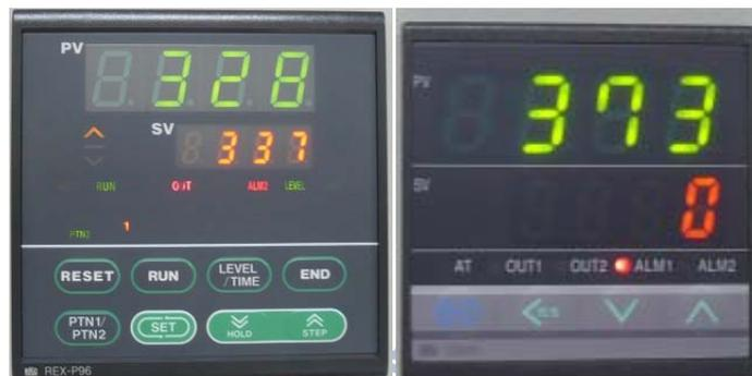
圖 4.11 上下模仁溫度控制顯示器
