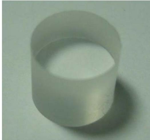
圖 4.14 K-PSK100 玻璃試片
