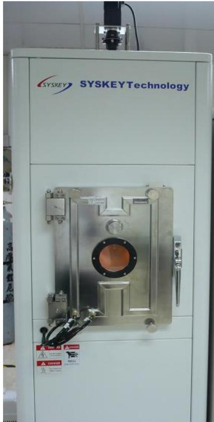
圖 4.1 微結構熱壓實驗設備加熱系統外觀圖
