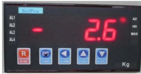
圖 4.10 壓印力控制顯示器
