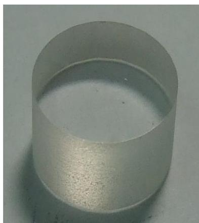
圖 A.4 L-BAL42 玻璃試片外觀圖
