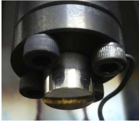
圖 4.8 碳化鎢平面拋光模仁組裝外觀圖
