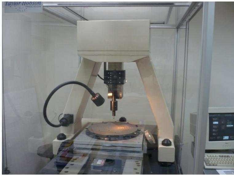
圖 3.24 表面粗度輪廓儀外觀圖
