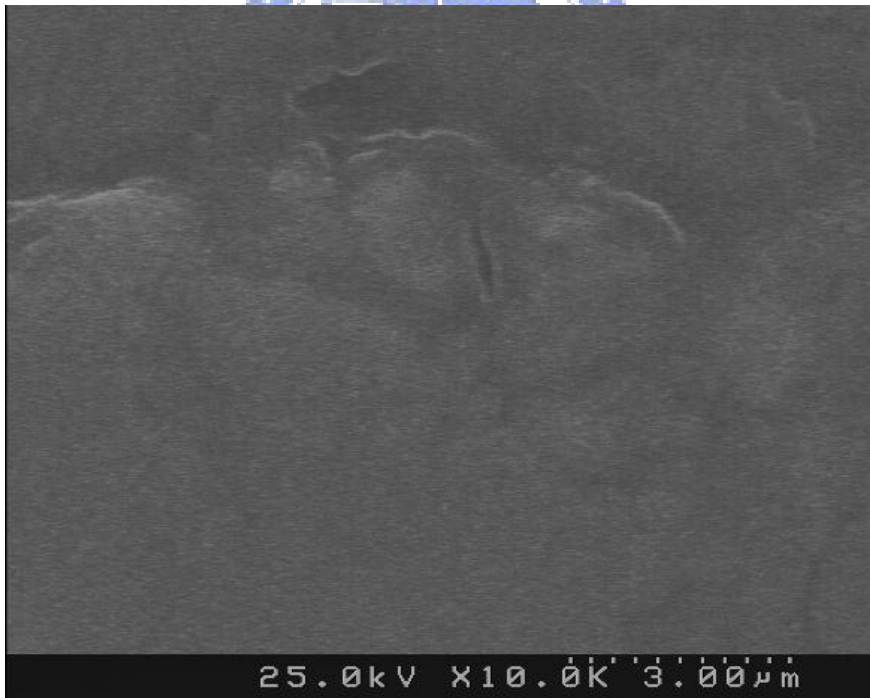
圖 4-12 PMMA 濺鍍 Cu 薄膜 SEM 平面觀察圖
