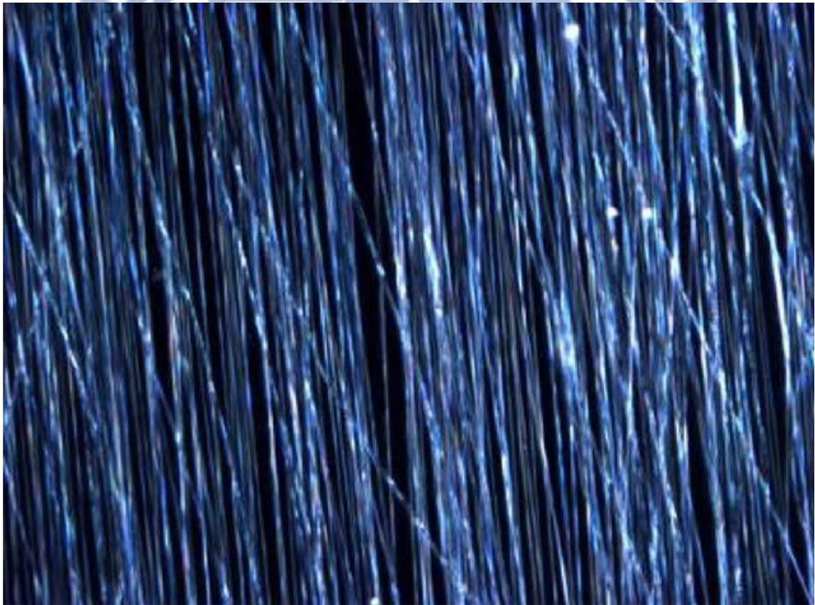
圖 2-4 光學顯微鏡觀測下之具直線性纖維支架[51]
