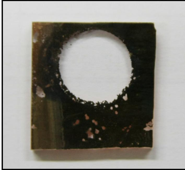
圖 4-28. O<sub>2</sub> plasma 表面改質腐蝕後試片圖
