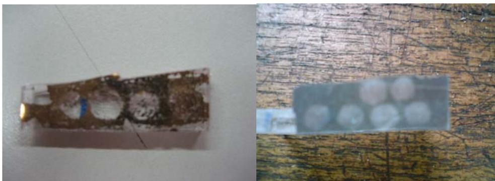
圖 4-46. 改質 PMMA 電鍍金薄膜正向附著力試驗後試片
