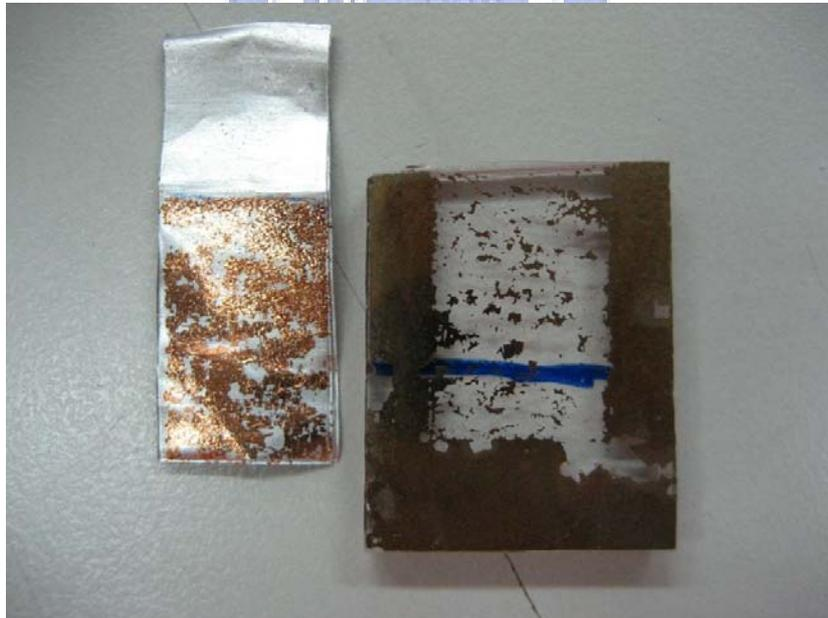
圖 4-60. 改質 PMMA 電鍍金薄膜側向附著力試驗後圖片
