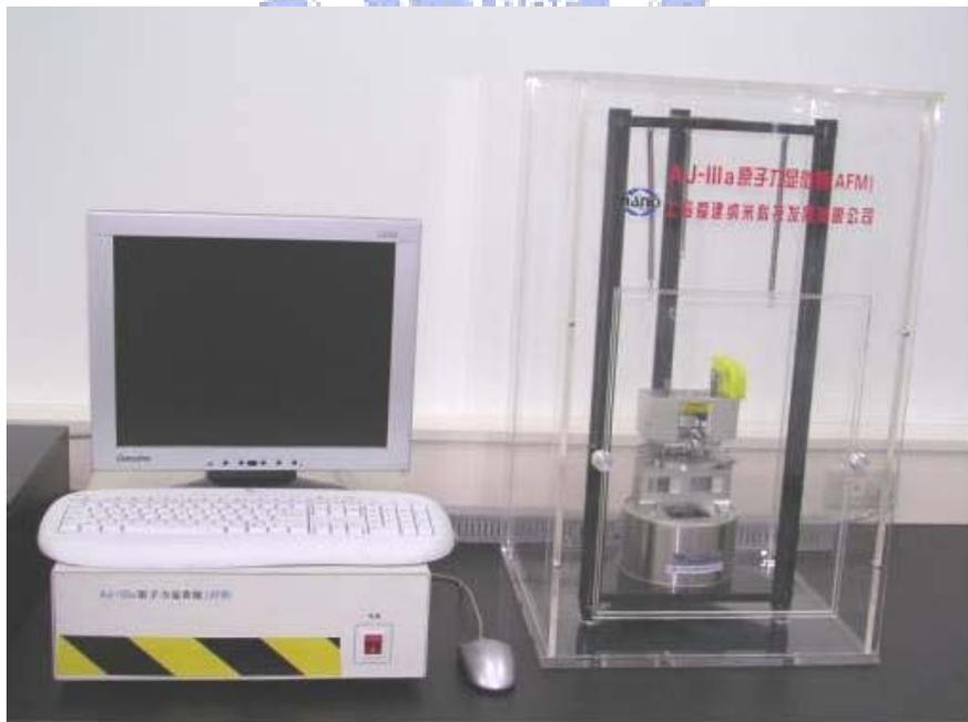
圖 3-7. 原子力顯微鏡系統
