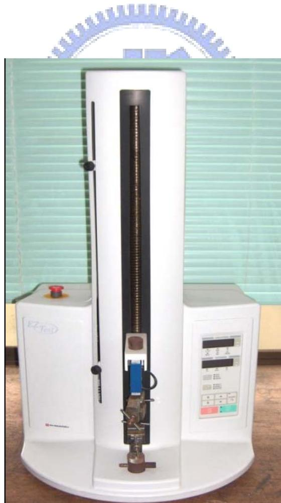
圖 3-9. 萬能材料試驗機實體圖
