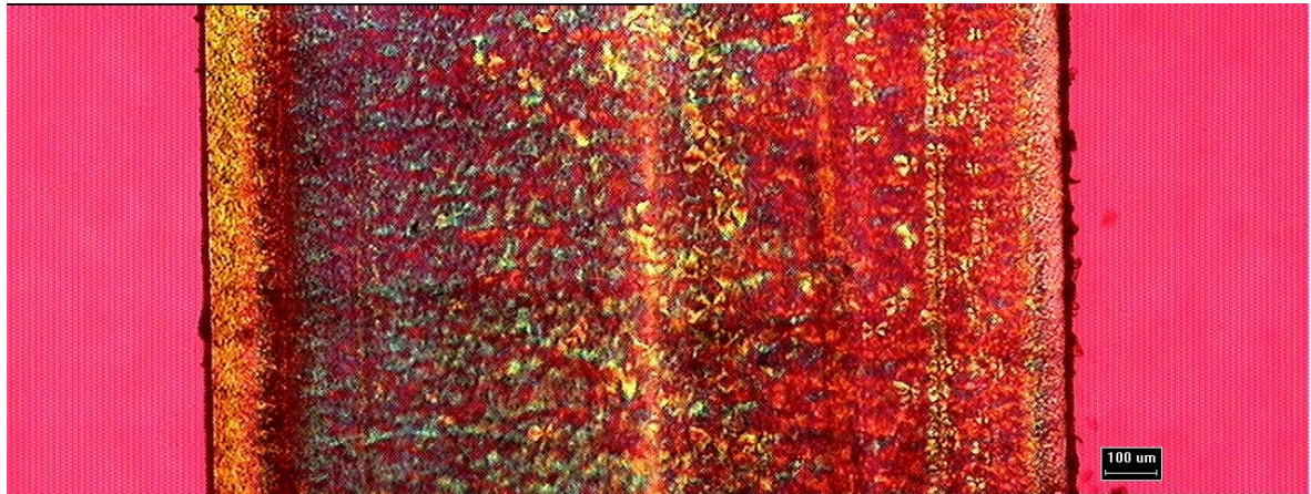
圖 4-4 無微結構、冷卻水溫 50°C、無雷射照射的熱壓成形試片的厚度截面之偏光顯微鏡照片。倍率 50X (銳敏色板)
