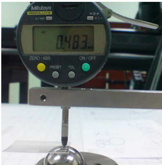
圖 3-35 量測厚度不同導光板的殘留層
