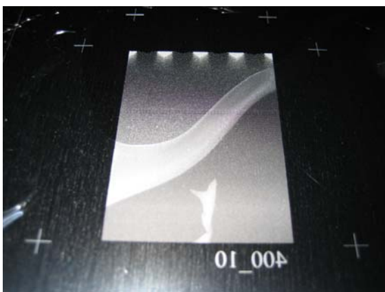
(a)UV 膠未完全固化造成脫模失敗
