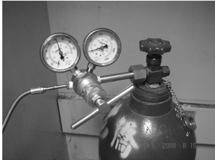
圖 4-11 氫氣鋼瓶及降壓調節閥
