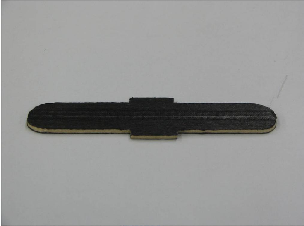
圖 5-5 熱壓成型之複合材料揚聲板
