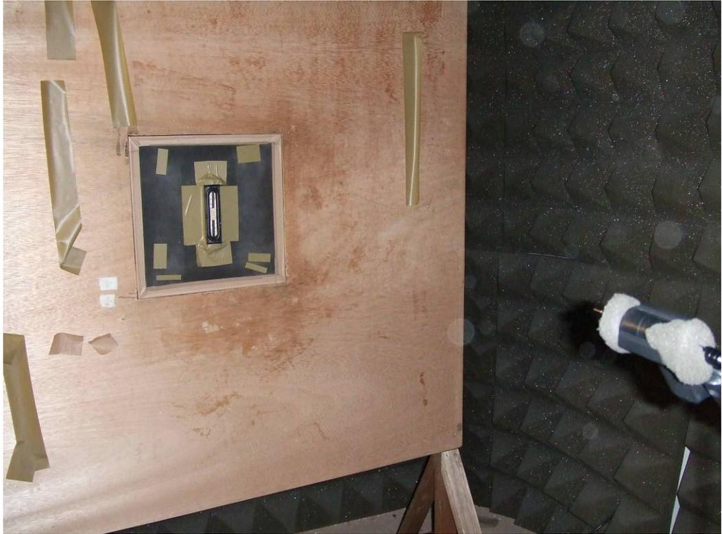
圖 5-13 揚聲器聲壓量測實驗示意圖
