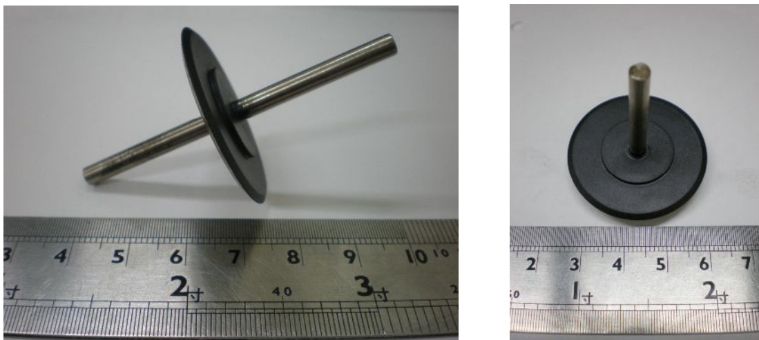
圖 4.7 超音波馬達的轉子表面鍍鐵氟龍表面處理
