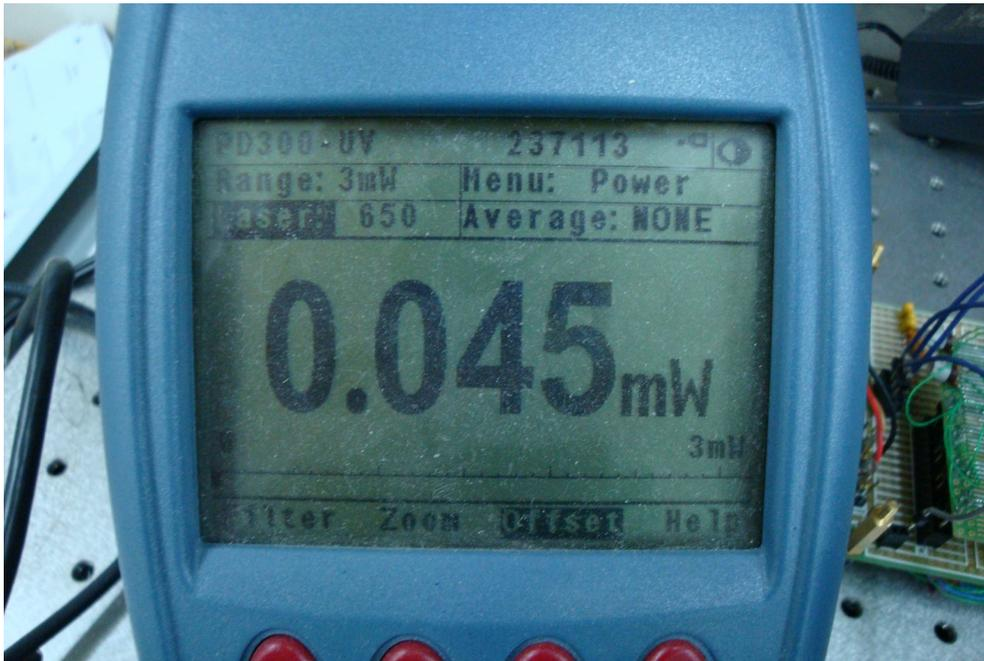
圖 4.3.3 由光碟片回傳至光偵測器之紅光雷射於光功率計所顯示之讀數
