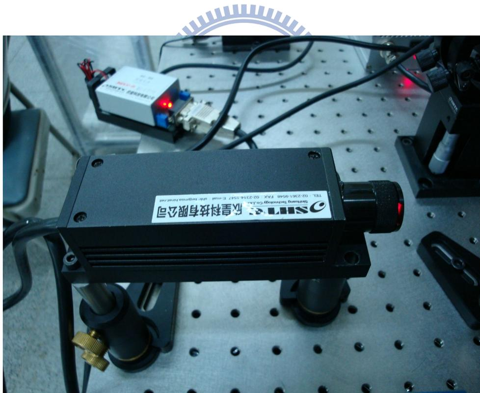
圖 4.1.3 紅光雷射光源(波長 635 nm)
