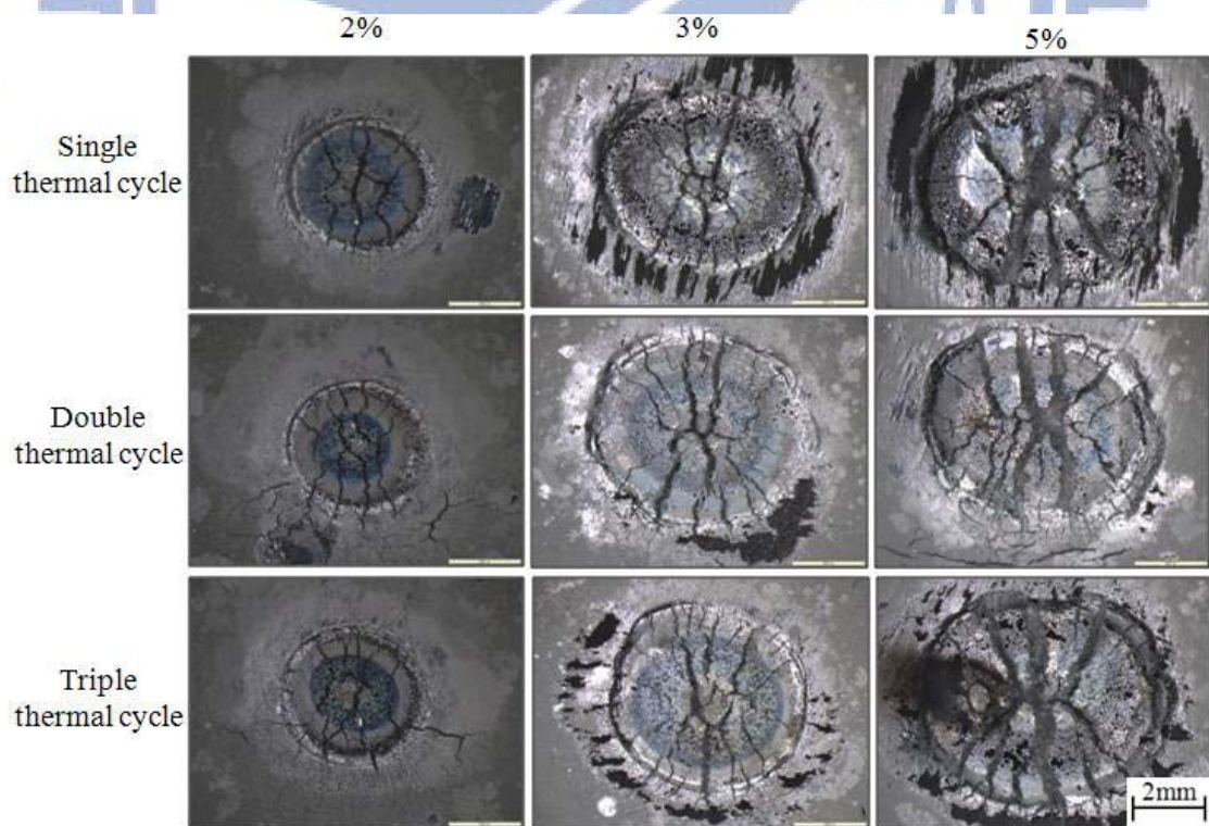
圖 4-16 M7E 含鈦鋁合金經歷不同熱循環次數與應變量之熱裂縫巨觀 型態觀察
