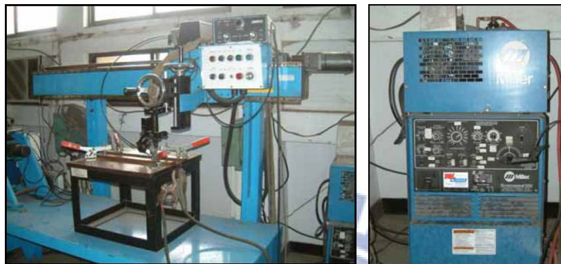
圖 3-2 Gullco—GK191-P/18A 型自動走鐸機 Miller—Syncrowave 250 型惰氣鎢極電弧鐸接機
