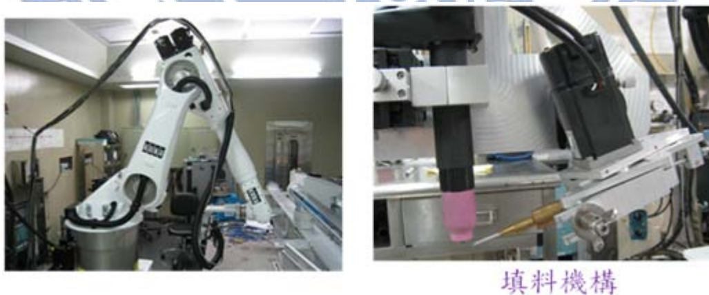
圖 3-10 惰氣鎢極電弧銲接設備
