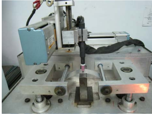
圖 3-4 可調應變試驗之試驗情形
