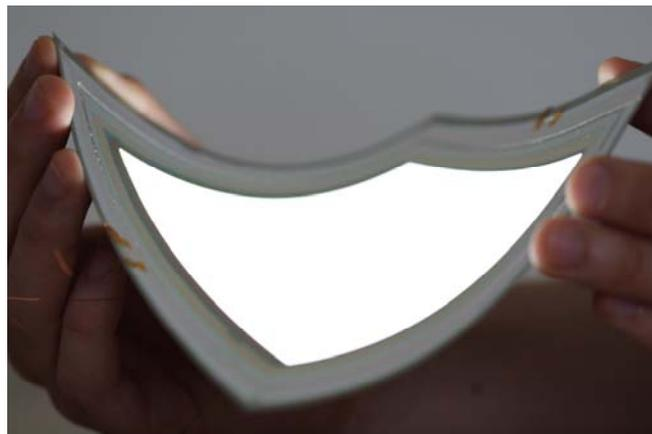
圖 1-12 利用 Orgacon™ 製作的大面積 OLED 照明
