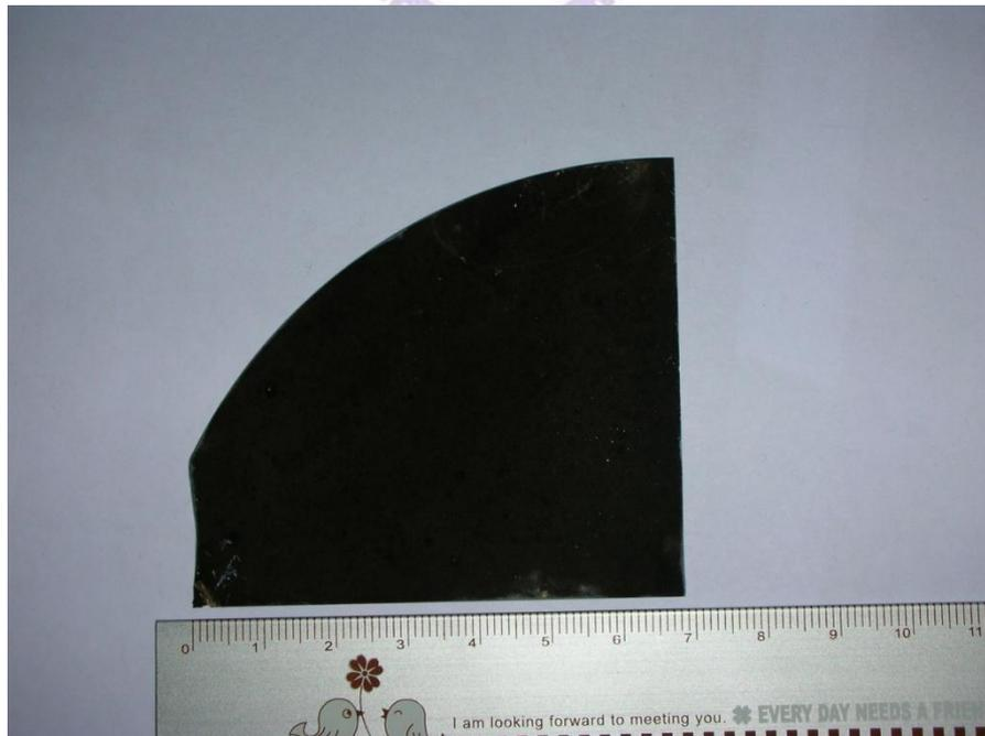
圖 2-16. 製作出四分之一的六吋晶片試片。
