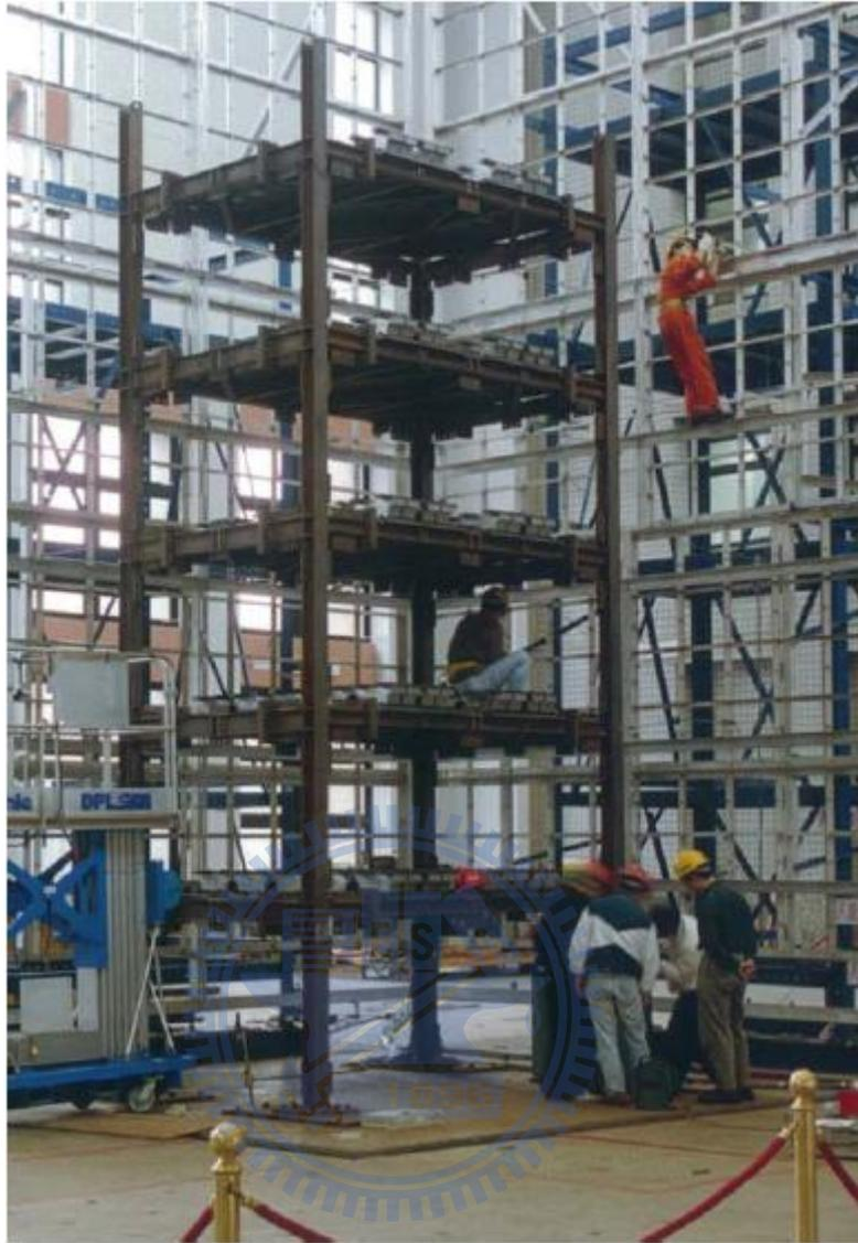
圖 4.1：國家地震工程研究中心之五層樓鋼構架
