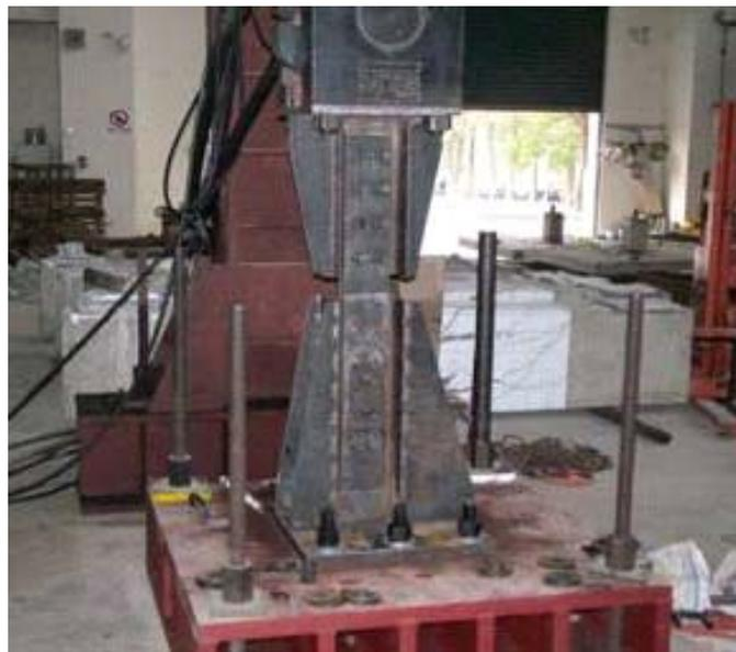
圖 2.13 摩擦阻尼斜撐測試構架組裝完成照片
