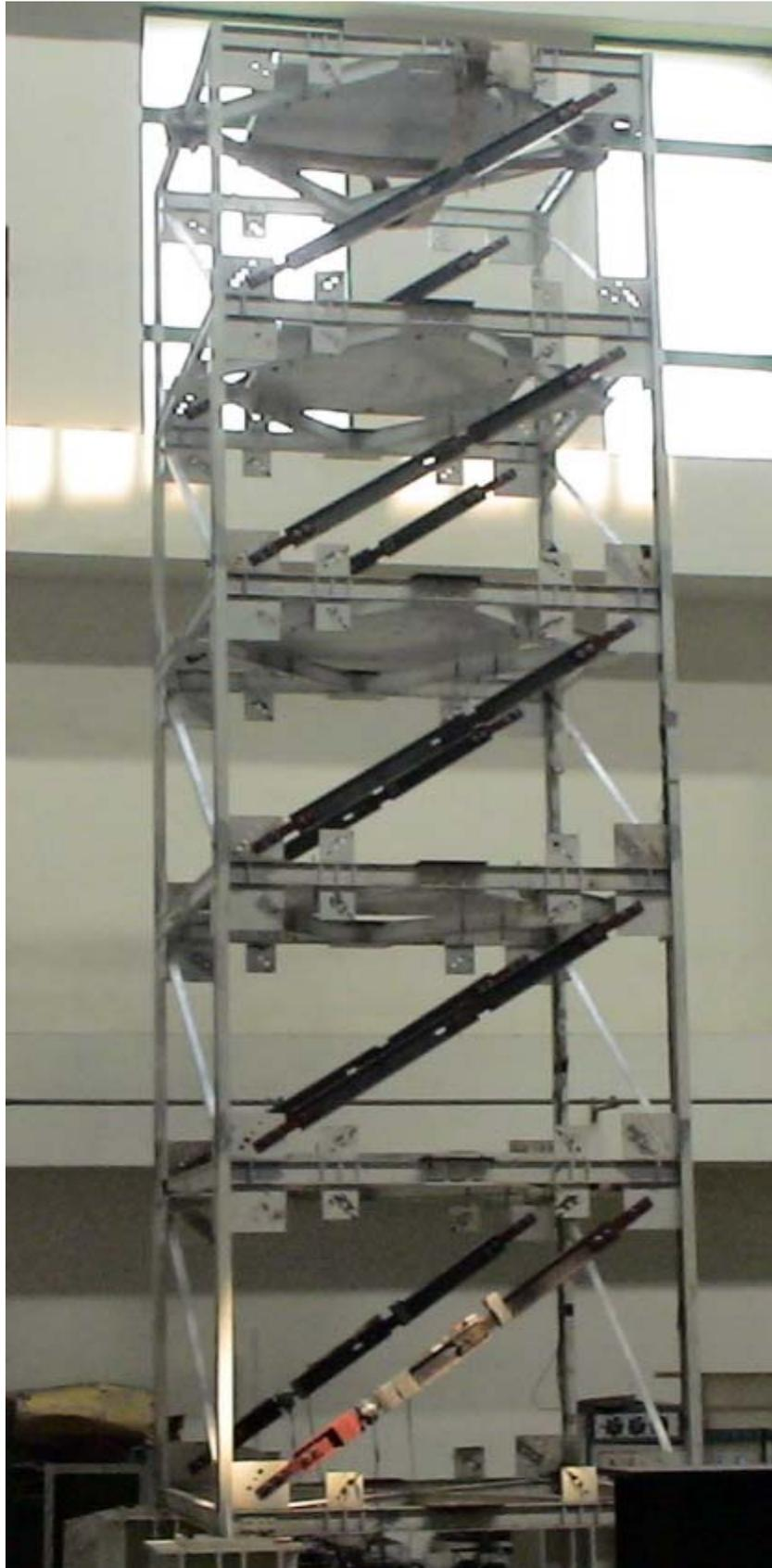
圖 4.21 摩擦阻尼斜撐耐震性能測試構架組裝完成照片
