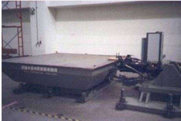
圖 4.14 地震模擬振動台
