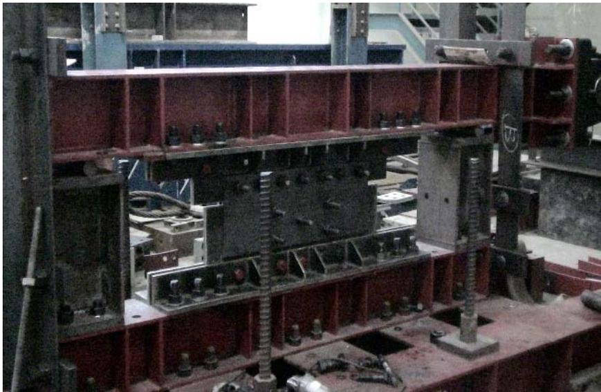
圖 2.31 摩擦制震壁測試構架組裝完成照片
