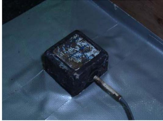
(a) 加速度規 (Accelerometers)
