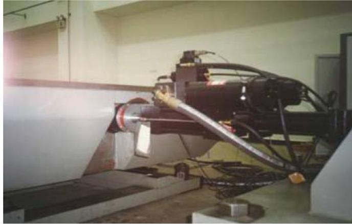
圖 4.13 振動台油壓致動器
