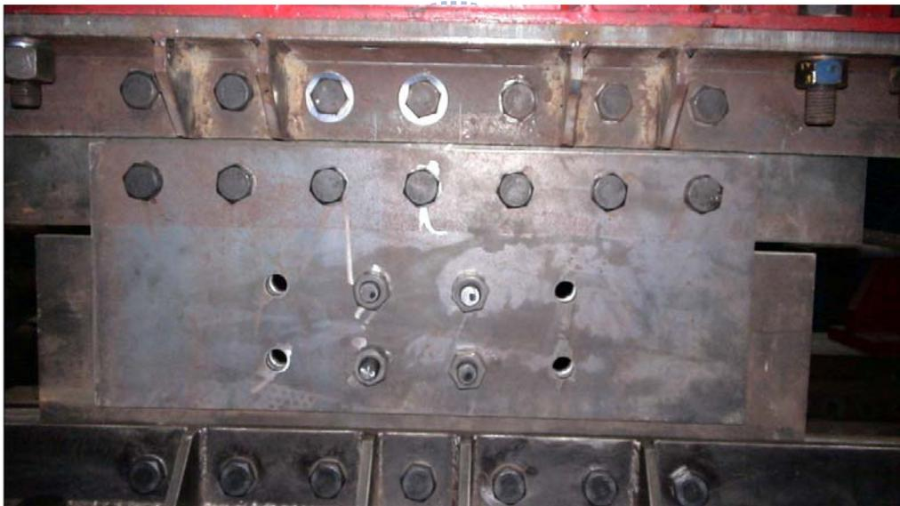
圖 2.33 螺栓集中排列(雙槽孔模式)
