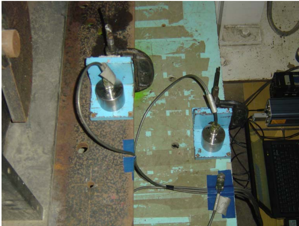
圖 5.8 加速規安裝完成
