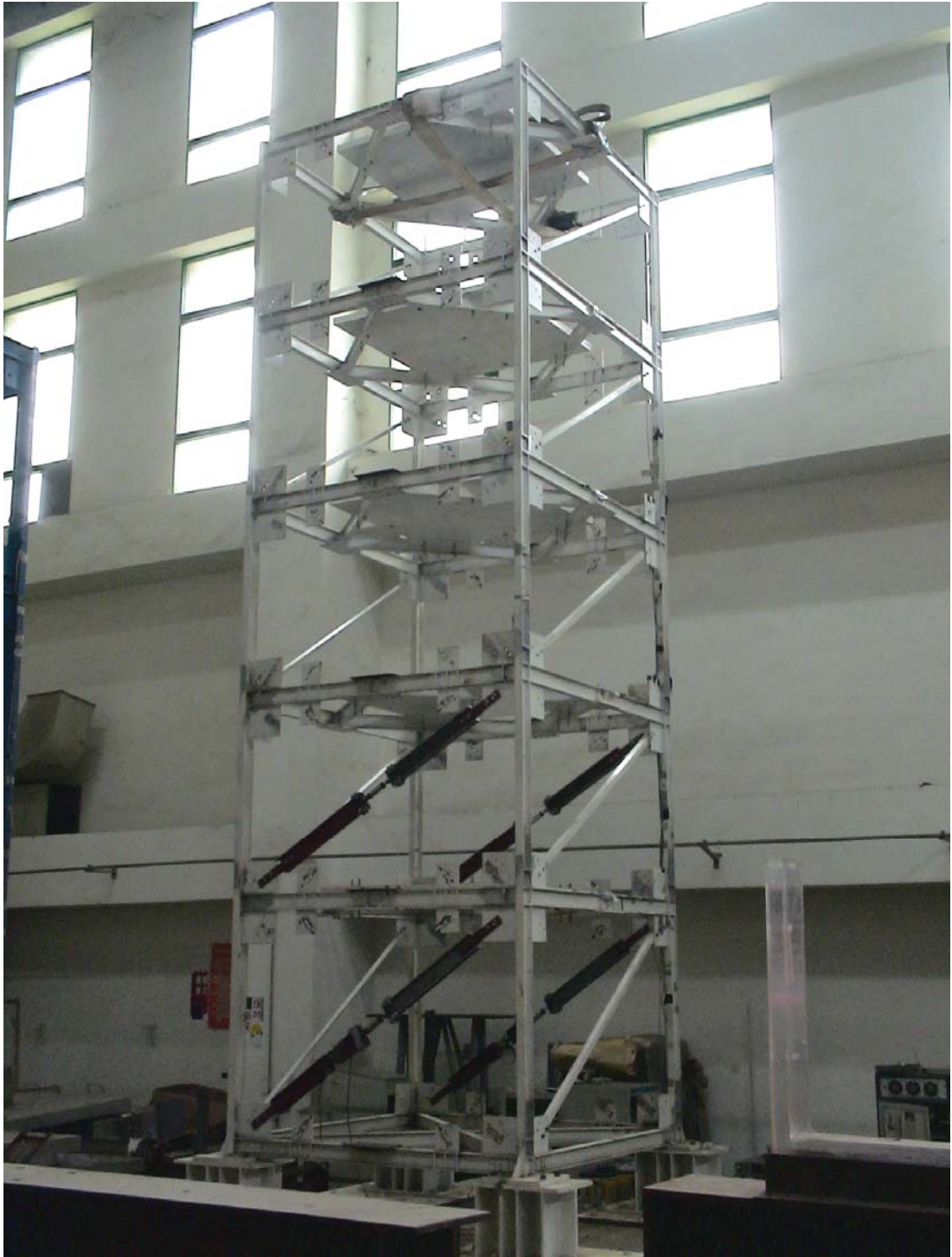
圖 5.23 五層樓鋼構耐震性能測試構架組裝完成照片
