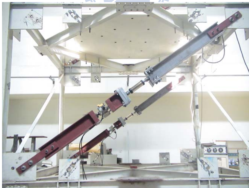
(b)液流阻尼器安裝完成照片
