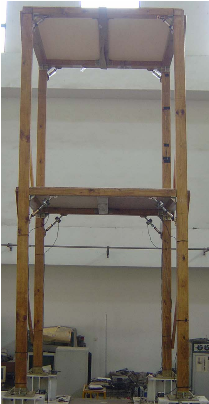
圖 5.66 裝設液流阻尼器之二層樓模型結構
