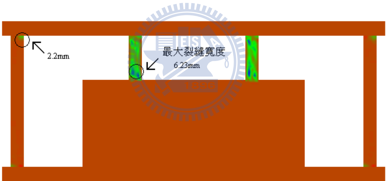
圖4.1.12 單層RC構架平面結構裂縫寬度(2/3短牆束制)
