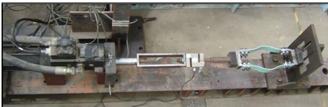
圖 4.5 預彎拱鈑元件之測試構架組裝完成照片
