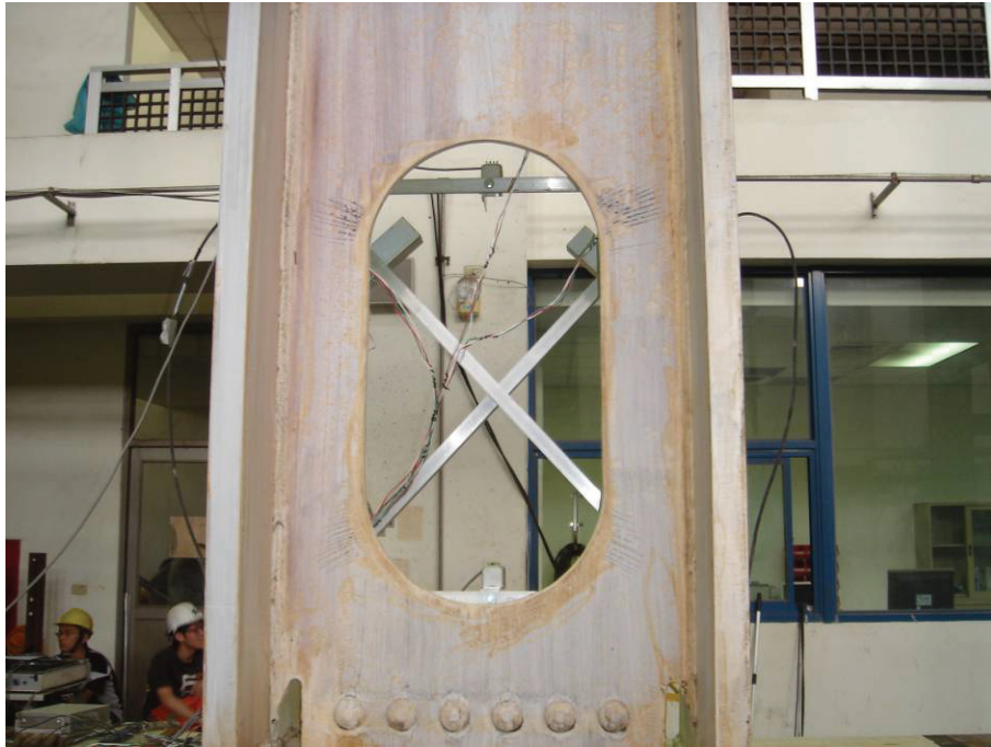
圖 4.53 試體 OP1 於開孔區段四個角隅出現明顯之石灰剝落 (1% drift)
