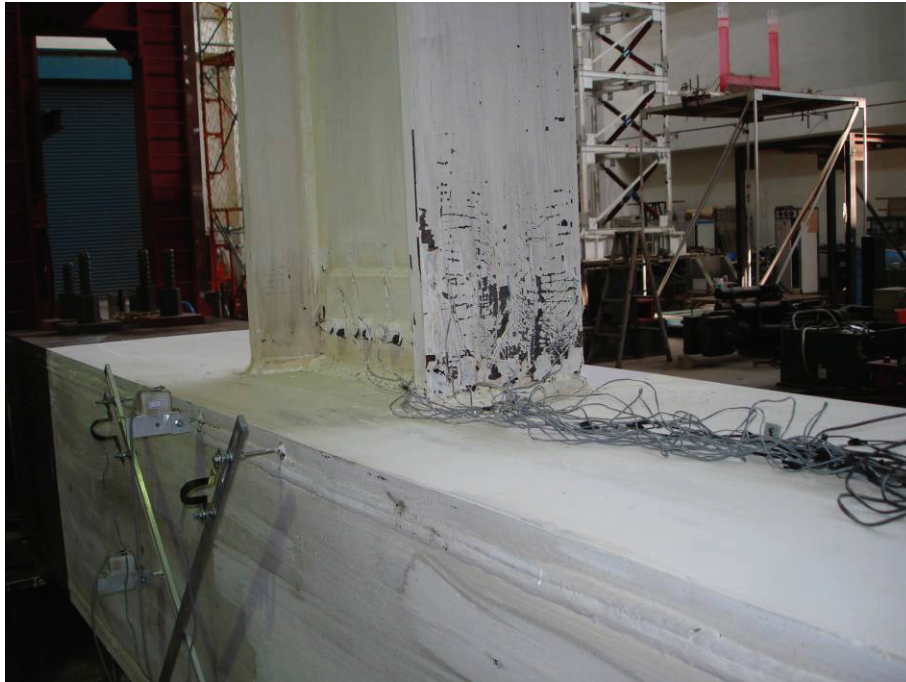
圖 4.40 試體 UN2 下翼板出現平行於梁寬度方向之石灰剝落紋路， 並有向中心發展的趨勢 (1.5% drift)
