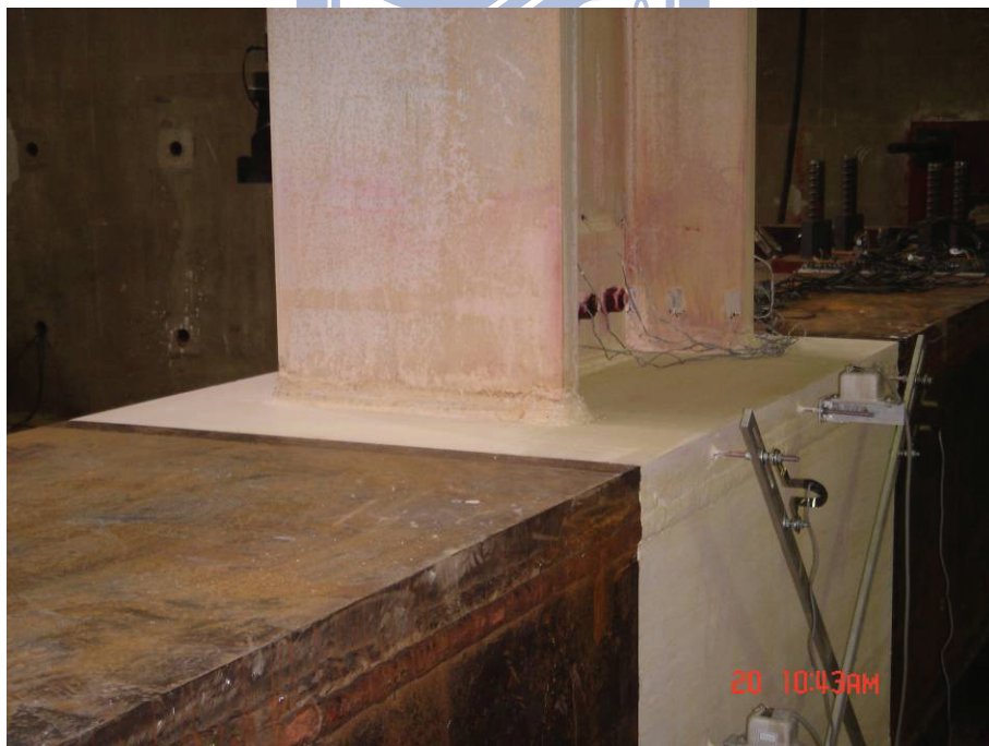
圖 4.21 試體 UN1 表面未發現明顯變化 (0.75% drift)
