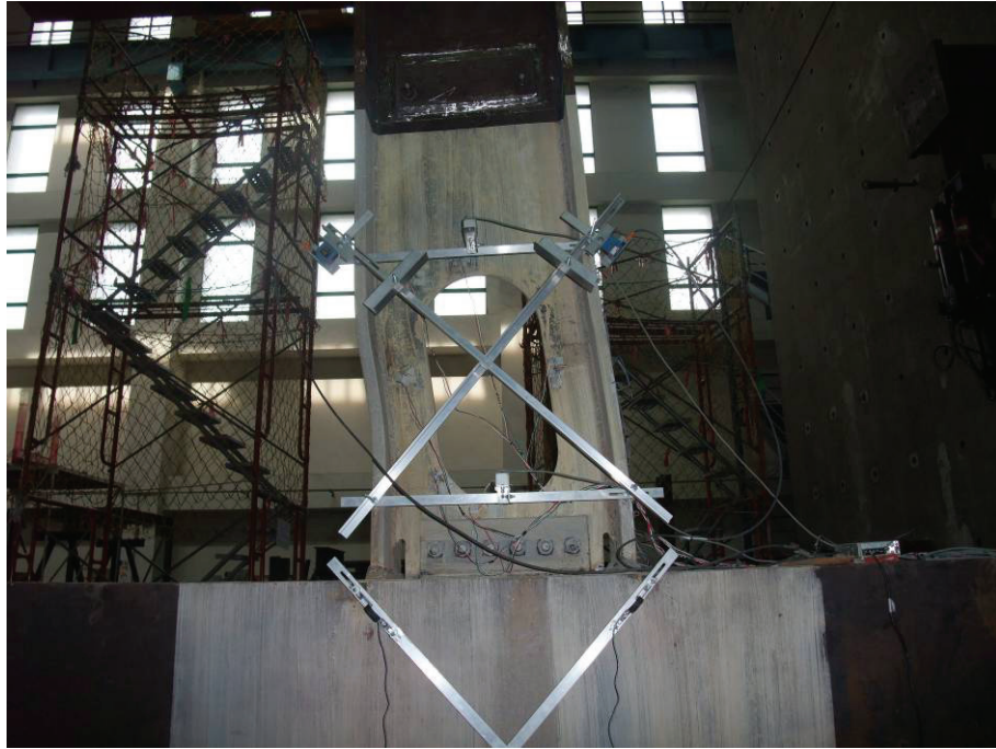
圖 4.83 試體 OP2 於開孔區段之剪力變形持續發展 (5% drift)
