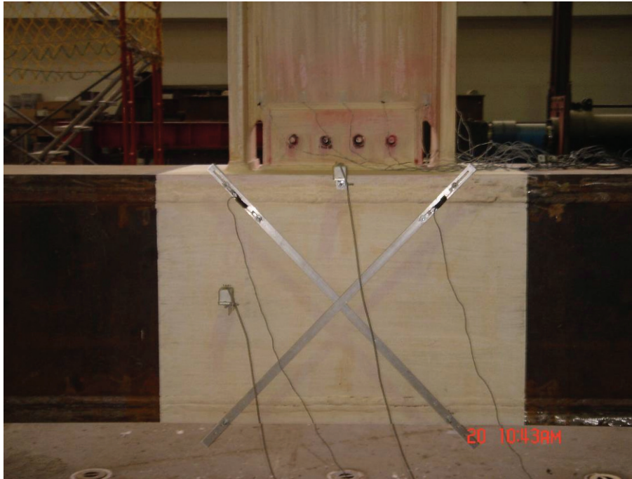
圖 4.14 試體 UN1、UN2 梁柱交會區之量測儀器配置
