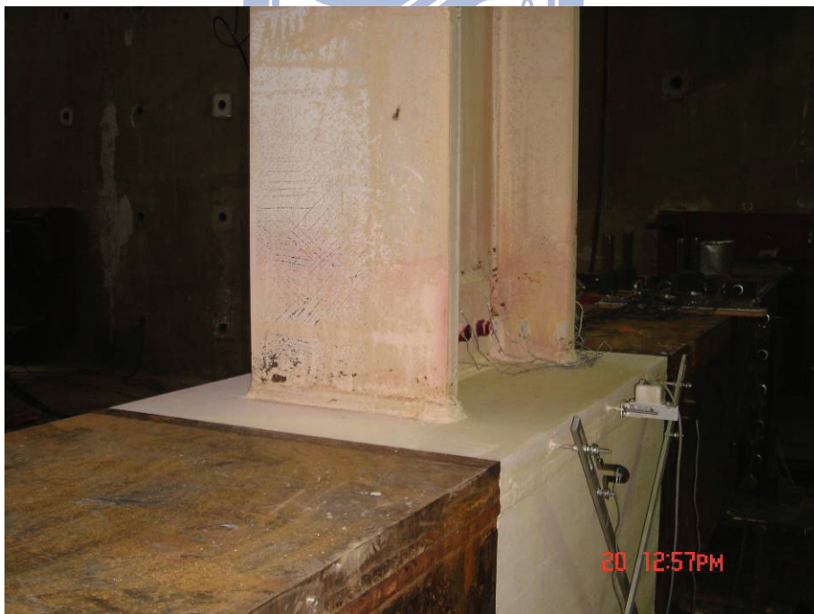
圖 4.27 試體 UN1 梁翼板呈現遠離柱面之區域性石灰脫落，並延伸 交叉至中心 (2% drift)
