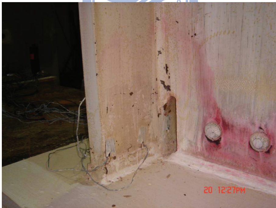
圖 4.25 試體 UN1 於扇形開孔根部處亦開始出現剝落 (1.5% drift)
