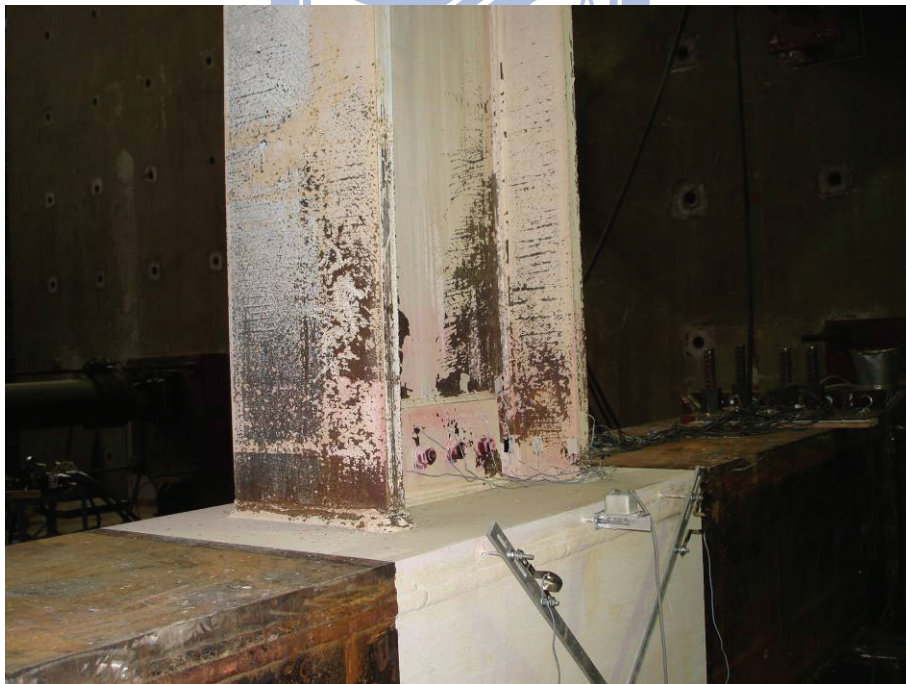
圖 4.35 試體 UN1 梁翼板及腹板都已呈現局部大量石灰脫落現象 (5% drift)
