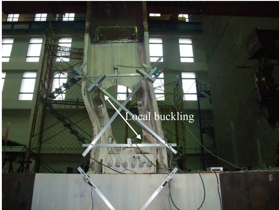
圖 4.69 試體 OP1 開孔區對角線上之角隅產生嚴重局部挫屈現象， 而開孔區段也出現明顯剪力變形 (7% drift)
