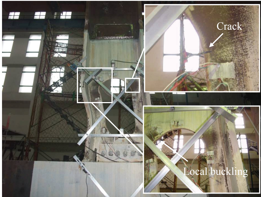
圖 4.65 試體 OP1 開孔角隅近上翼板處產生局部挫屈現象，而近下翼板處則產生一微小裂縫 (5% drift)
