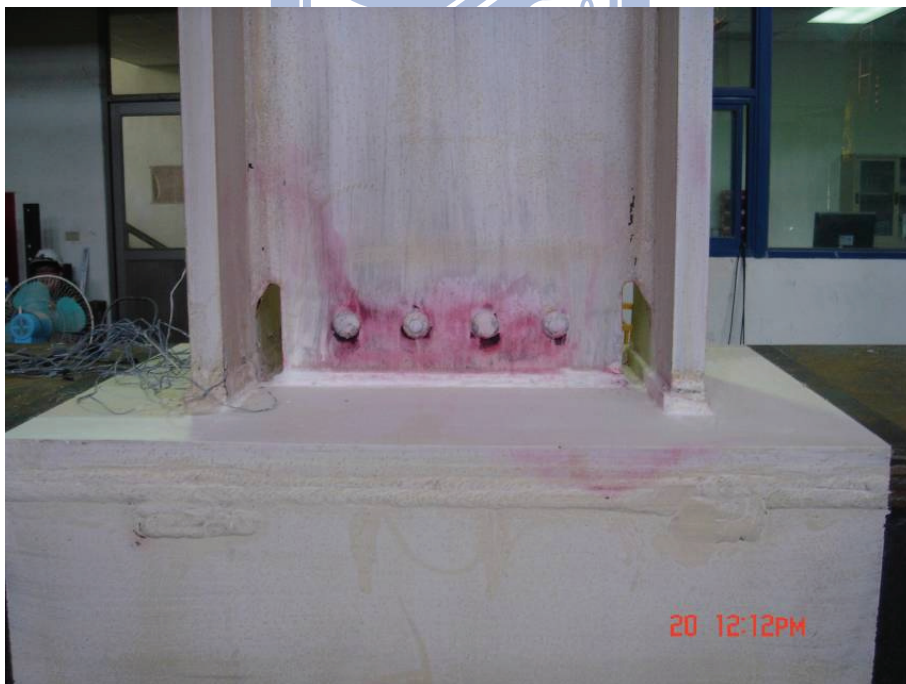
圖 4.23 試體 UN1 梁腹板兩側近翼板鉚接接合處發現兩處極少量石 灰脫落 (1% drift)
