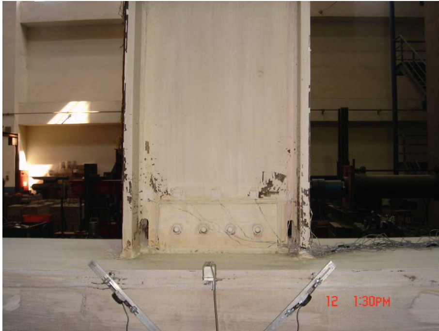
圖 4.44 試體 UN2 梁腹板在剪力板上緣兩側也出現石灰脫落的現象 (3% drift)
