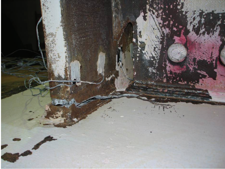
圖 4.36 試體 UN1 破壞模式 (試驗結束)
