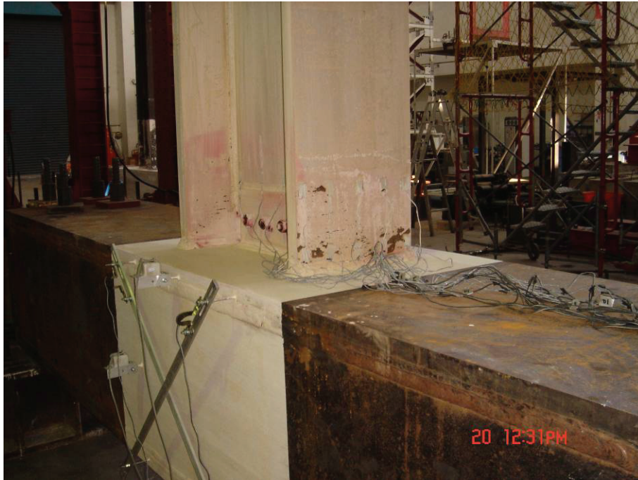
圖 4.26 試體 UN1 梁翼板之剝落向中心延伸，並遠離柱面向上發展， 扇形開孔附近之剝落也遠離柱面向上發展 (1.5% drift)
