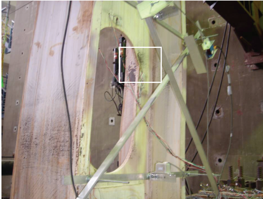
圖 4.61 試體 OP1 開孔角隅近上翼板處出現微量面外變 (4% drift)
