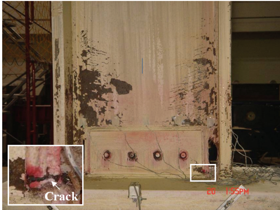
圖 4.32 試體 UN1 梁腹板兩側呈現大量石灰剝落現象並向上發展， 剪力板與柱面間之銲道產生一微小裂縫 (3% drift)
