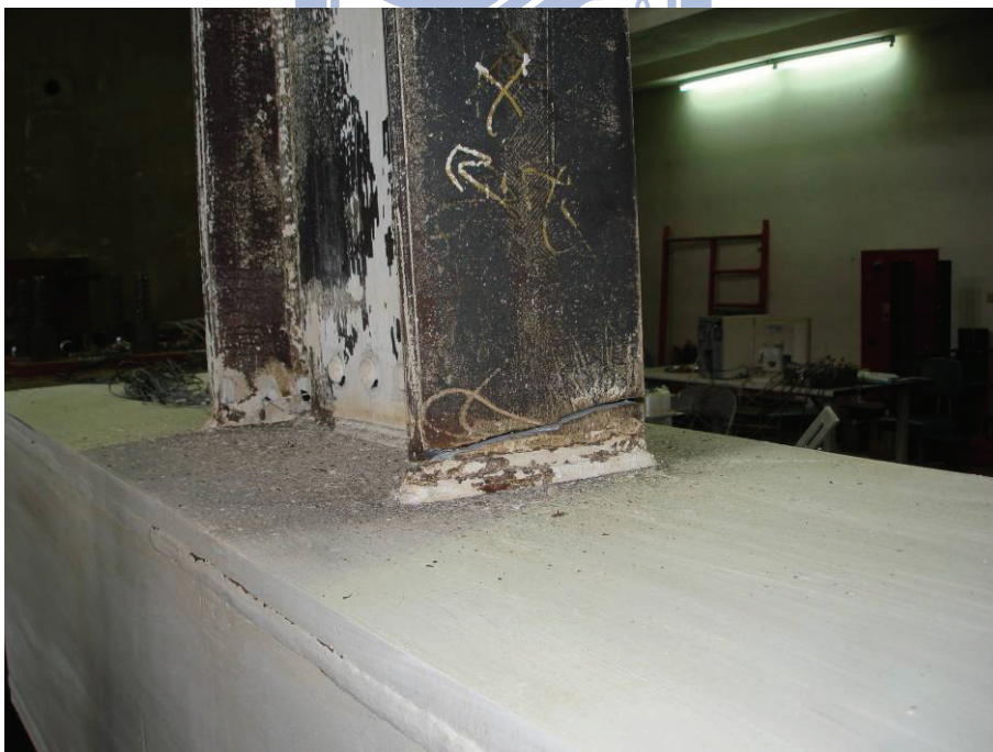
圖 4.49 試體 UN2 破壞模式 (試驗結束)
