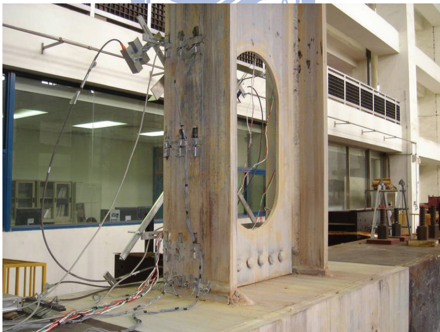
圖 4.76 試體 OP2 下翼板出現 45 度方向之石灰剝落，上翼板內側 近開孔角隅處也出現平行柱面之石灰剝落紋路 (1.5% drift)
