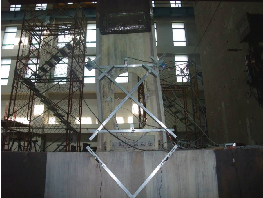
圖 4.81 試體 OP2 於開孔區段已出現剪力變形 (4% drift)
