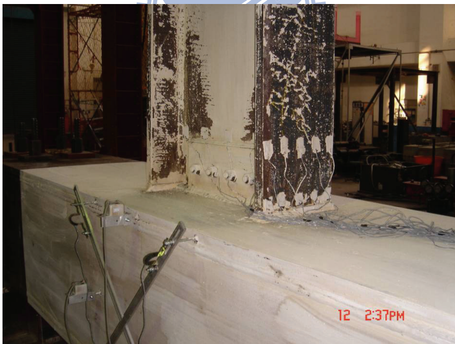
圖 4.45 試體 UN2 梁翼板、腹板及扇形開孔處已呈現大量石灰剝落 現象 (4% drift)
