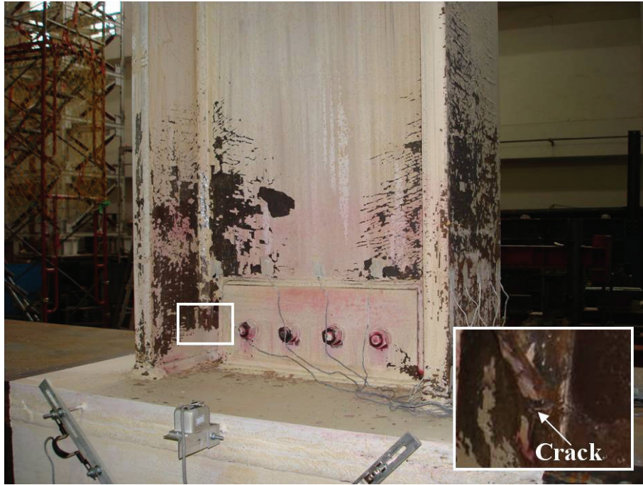
圖 4.34 試體 UN1 上翼板扇形開孔根部產生了小裂縫 (4% drift)
