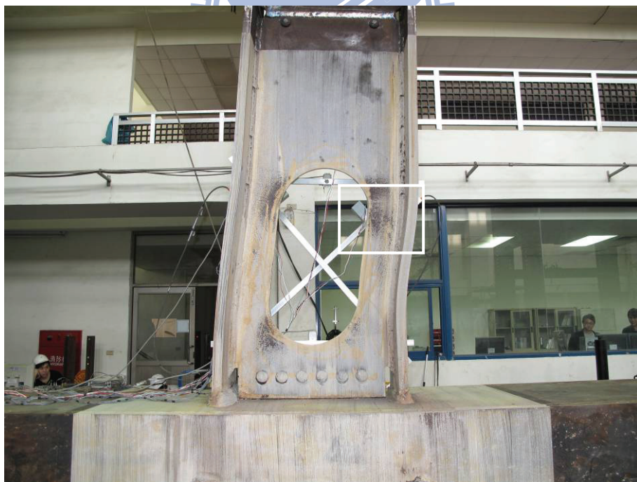
圖 4.84 試體 OP2 於開孔末端近上翼板角隅處出現微量面外變形 (5% drift)
