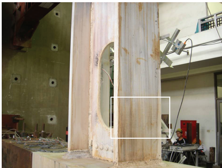
圖 4.55 試體 OP1 於上翼板接近開孔起始圓弧段末端處出現平行柱面之石灰剝落紋路 (1.5% drift)
