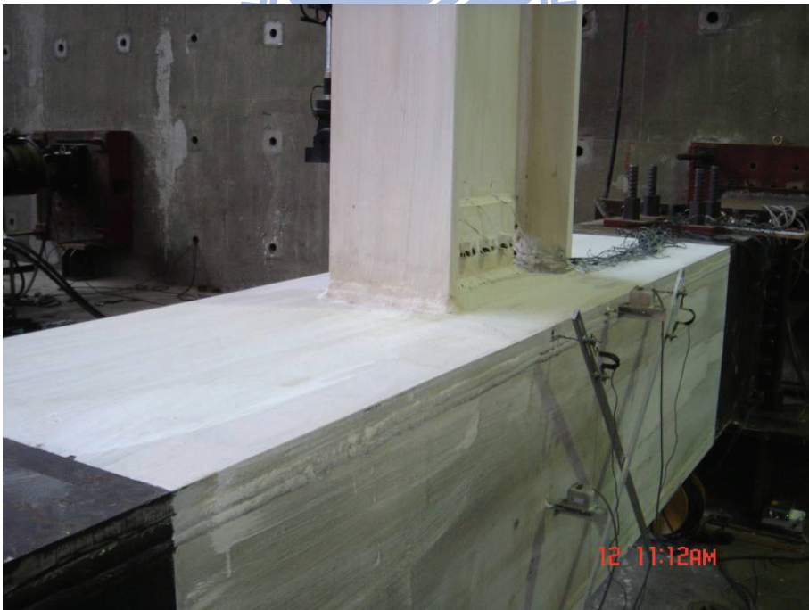
圖 4.37 試體 UN2 表面未發現明顯變化 (0.75% drift)
