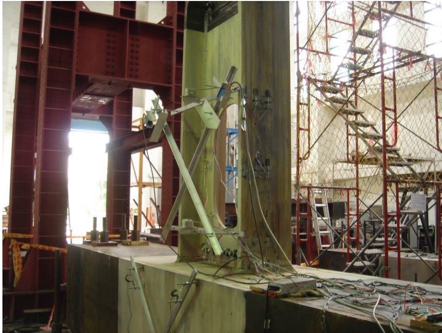
圖 4.71 試體 OP2 表面未發現明顯變化 (0.5% drift)
