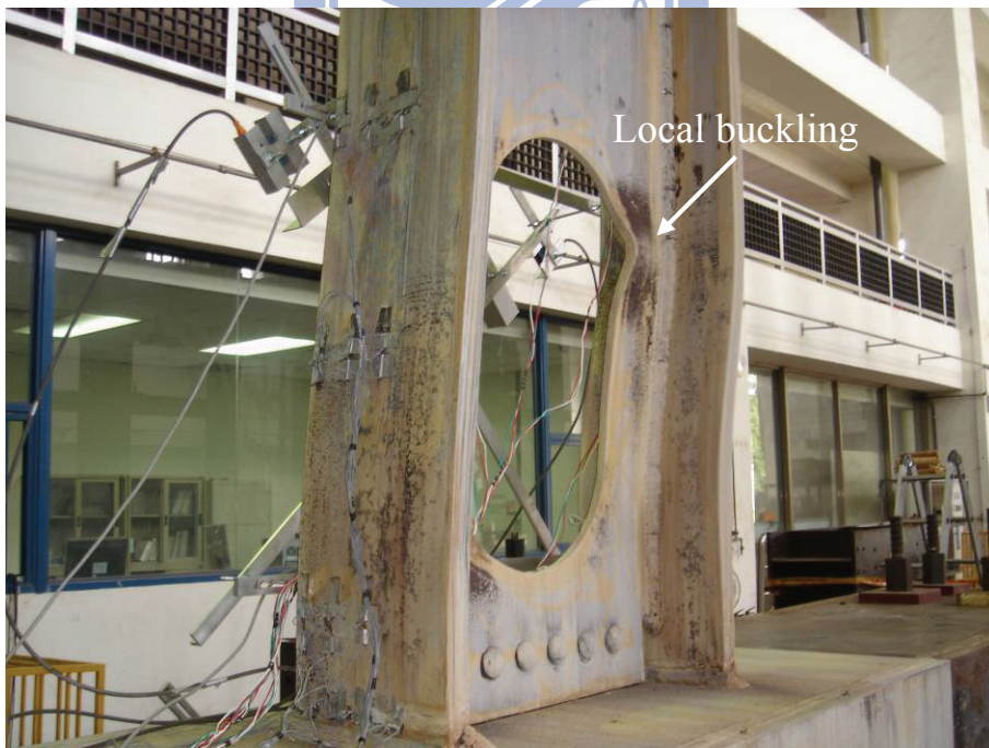
圖 4.86 試體 OP2 於開孔區末端之角隅出現明顯之面外挫屈 (6% drift)
