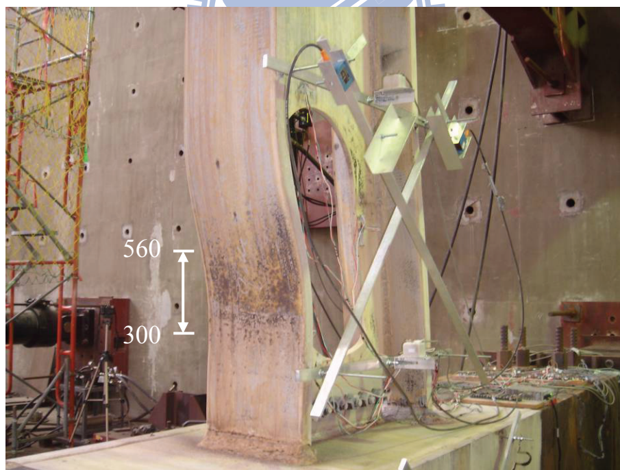
圖 4.88 試體 OP2 於上翼板產生一明顯塑鉸機制，其生成位置約離 柱面 300 mm~560 mm 之間（試驗結束）
