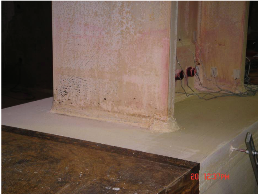
圖 4.24 試體 UN1 梁上翼板開始出現平行於梁寬方向之石灰剝落紋路，並開始有交叉至中心的跡象 (1.5% drift)
