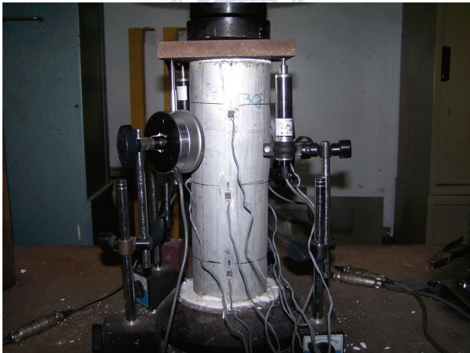
照片 4.18 試體 C-d102t3-CH 試驗結束後之破壞情形
