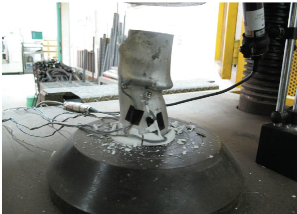
照片 4.5 試體 C-d45t3-CN 試驗結束後之破壞情形
