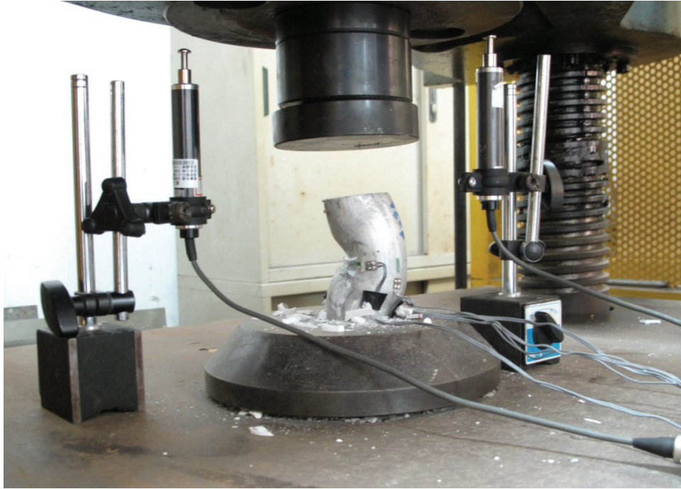
照片 4.3 試體 C-d41t6-CN 試驗結束後之破壞情形
