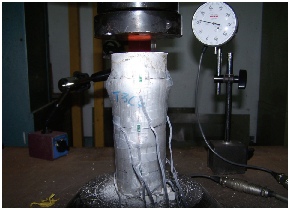
照片 4.11 試體 C-d63t3-CN 試驗結束後之破壞情形
