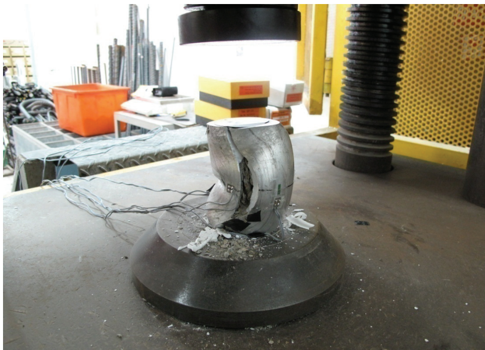
照片 4.9 試體 C-d55t6-CN 試驗結束後之破壞情形
