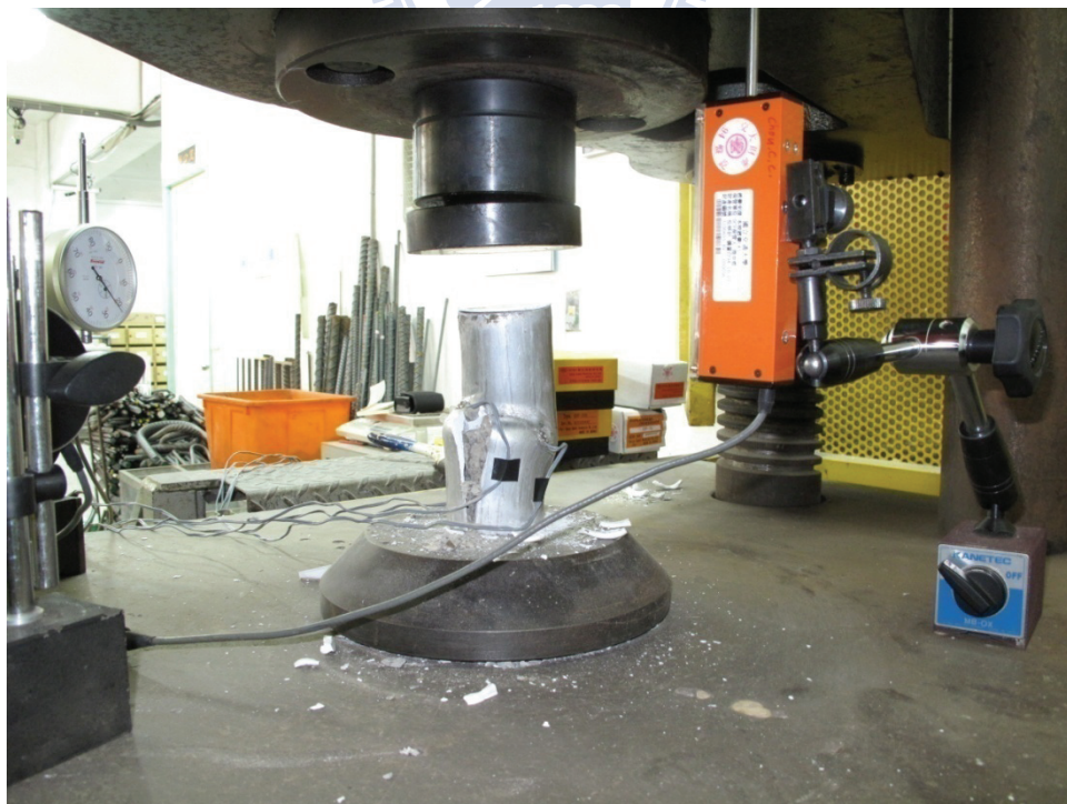
照片 4.10 試體 C-d55t6-CH 試驗結束後之破壞情形
