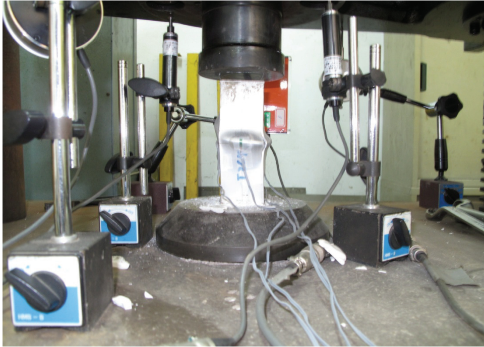
照片 4.27 試體 S-d51t2-CN 試驗結束後之破壞情形
