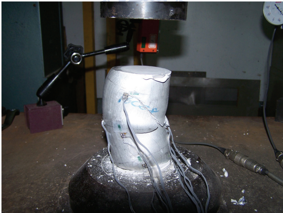
照片 4.14 試體 C-d63t6-CH 試驗結束後之破壞情形
