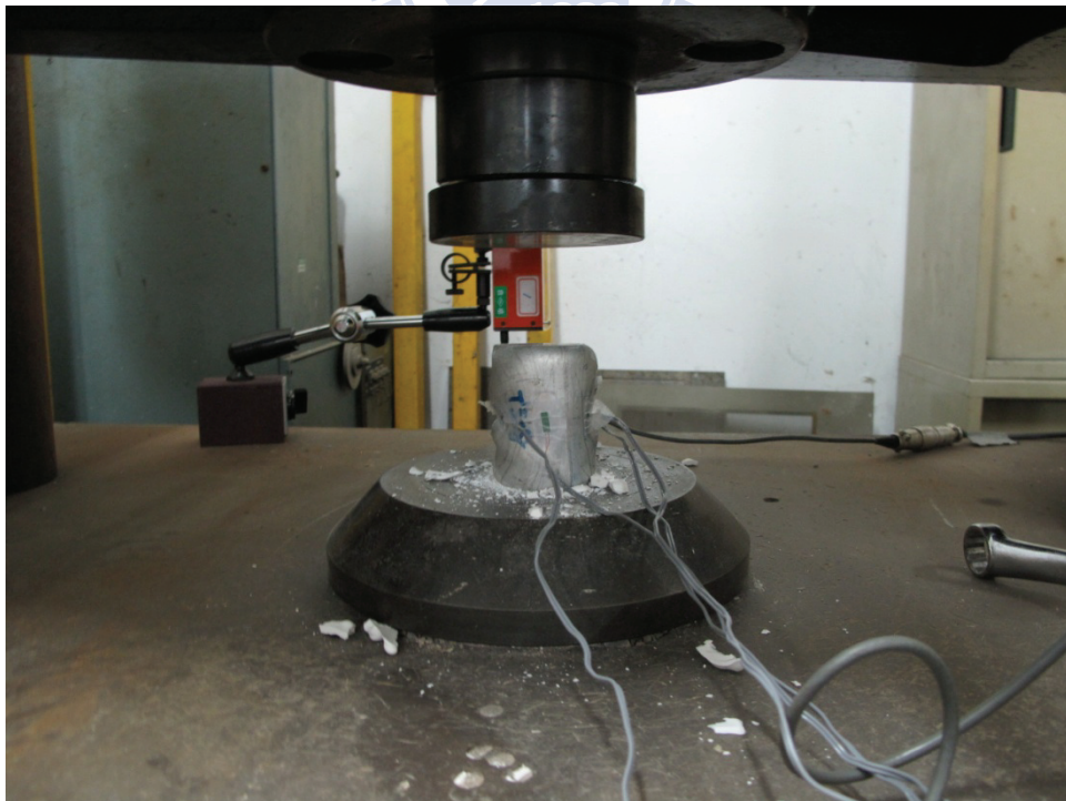
照片 4.2 試體 C-d38t3-CH 試驗結束後之破壞情形
