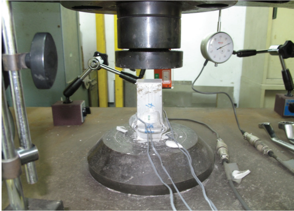
照片 4.25 試體 S-d38t3-CN 試驗結束後之破壞情形
