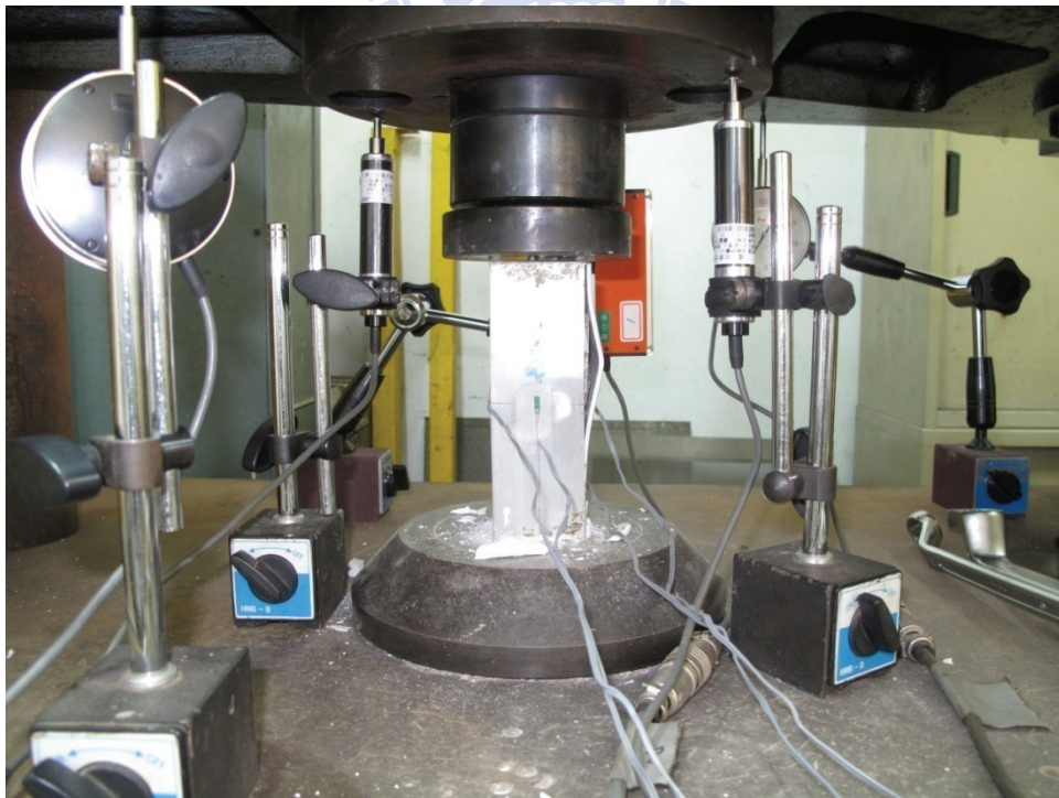
照片 4.28 試體 S-d51t2-CH 試驗結束後之破壞情形
