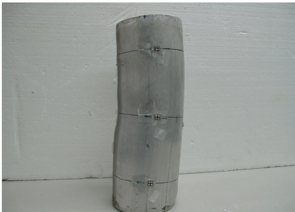
照片 4.19 試體 C-d102t6-CN 試驗結束後之破壞情形
