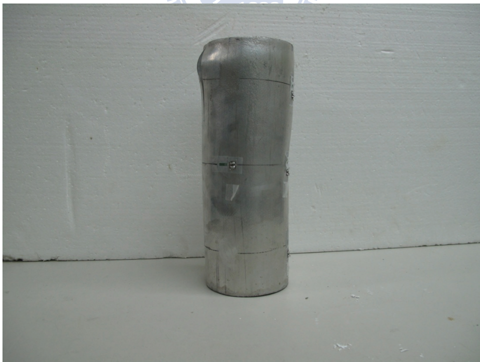
照片 4.22 試體 C-d102t12-CH 試驗結束後之破壞情形
