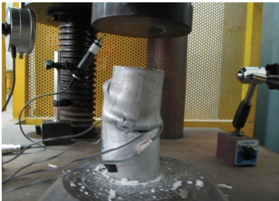
照片 4.7 試體 C-d51t3-CN 試驗結束後之破壞情形
