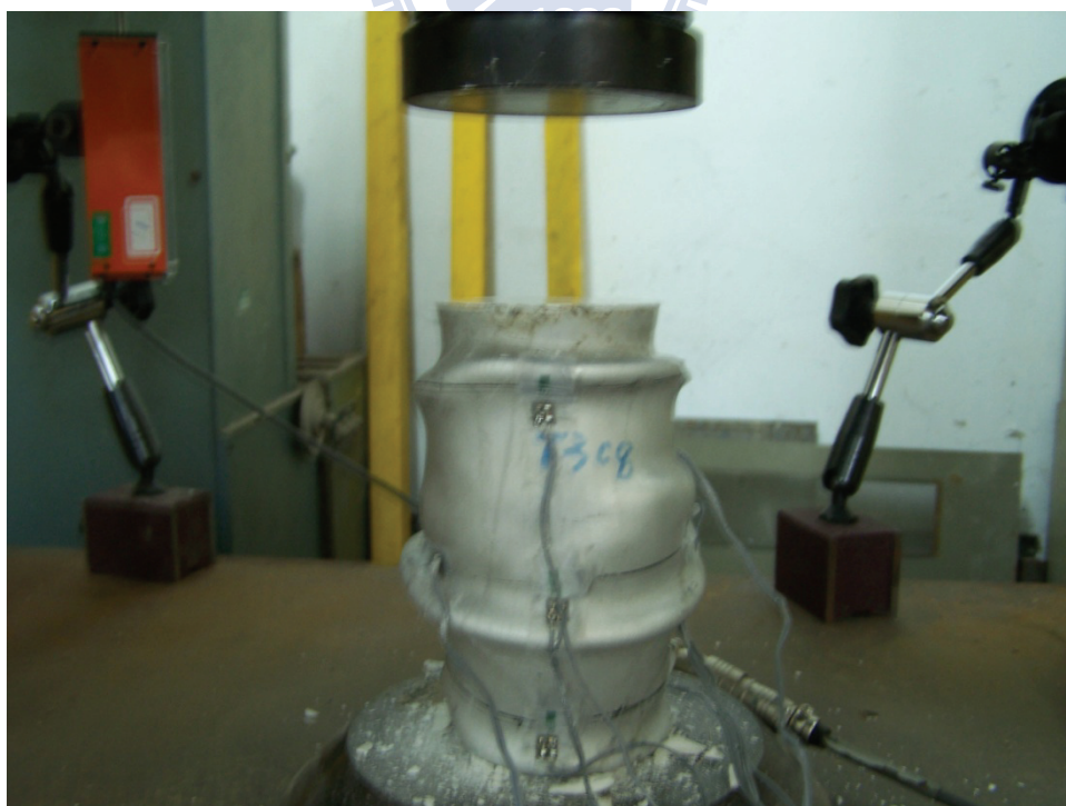
照片 4.16 試體 C-d76t3-CH 試驗結束後之破壞情形
