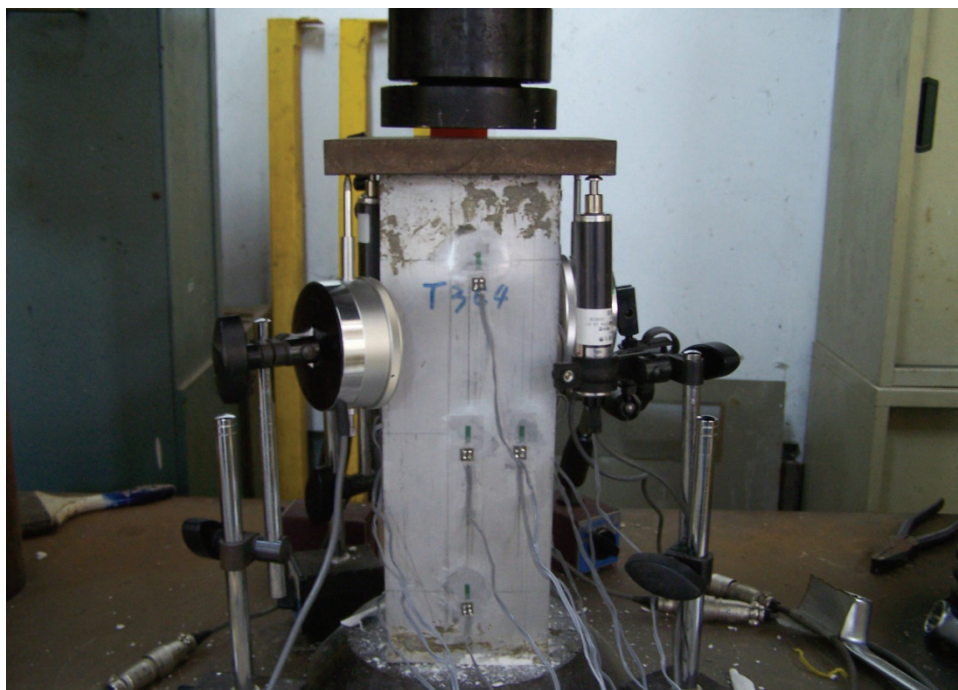
照片 4.33 試體 S-d102t3-CN 試驗結束後之破壞情形
