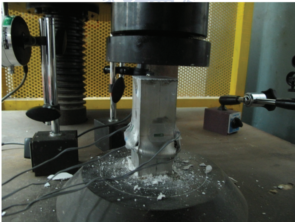
照片 4.24 試體 S-d38t2-CH 試驗結束後之破壞情形
