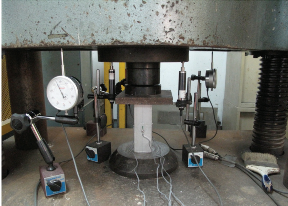
照片 3.3 空管試體配置情形
