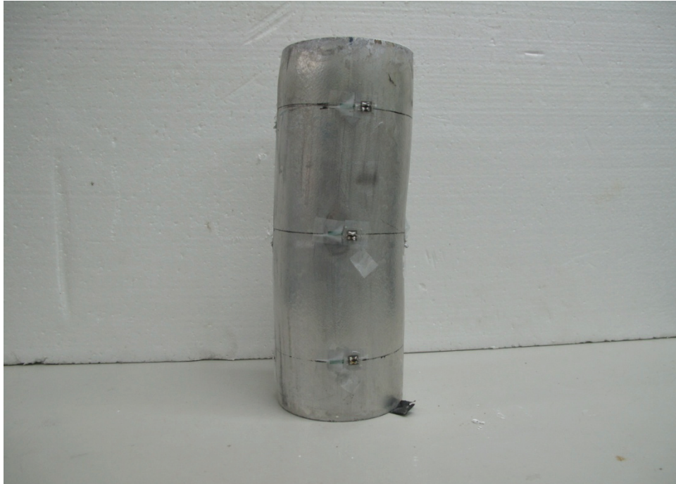
照片 4.21 試體 C-d102t12-CN 試驗結束後之破壞情形
