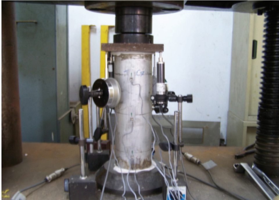
照片 3.5 試體配置於 100 kN 萬能試驗機
