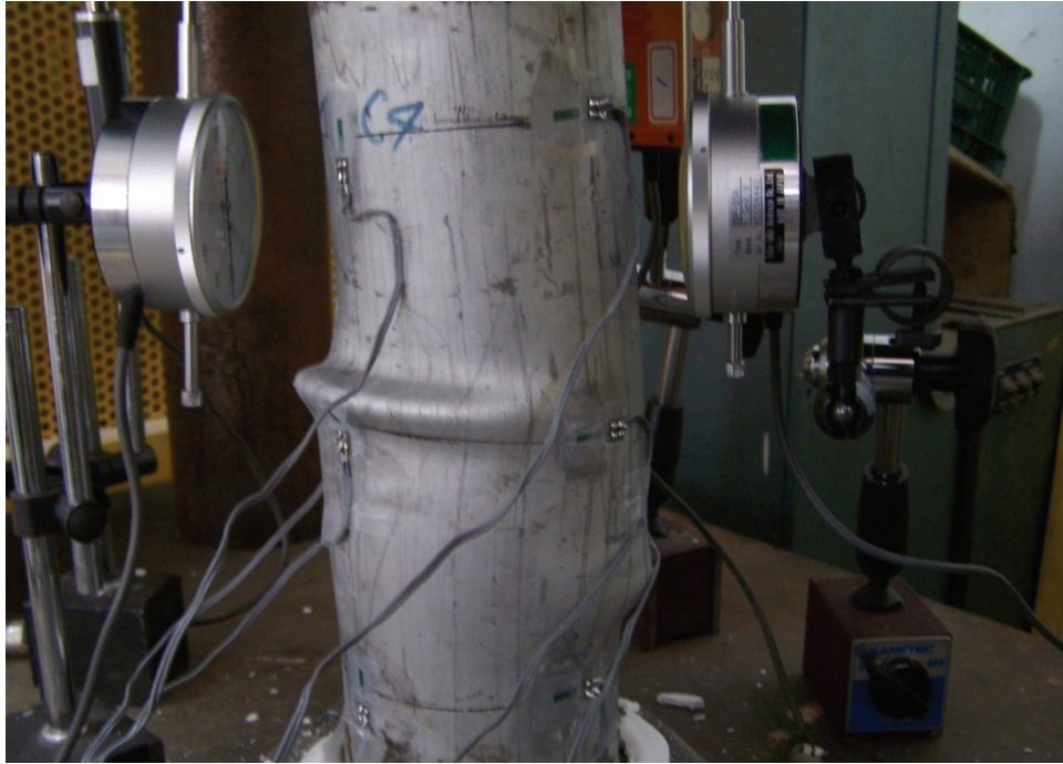
照片 4.17 試體 C-d102t3-CN 試驗結束後之破壞情形
