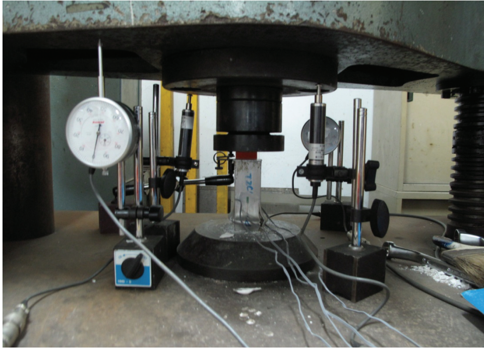
照片 4.23 試體 S-d38t2-CN 試驗結束後之破壞情形
