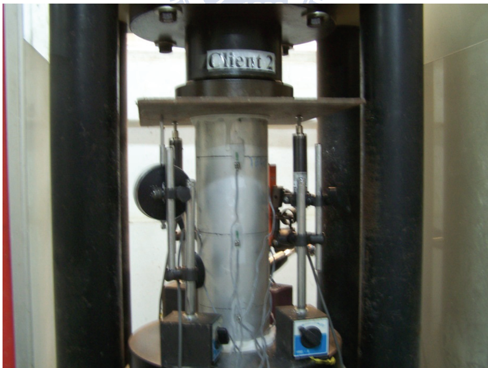
照片 3.6 試體配置於 200 kN 萬能試驗機
