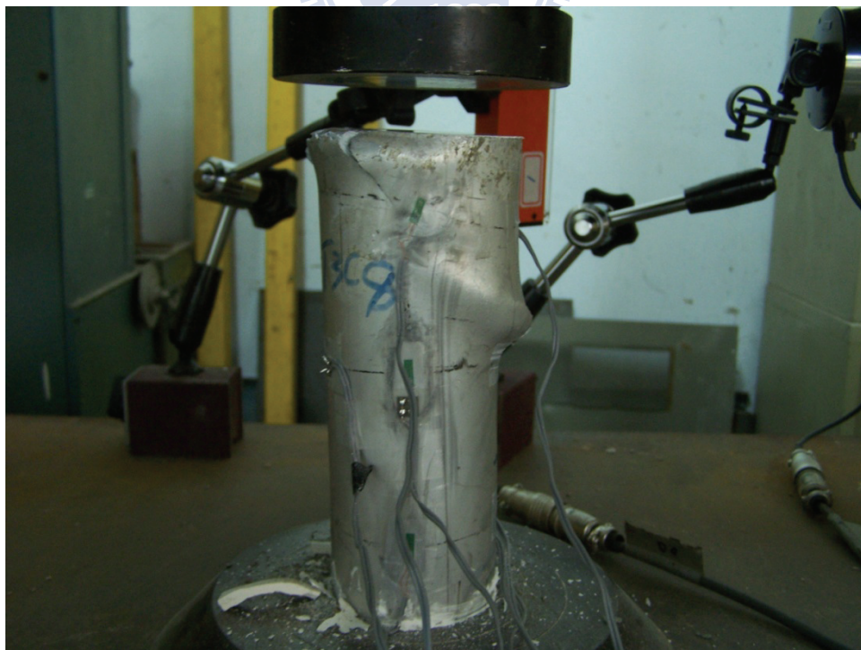
照片 4.12 試體 C-d63t3-CH 試驗結束後之破壞情形
