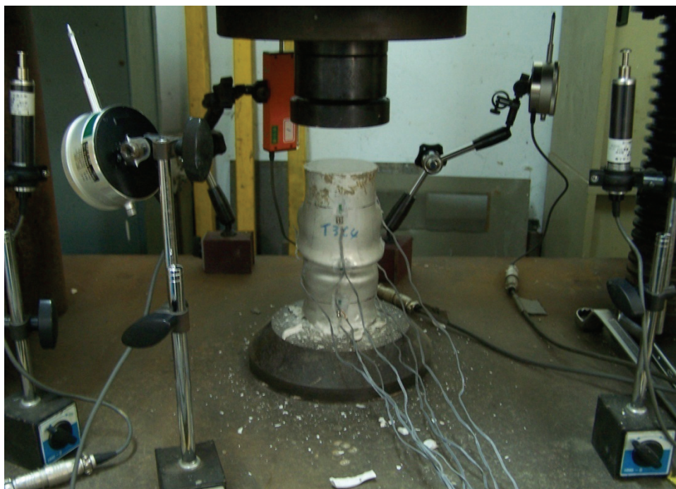
照片 4.15 試體 C-d76t3-CN 試驗結束後之破壞情形
