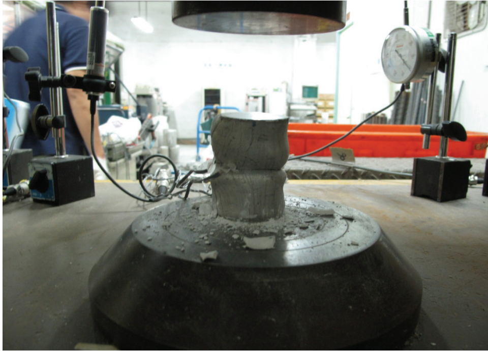
照片 4.1 試體 C-d38t3-CN 試驗結束後之破壞情形
