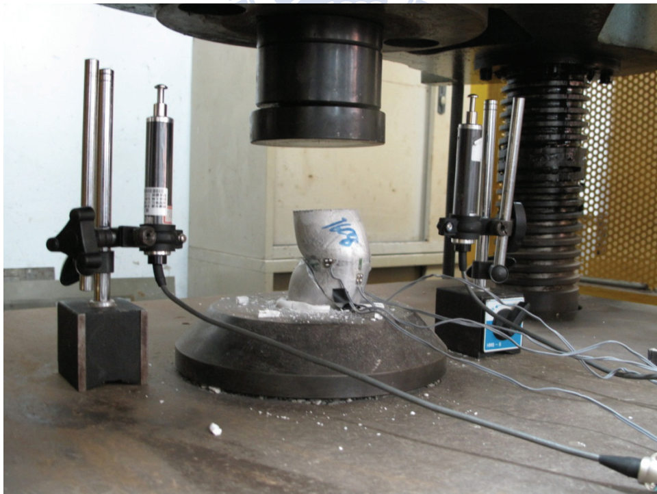
照片 4.4 試體 C-d41t6-CH 試驗結束後之破壞情形
