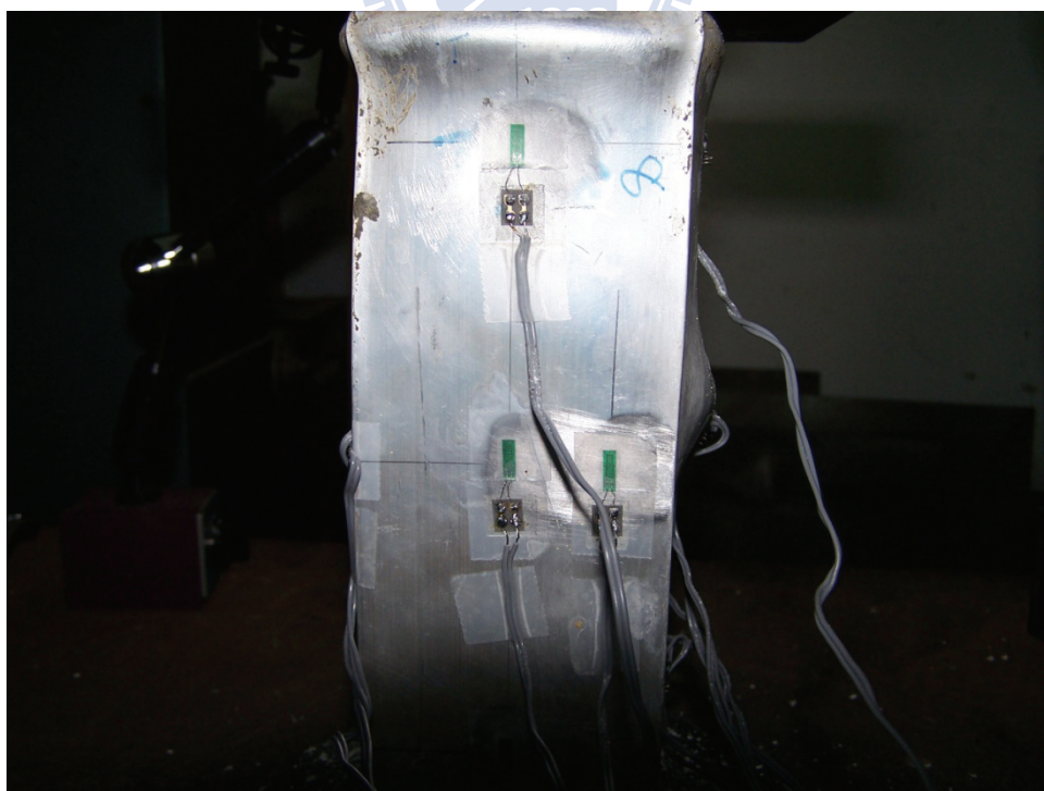
照片 4.32 試體 S-d76t3-CH 試驗結束後之破壞情形
