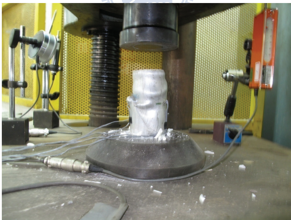
照片 4.8 試體 C-d51t3-CH 試驗結束後之破壞情形
