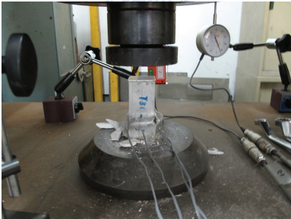
照片 4.26 試體 S-d38t3-CH 試驗結束後之破壞情形
