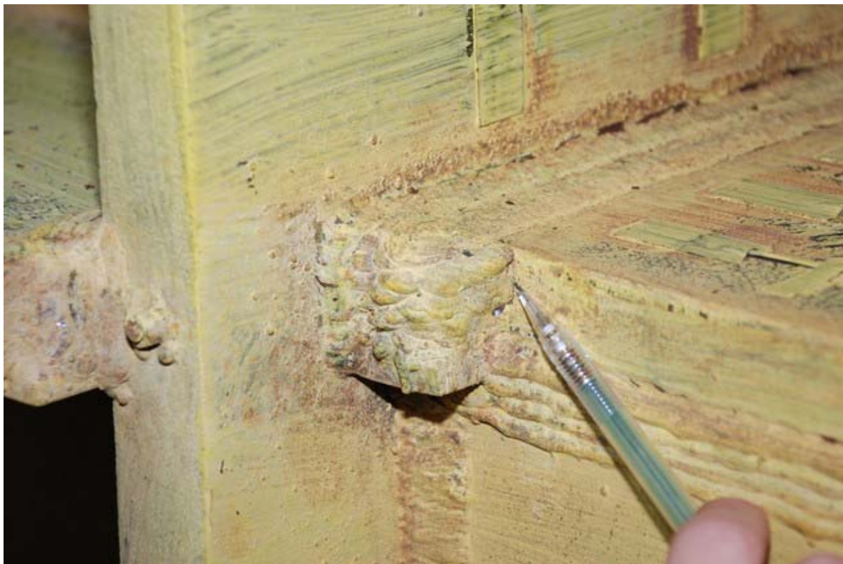
照片 3.109 試體 IFS3 梁翼和柱板接合之焊道出現小裂痕 ( \theta = -1\% 弧度)
