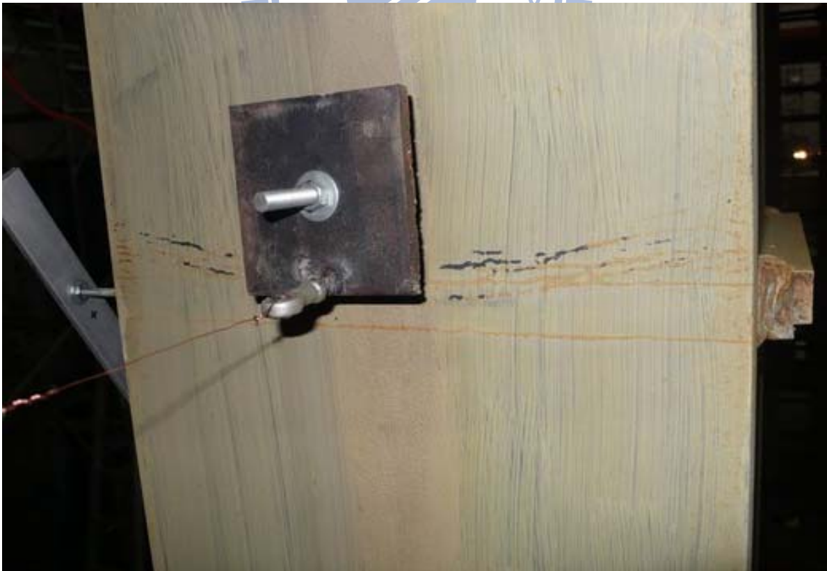
照片 3.58 試體 IFS2 背側之柱板於上下橫隔板高度處降伏( \theta = -0.5\% 弧度)
