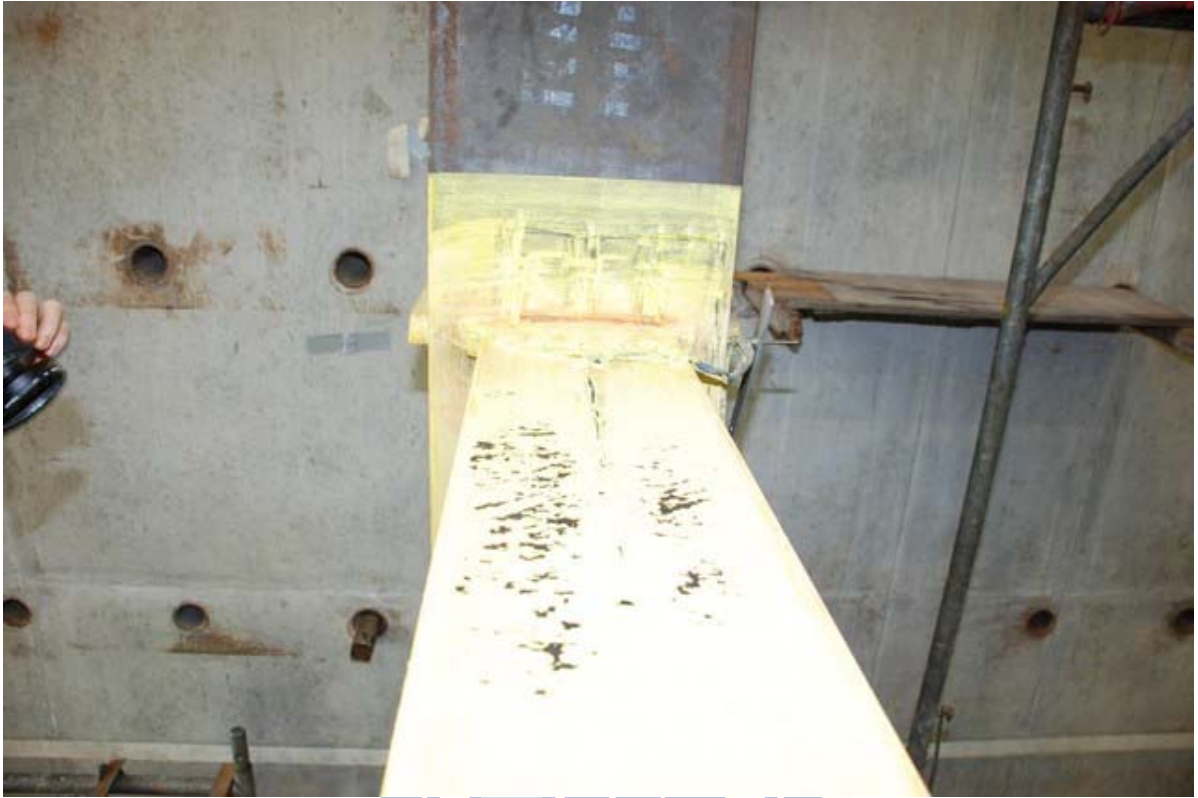
照片 3.39 試體 IFS1 梁上翼板降伏擴大 ( \theta = -3\% 弧度)
