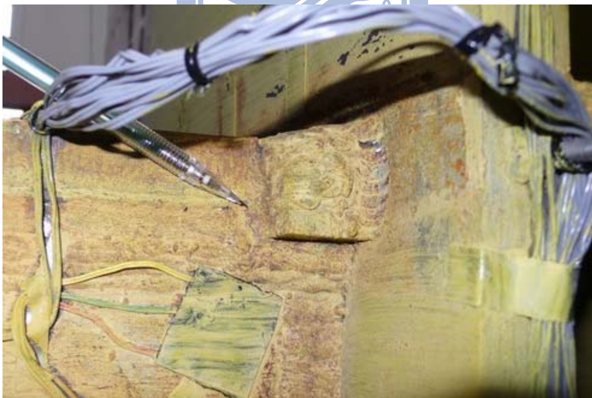
照片 3.110 試體 IFS3 梁翼和加勁板接合之焊道出現小裂痕 ( \theta = -1\% 弧度)
