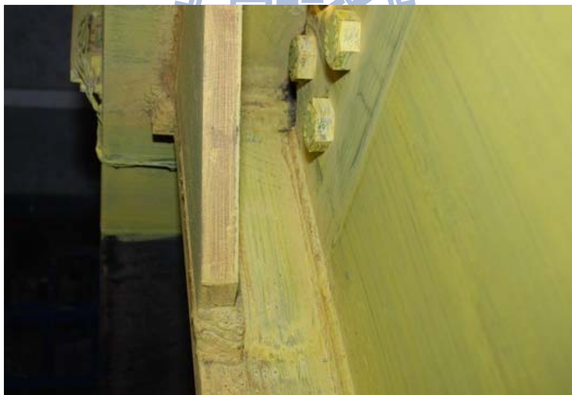
照片 3.88 試體 IFS3 梁下翼板內側降伏 ( \theta=0.375\% 弧度結束)
