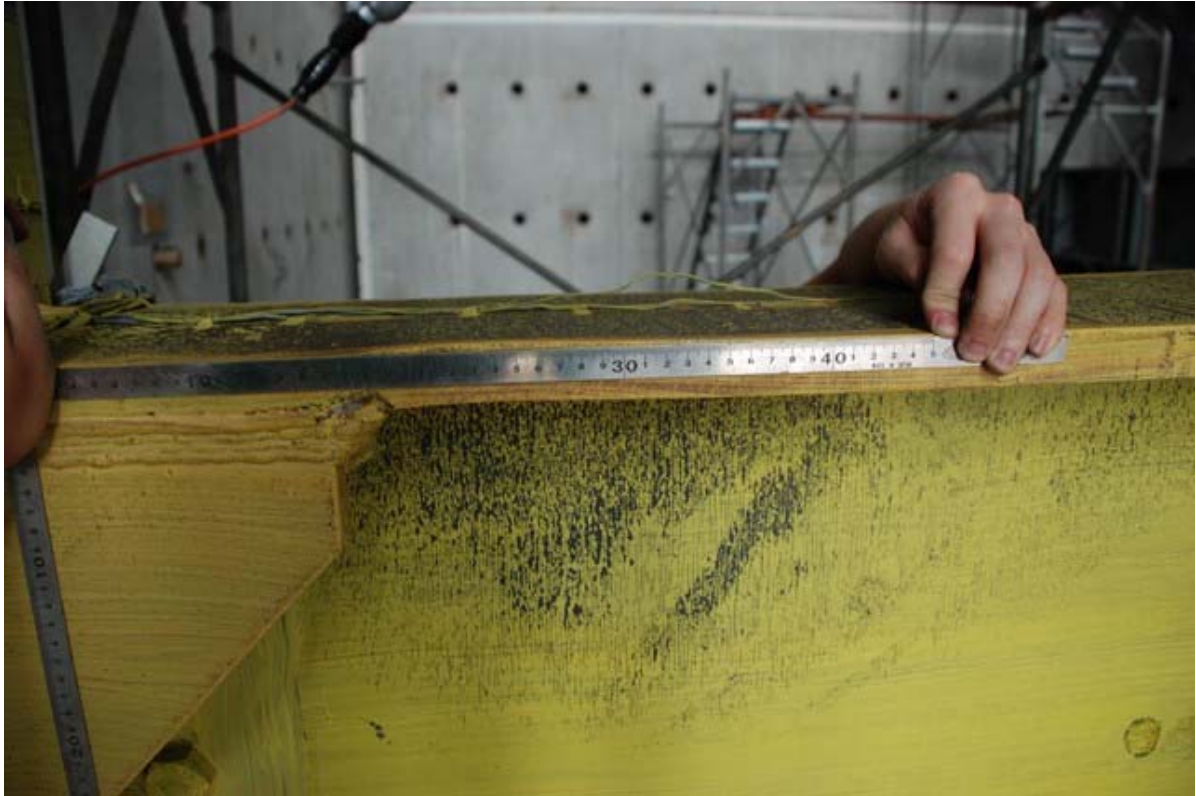
照片 3.119 試體 IFS3 梁上翼於加勁板端部產生 3mm 挫屈 ( \theta = +4\% 弧度)
