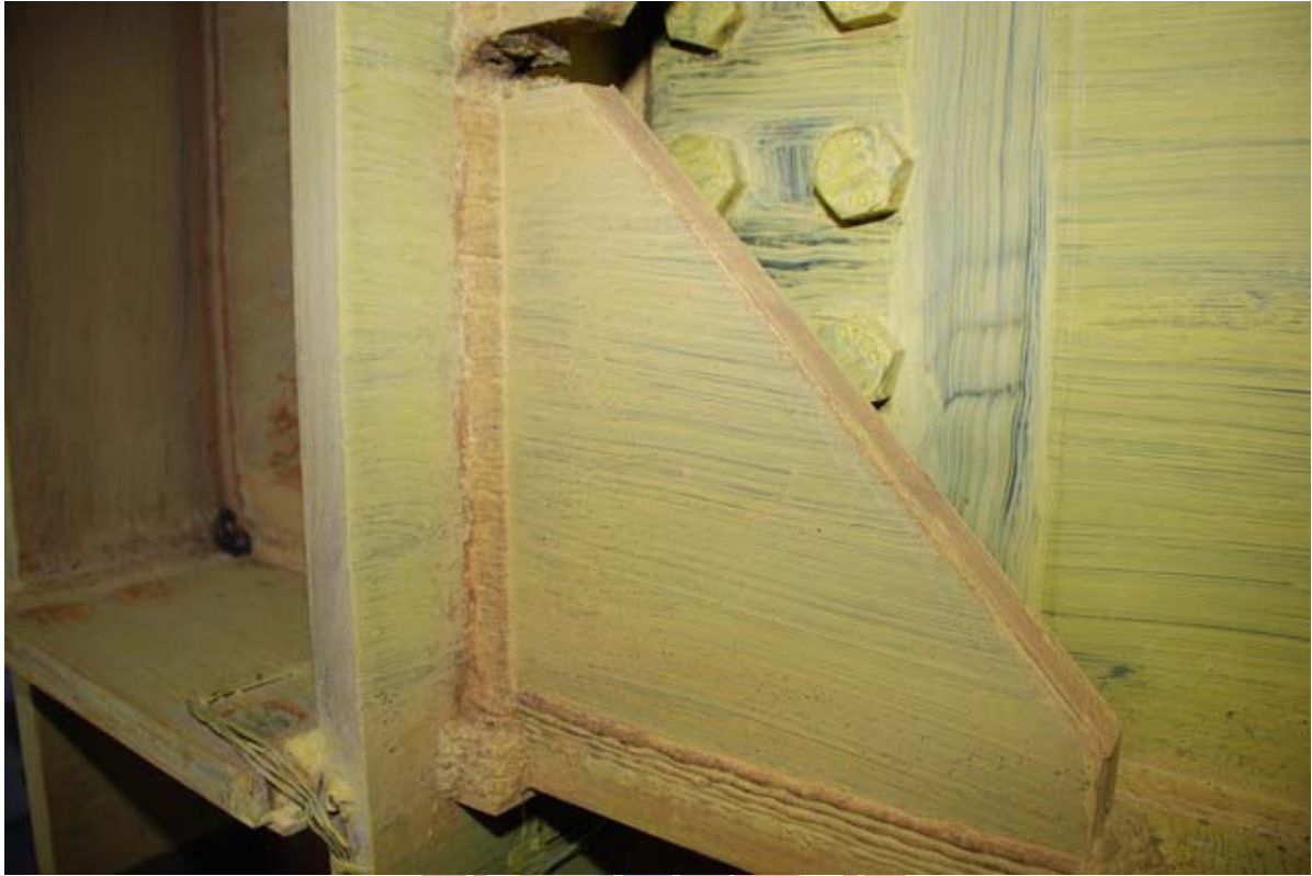
照片 3.91 試體 IFS3 加勁板出現輕微降伏 ( \theta=0.5\% 弧度結束)
