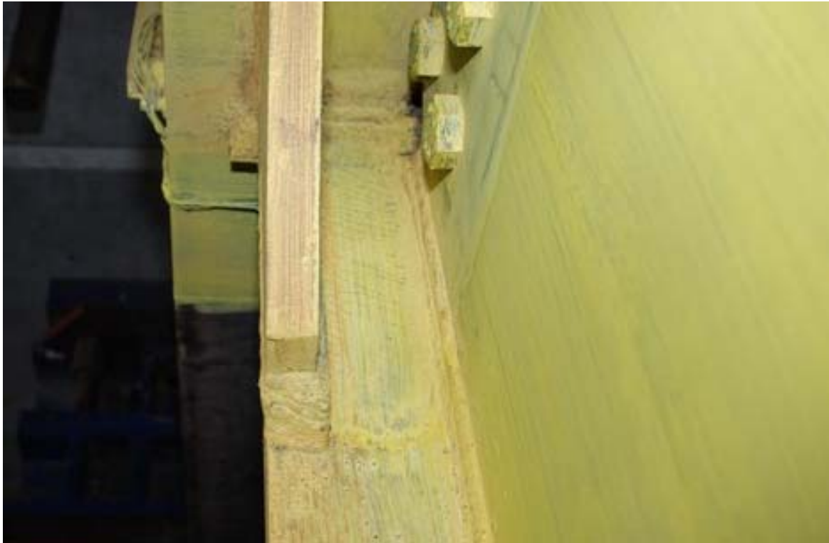
照片 3.89 試體 IFS3 梁下翼板內側降伏範圍增加 ( \theta=0.5\% 弧度結束)
