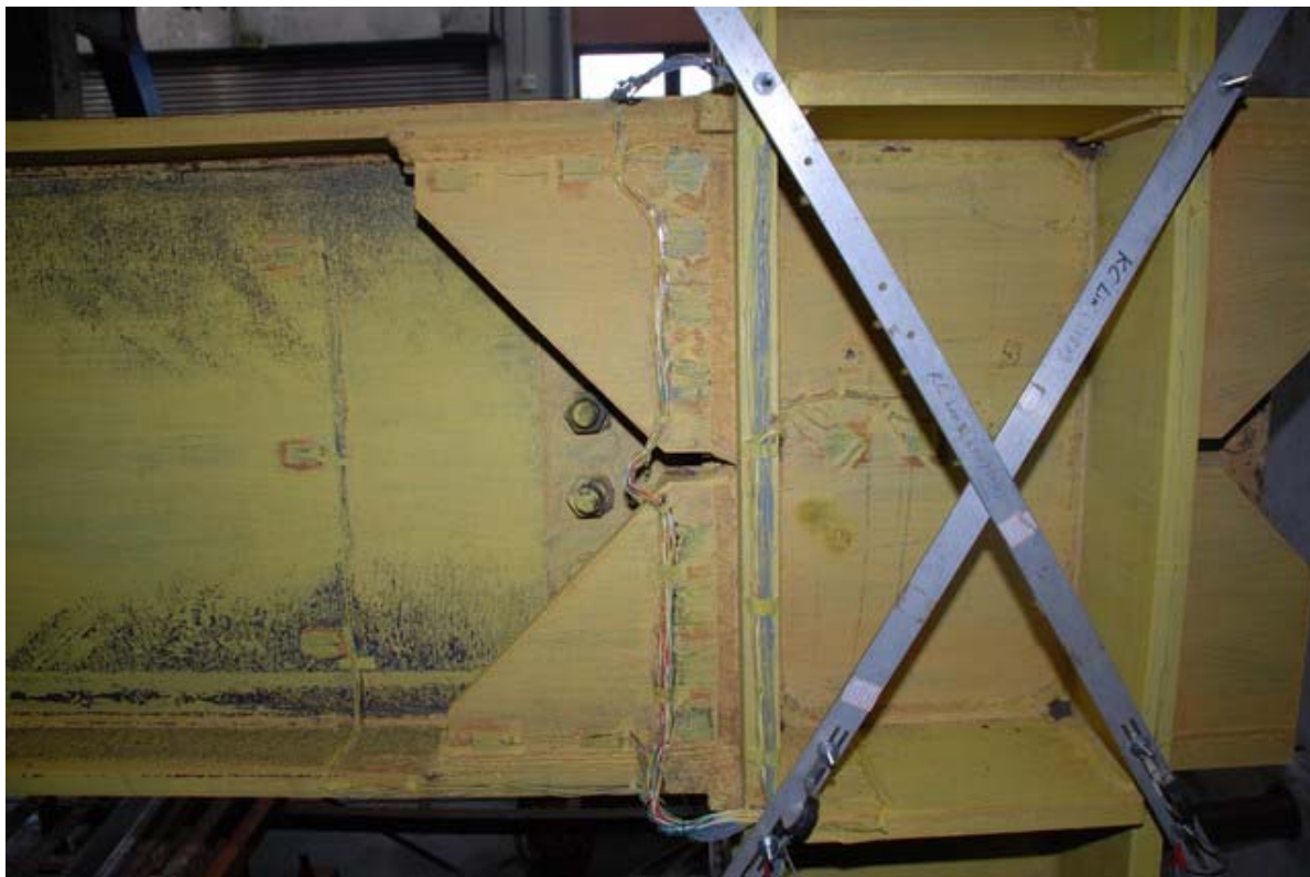
照片 3.105 試體 IFS3 交會區疊合板降伏情形 ( \theta=4\% 弧度結束)
