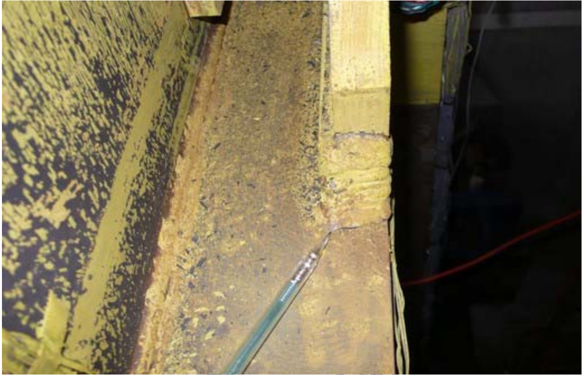
照片 3.121 試體 IFS3 加勁板焊道端部裂痕達30mm ( \theta = +4\% 弧度)
