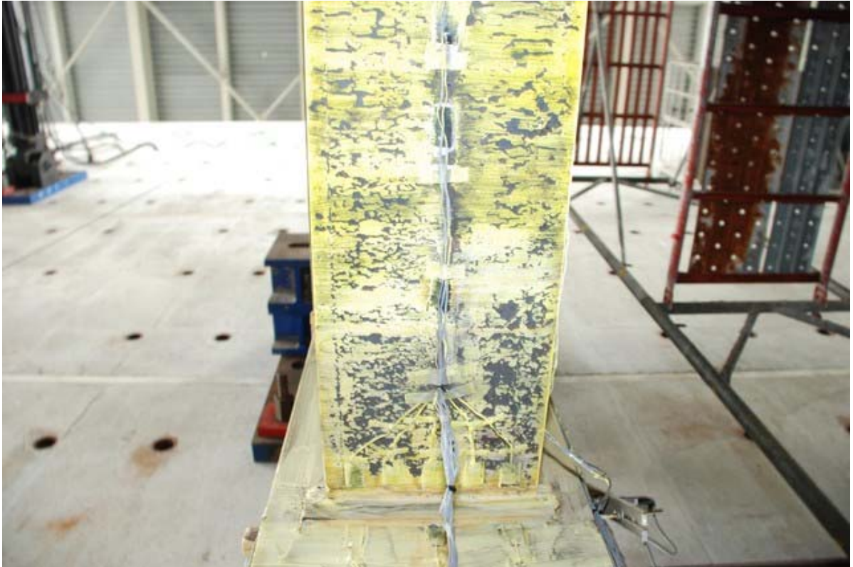
照片 3.13 試體 UR 梁下翼板降伏情形 ( \theta = +2\% 弧度)
