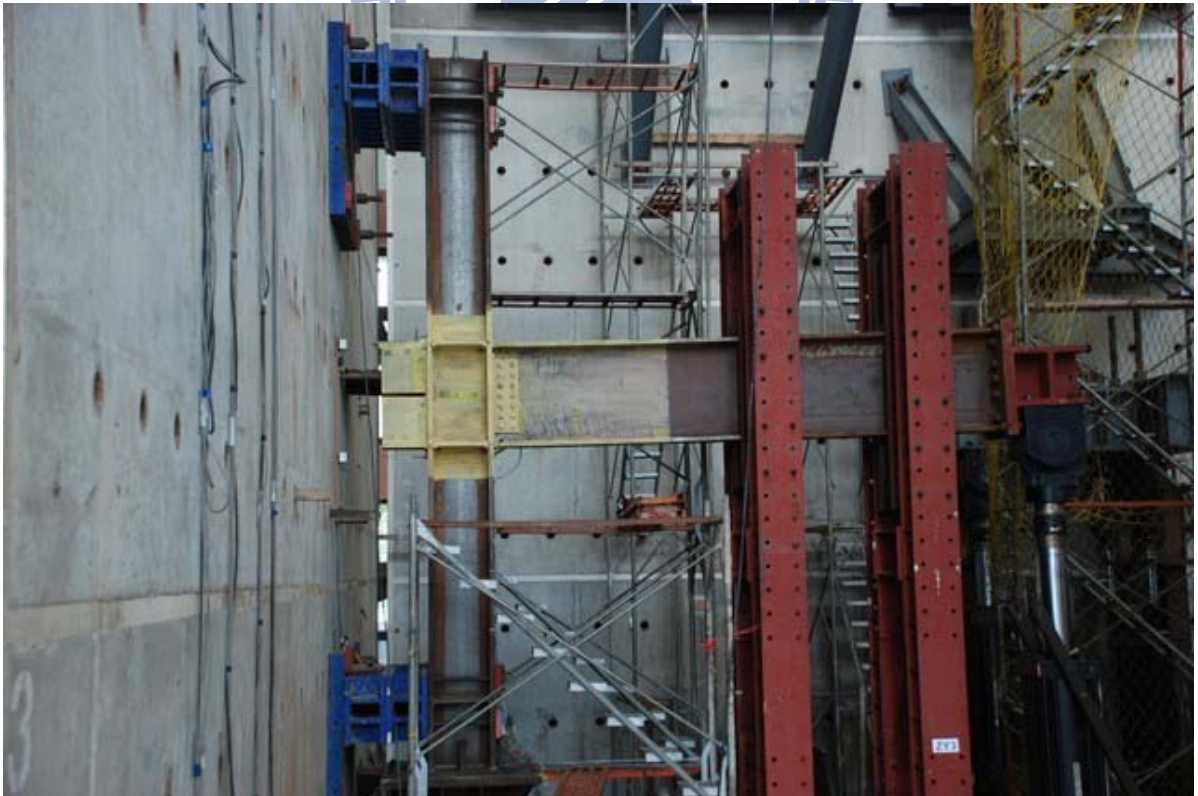
照片 3.18 試體 UR 尚未發生任何挫屈情形 ( \theta = +3\% 弧度)
