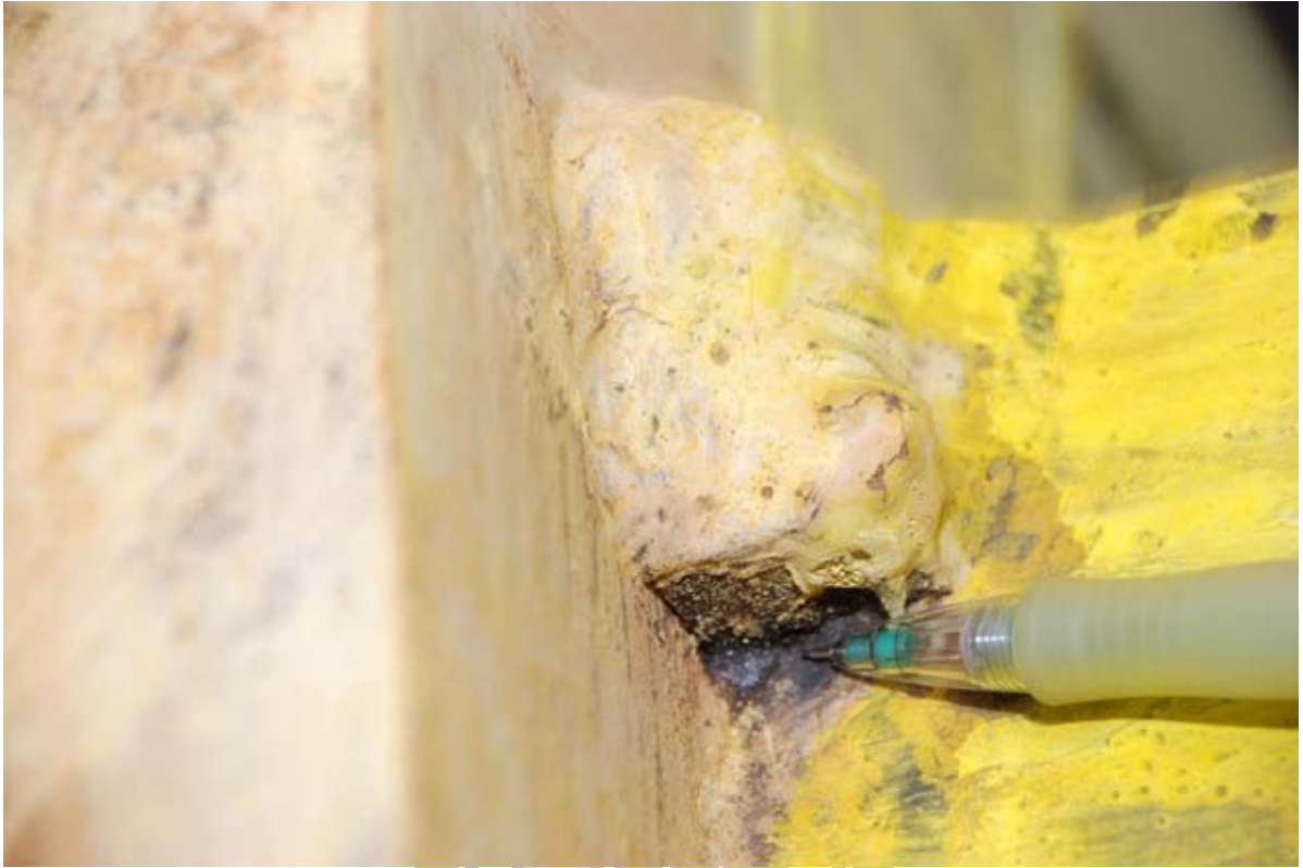
照片 3.49 試體 IFS1 上翼板焊道處開裂約10mm ( \theta=2\% 弧度結束)
