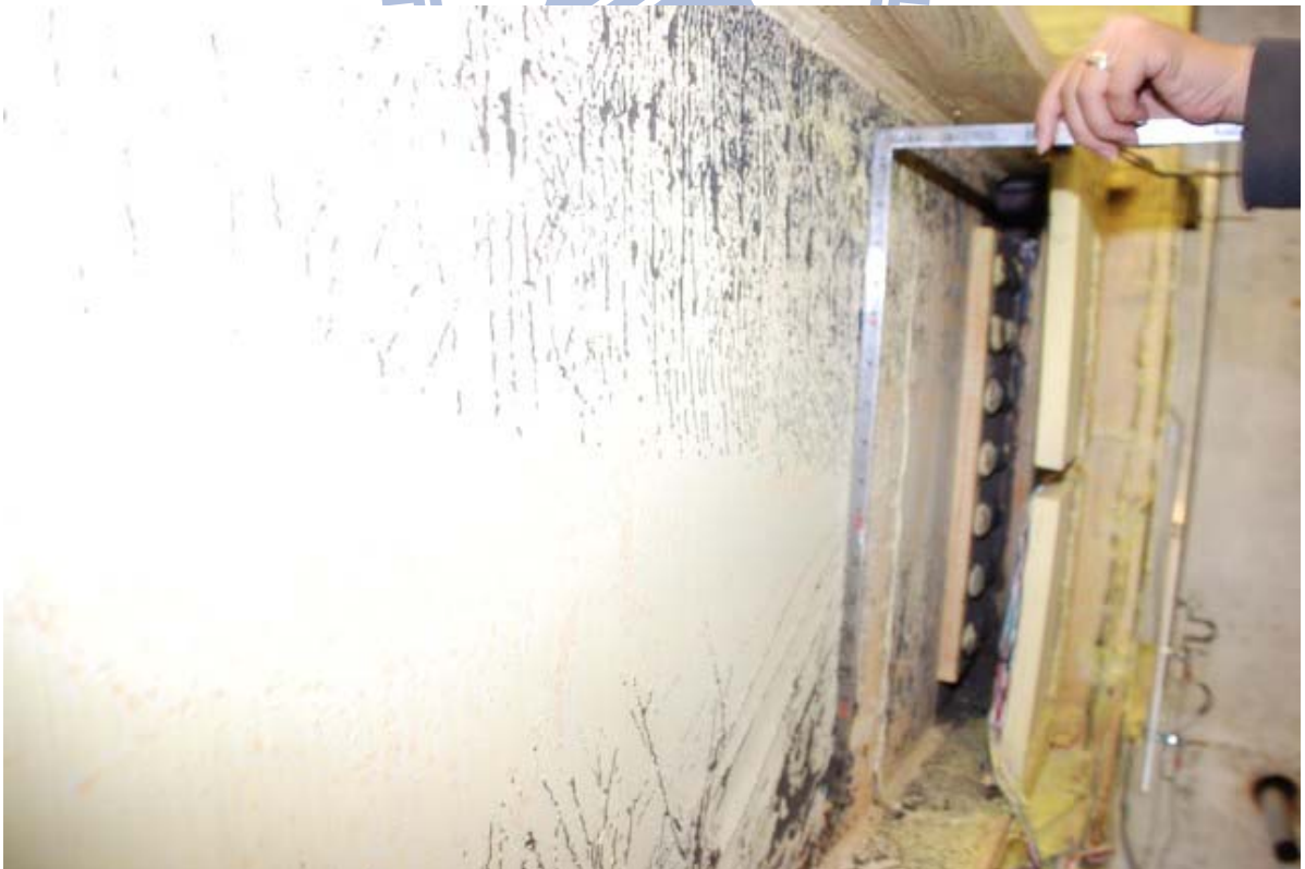
照片 3.44 試體 IFS1 梁腹板產生輕微挫屈 ( \theta = +4\% 弧度)
