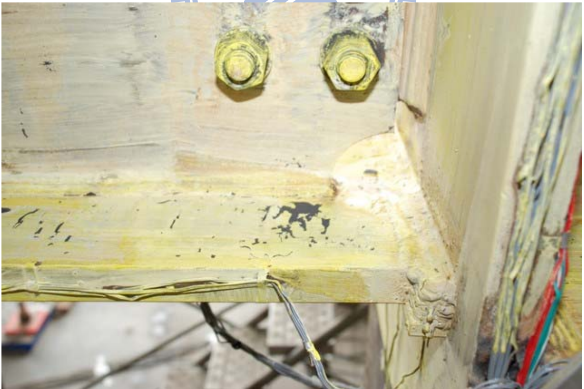
照片 3.8 試體 UR 梁腹板於扇形開口處降伏 ( \theta = +1\% 弧度)
