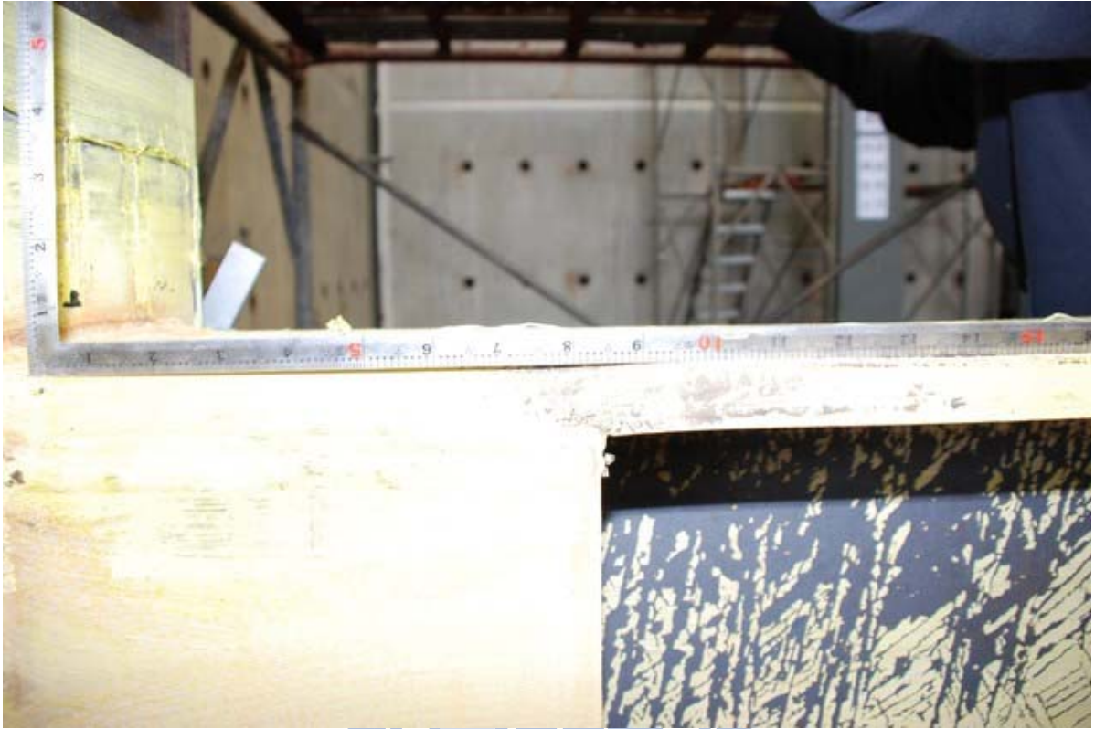
照片 3.45 試體 IFS1 梁上翼板產生輕微挫屈 ( \theta=4\% 弧度結束時)
