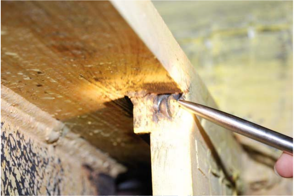
照片 3.43 試體 IFS1 右側加勁板端部與上翼母材產生裂縫 ( \theta = +4\% 弧度)
