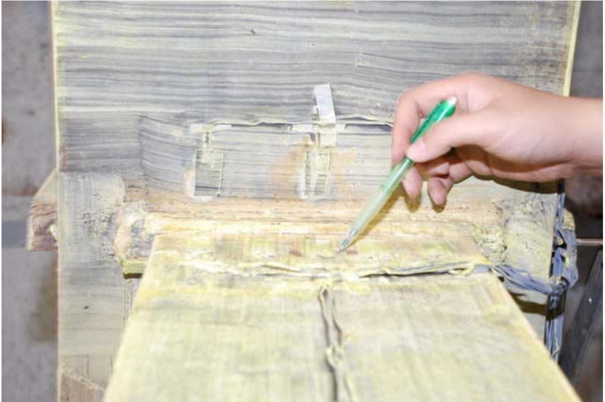
照片 3.21 試體 UR 梁上翼板於扇形開口處產生凹陷( \theta = -4\% 弧度第一圈)
