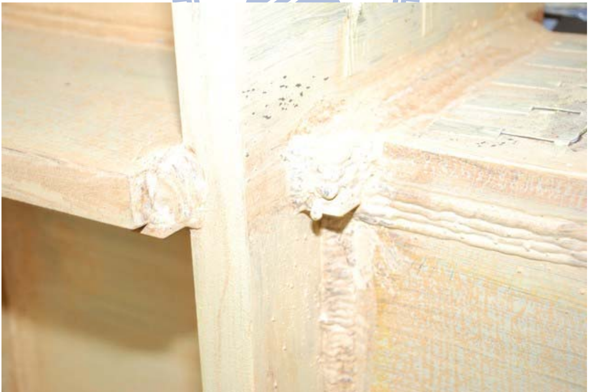
照片 3.66 試體 IFS2 上翼板焊道附近之柱板出現降伏 ( \theta = +3\% 弧度)
