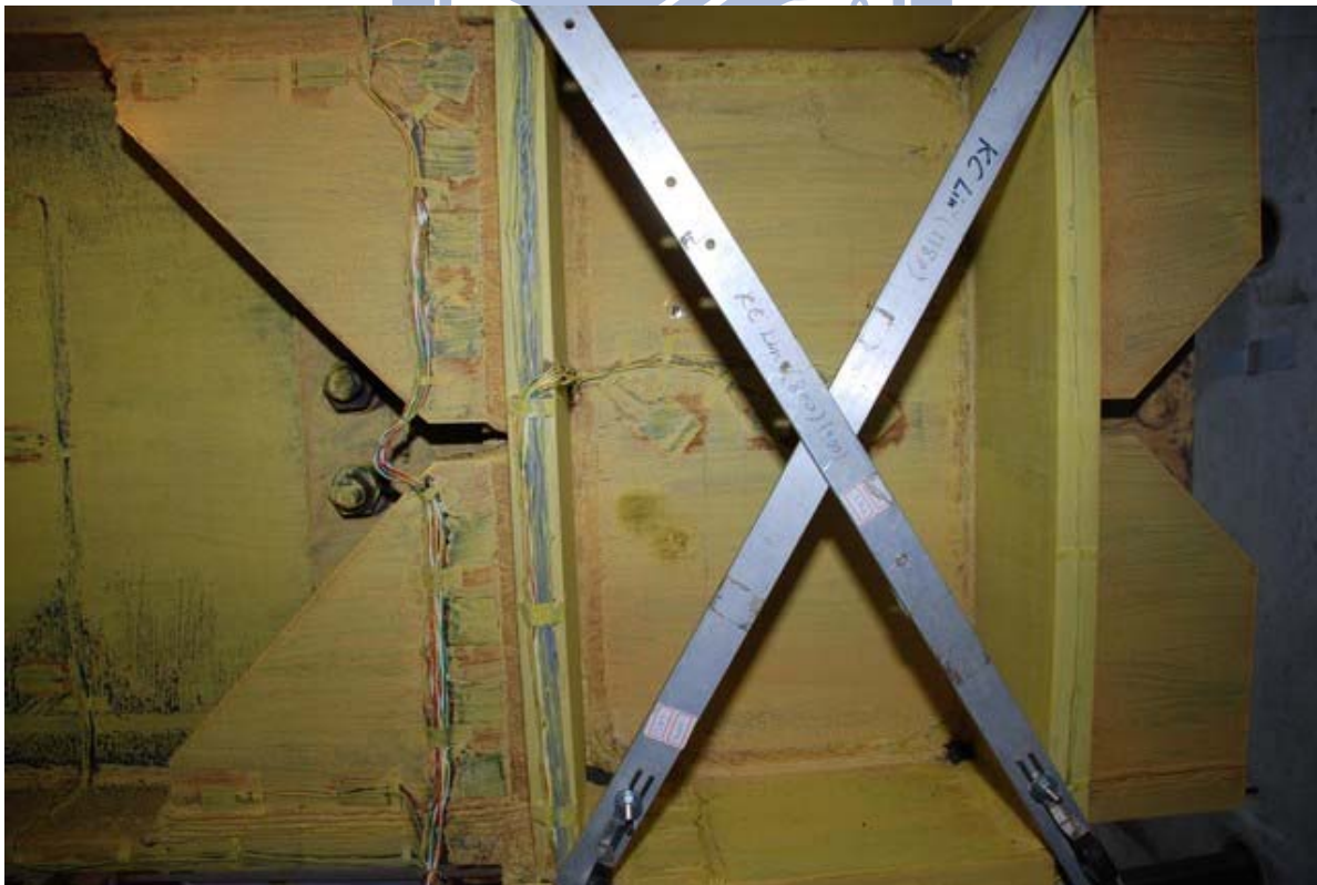
照片 3.100 試體 IFS3 交會區疊合板出現輕微降伏 ( \theta = +3\% 弧度)
