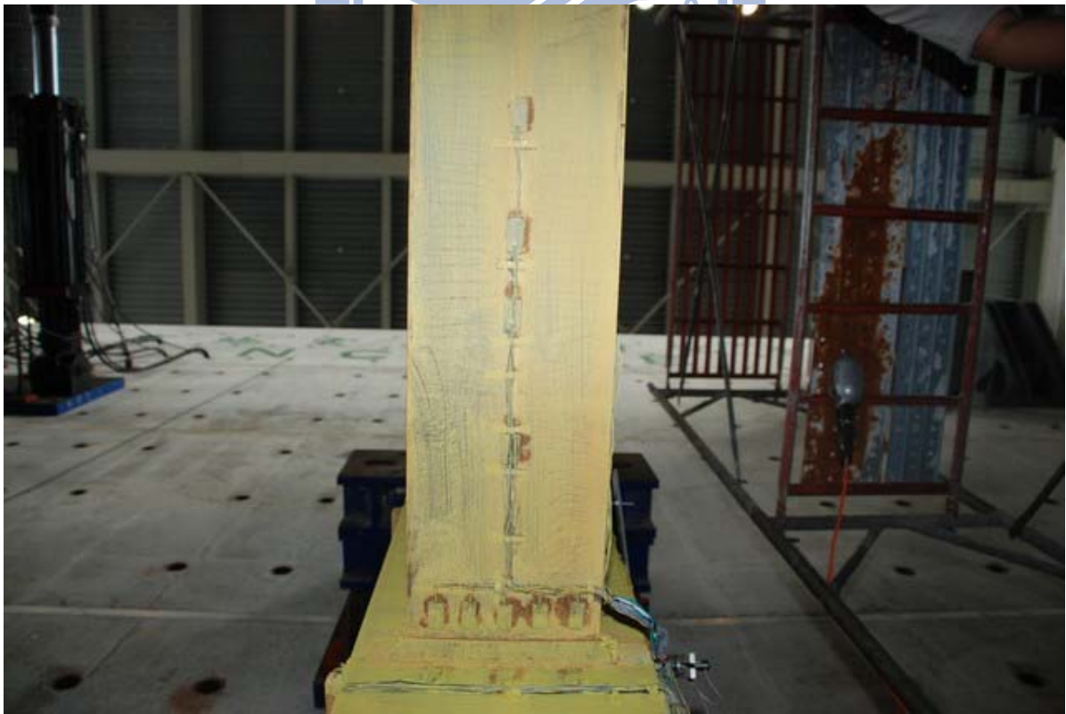
照片 3.94 試體 IFS3 梁下翼板降伏範圍增加 ( \theta = -2\% 弧度)
