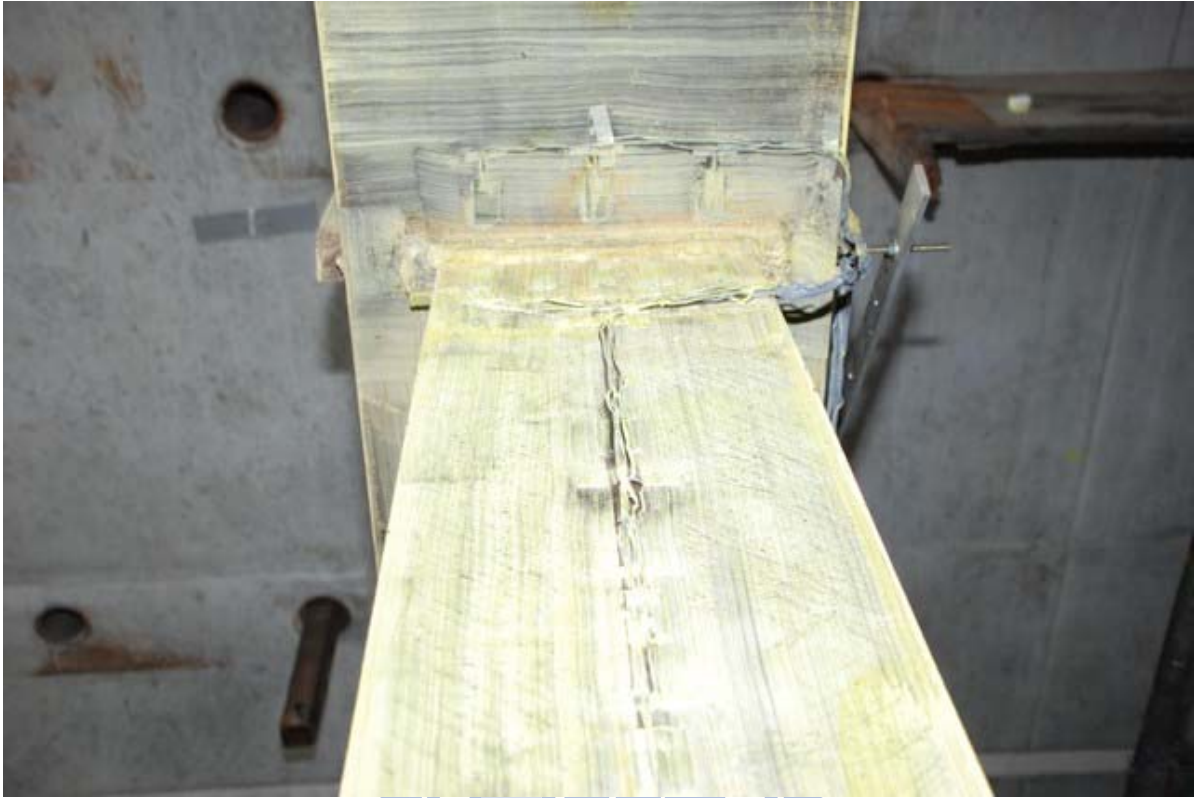
照片 3.15 試體 UR 梁上翼板降伏範圍持續擴大 ( \theta = -3\% 弧度)
