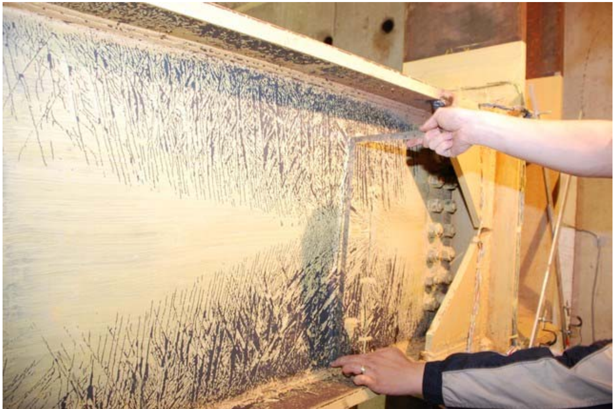
照片 3.79 試體 IFS2 梁腹板於塑鉸處產生 7mm 挫屈 ( \theta = -5\% 弧度第一圈)
