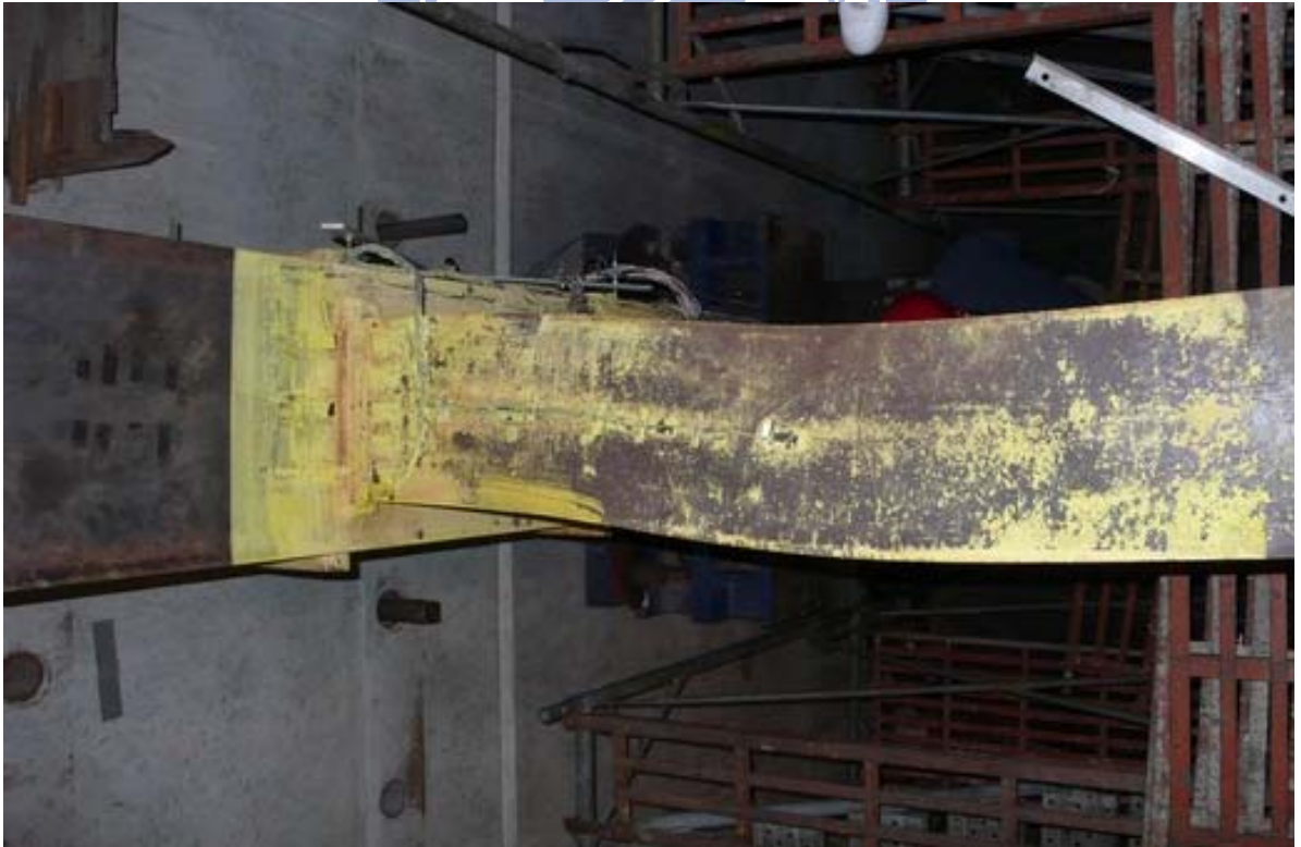
照片 3.54 試體 IFS1 梁整體側向扭轉挫屈情形 ( \theta=5\% 弧度結束)
