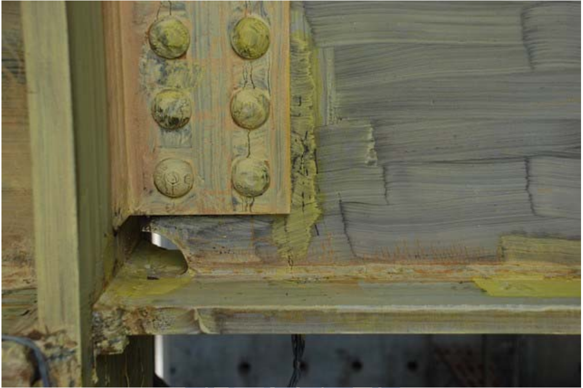
照片 3.5 試體 UR 梁腹板於近剪力板處降伏 ( \theta = +0.75\% )
