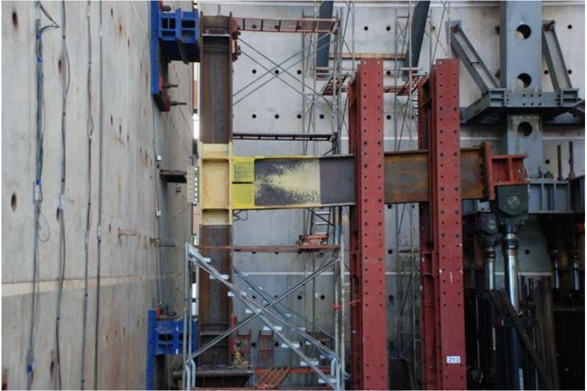
照片 3.55 試體 IFS1 最大位移角之全景 ( \theta = +5\% 弧度)
