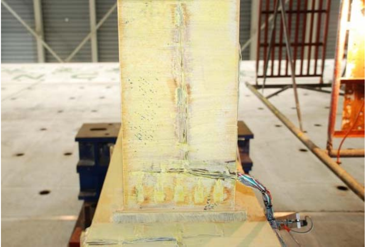
照片 3.57 試體 IFS2 梁下翼板出現降伏( \theta = -0.5\% 弧度)
