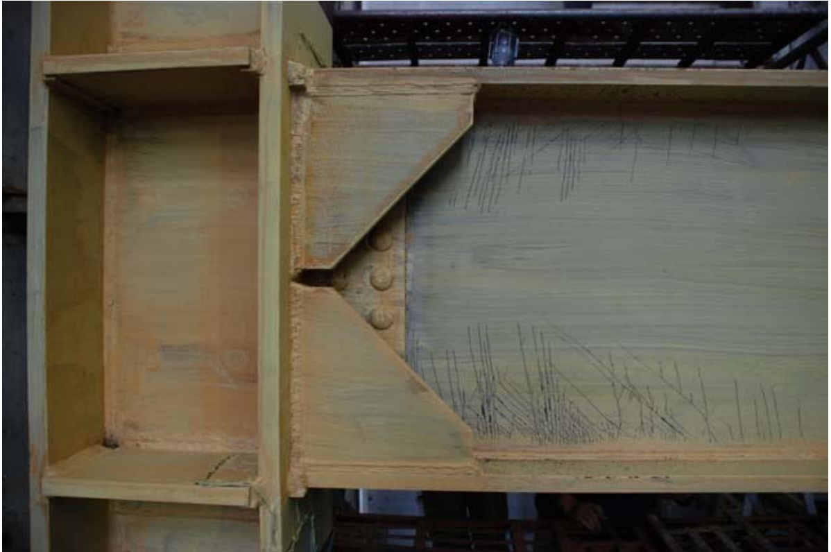
照片 3.61 試體 IFS2 梁腹板降伏範圍擴大 ( \theta = -2\% 弧度)
