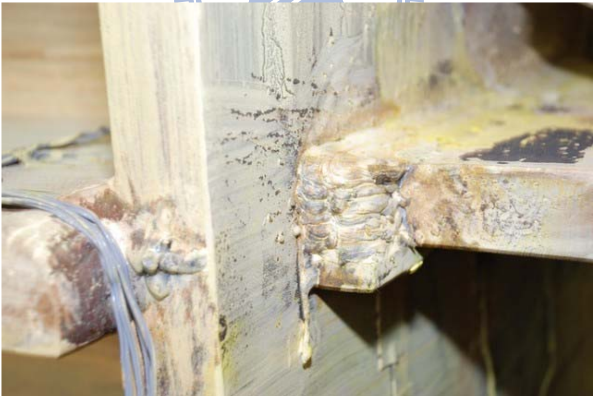
照片 3.24 試體 UR 下翼板左側與焊道交界處裂縫( \theta = +4\% 弧度第一圈)
