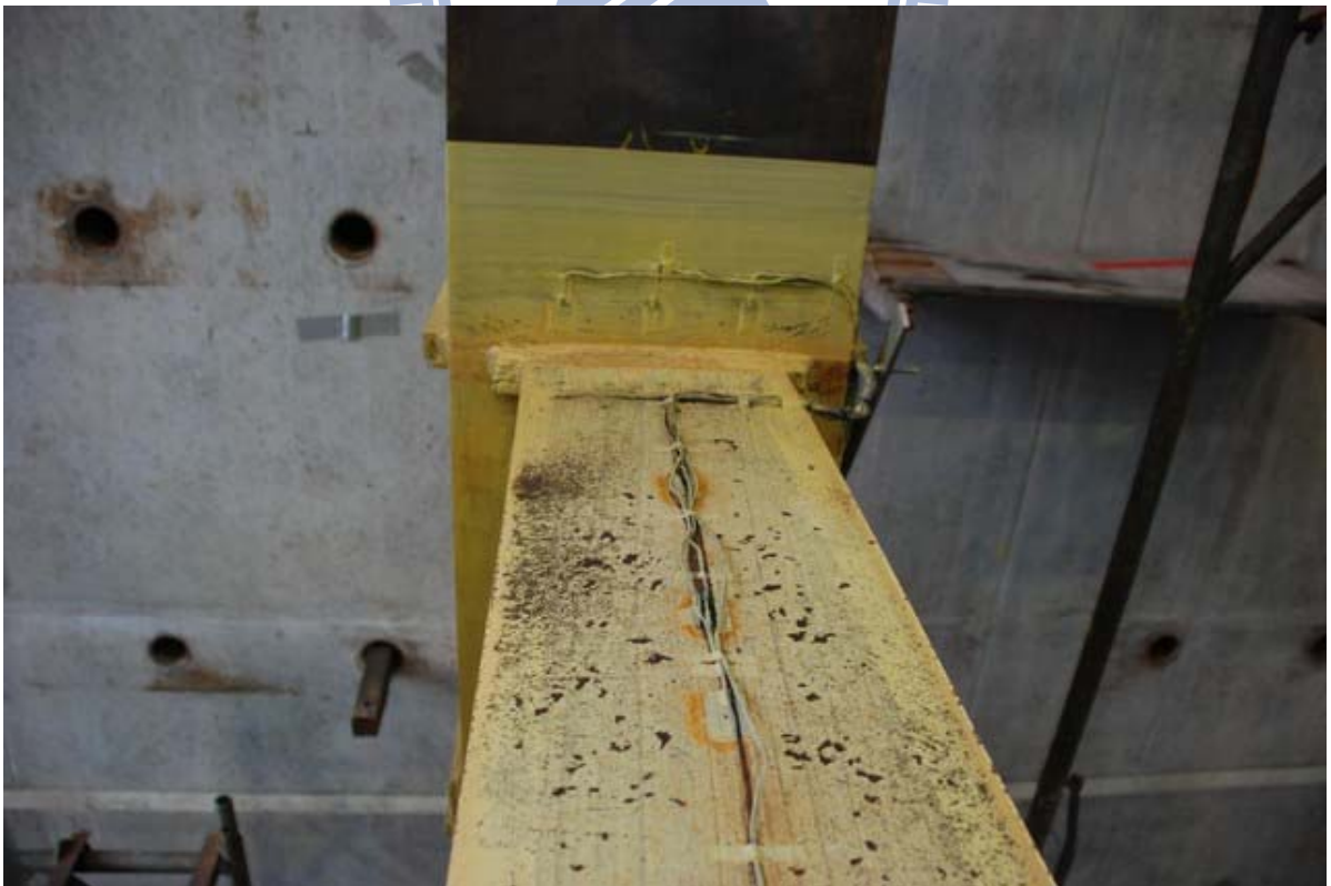
照片 3.70 試體 IFS2 上翼板之降伏情形 ( \theta = -4\% 弧度)
