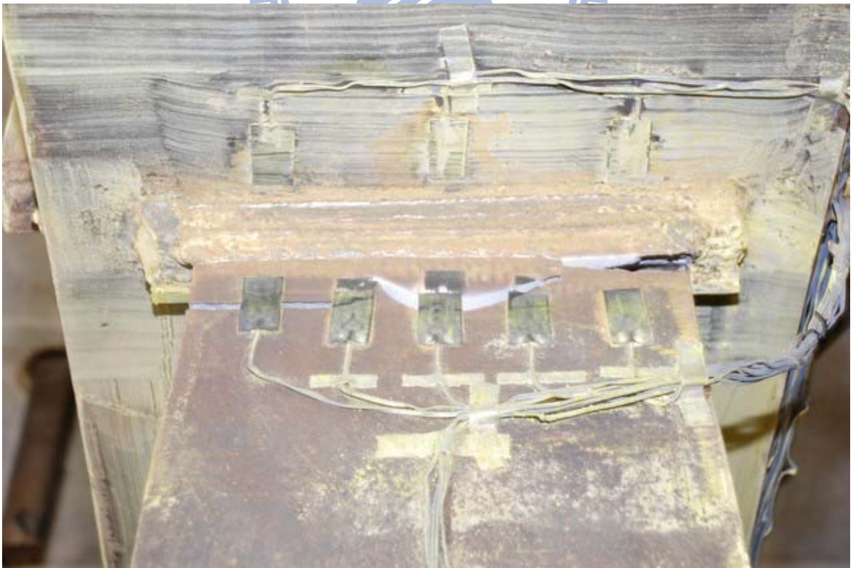
照片 3.26 試體 UR 梁上翼板完全斷裂 ( \theta = -4\% 弧度第二圈時)
