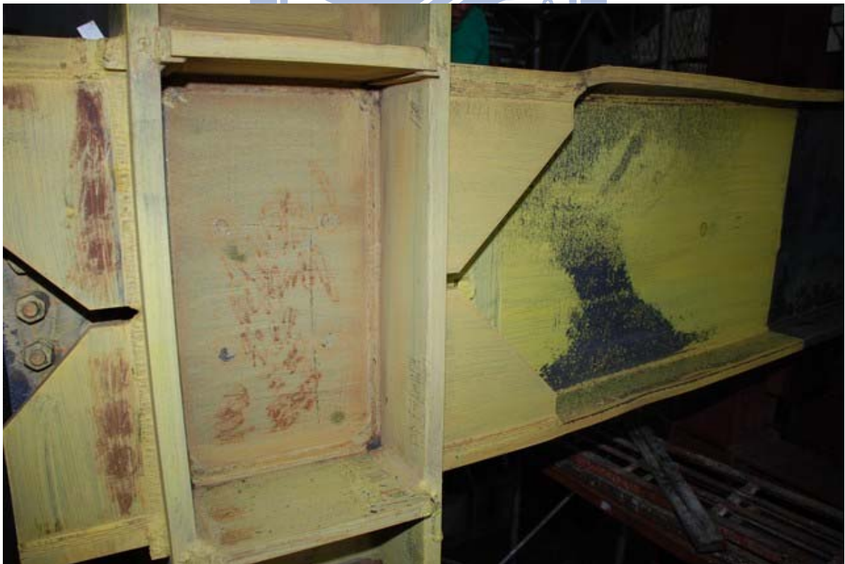
照片 3.134 試體 IFS3 交會區柱翼板內側降伏情形 ( \theta = +6\% 弧度第一圈)
