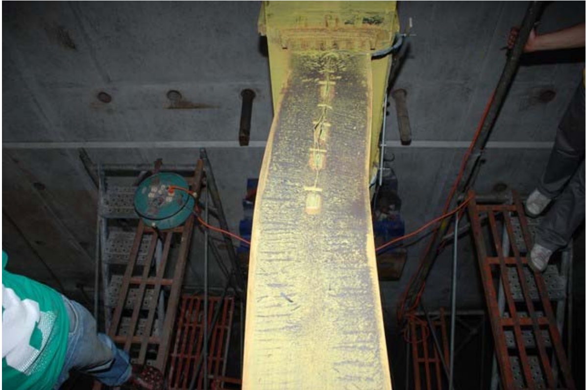
照片 3.133 試體 IFS3 梁上翼板側向扭轉挫屈情形 ( \theta = +6\% 弧度第一圈)
