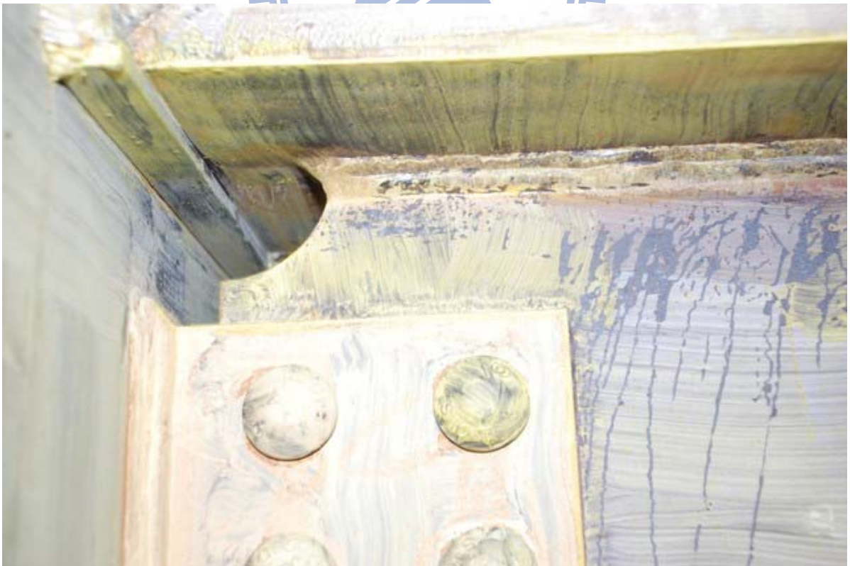
照片 3.16 試體 UR 梁腹板與剪力板產生相對位移 ( \theta = -3\% 弧度)
