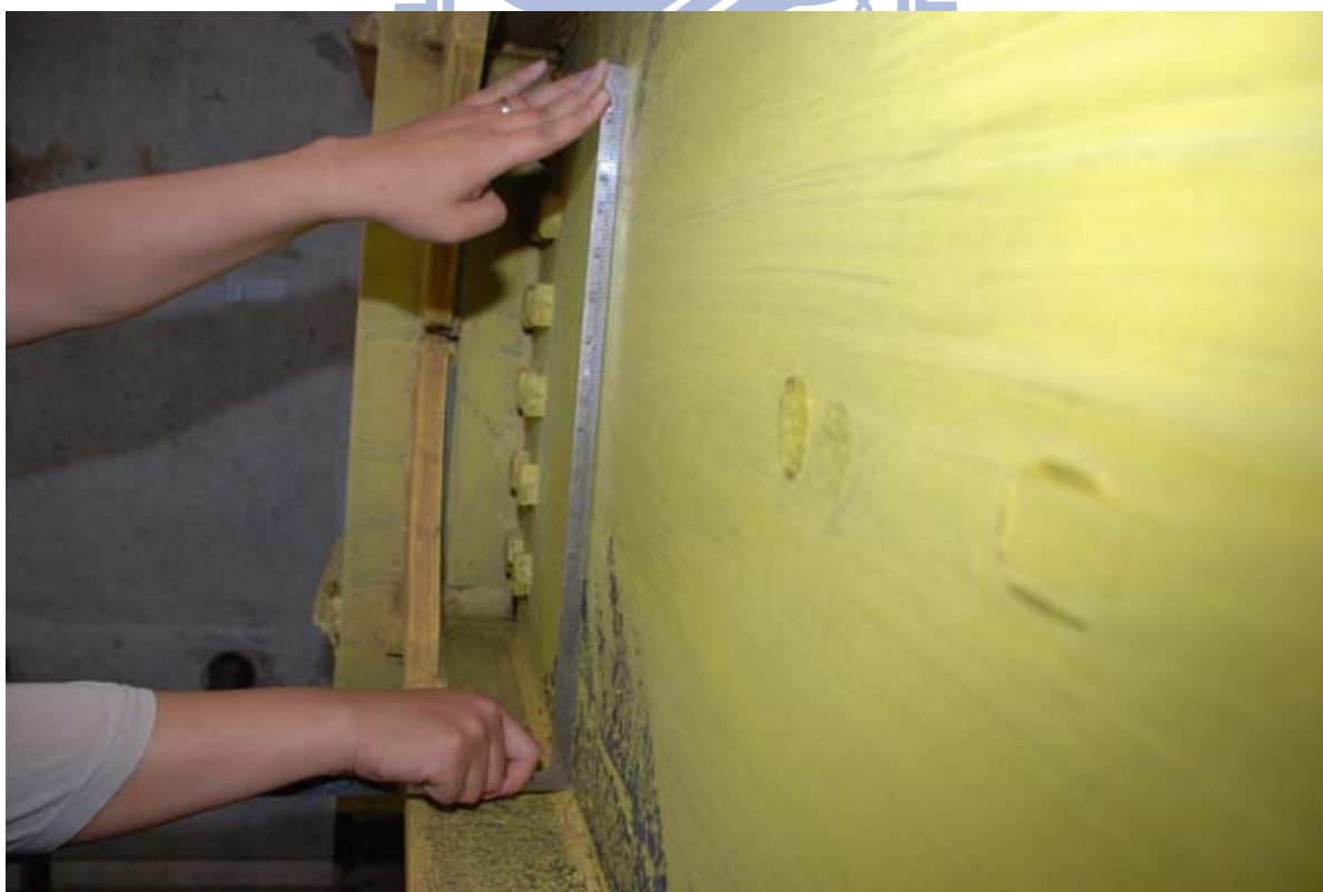
照片 3.102 試體 IFS3 梁腹板於塑鉸處產生 2mm 挫屈 ( \theta = -4\% 弧度)
