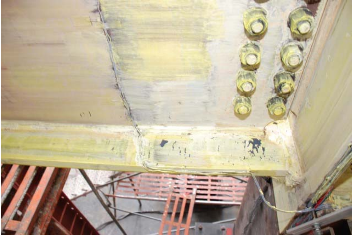
照片 3.7 試體 UR 下翼板內側降伏 ( \theta = +1\% 弧度)
