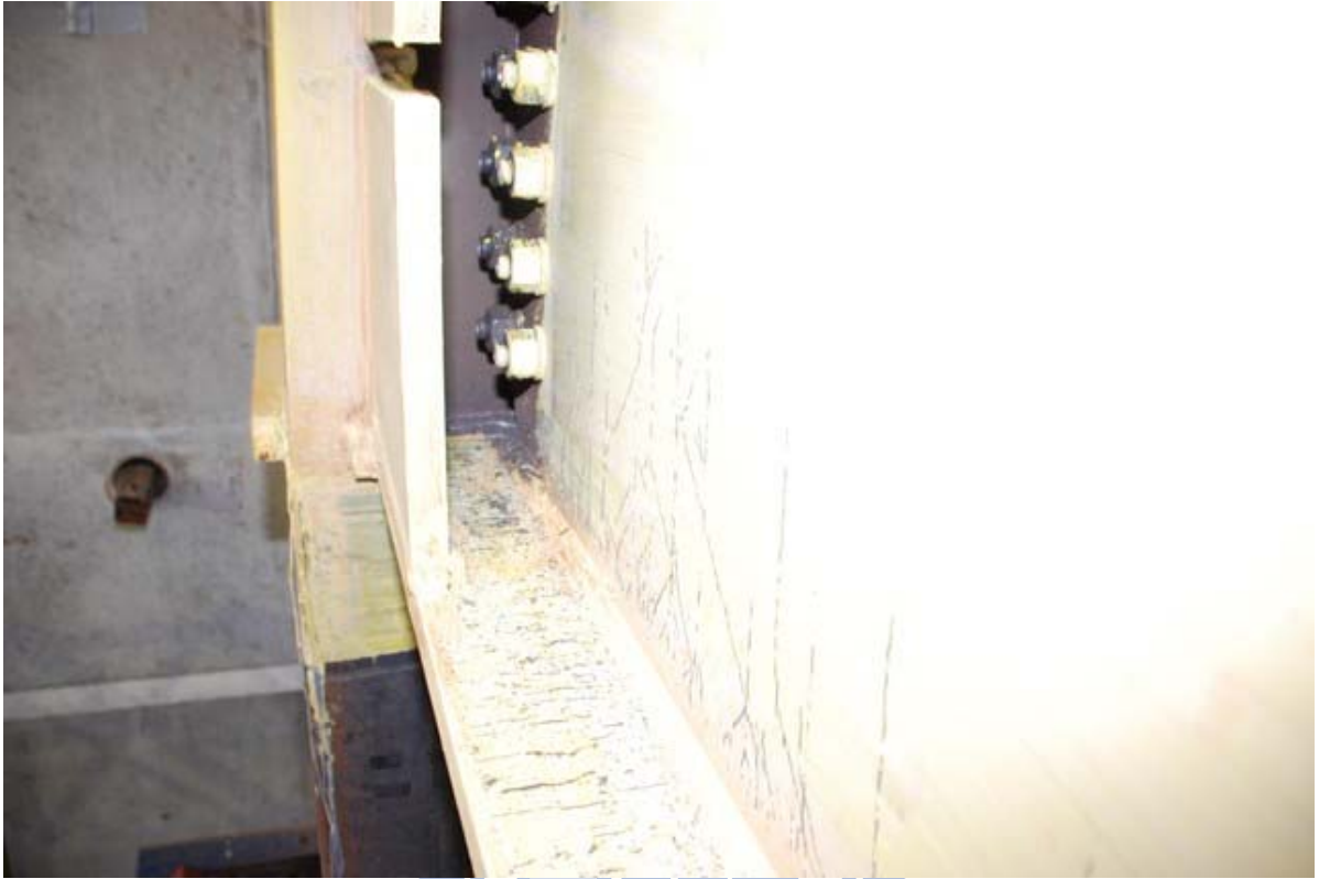
照片 3.35 試體 IFS1 梁下翼板內側降伏擴大 ( \theta = -1.5\% 弧度)
