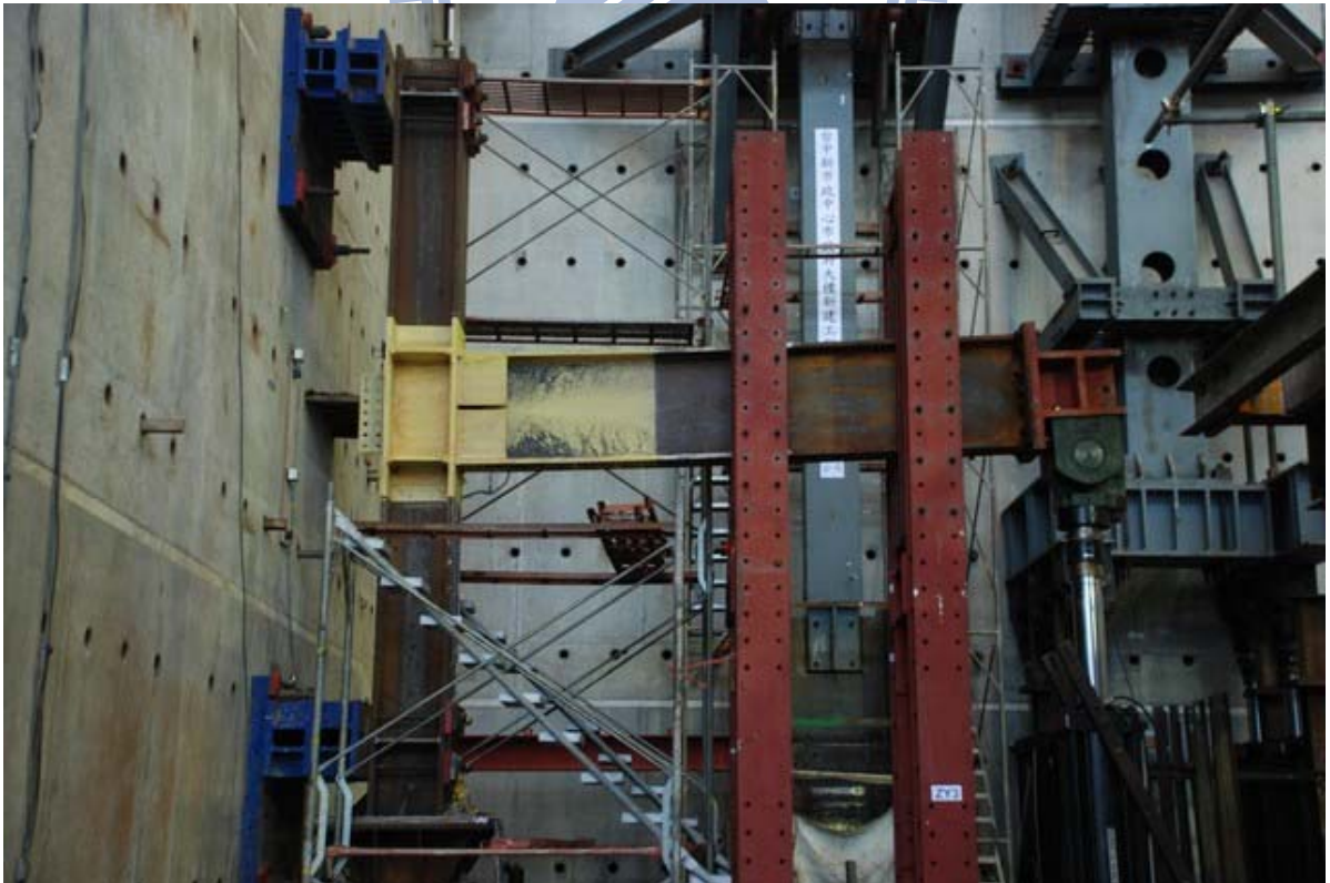
照片 3.46 試體 IFS1 第一次試驗結束前全景 ( \theta=+4\% 弧度)
