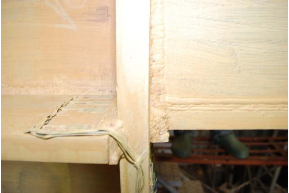
照片 3.65 試體 IFS2 左側下方加勁板出現降伏 ( \theta = -3\% 弧度)
