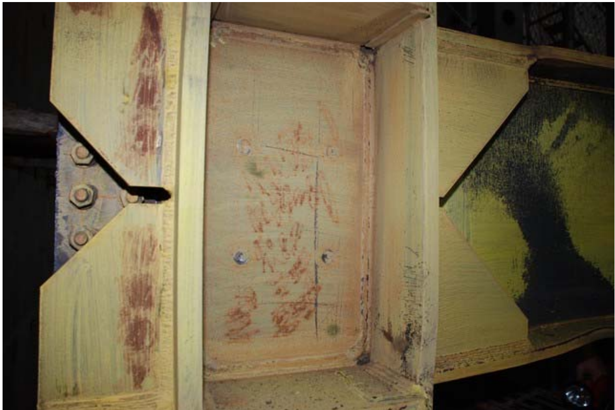
照片 3.139 試體 IFS3 交會區疊合板降伏情形 ( \theta = +6\% 弧度第二圈)
