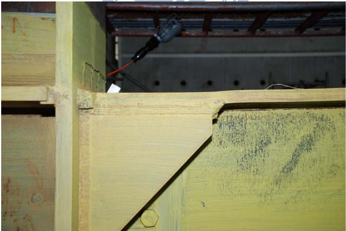
照片 3.104 試體 IFS3 梁上翼於加勁板端部產生 2mm 挫屈 ( \theta = +4\% 弧度)
