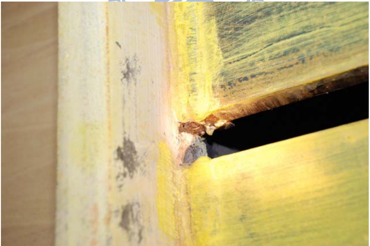
照片 3.52 試體 IFS1 柱翼板與加勁板端部接合處開裂 ( \theta=5\% 弧度結束)
