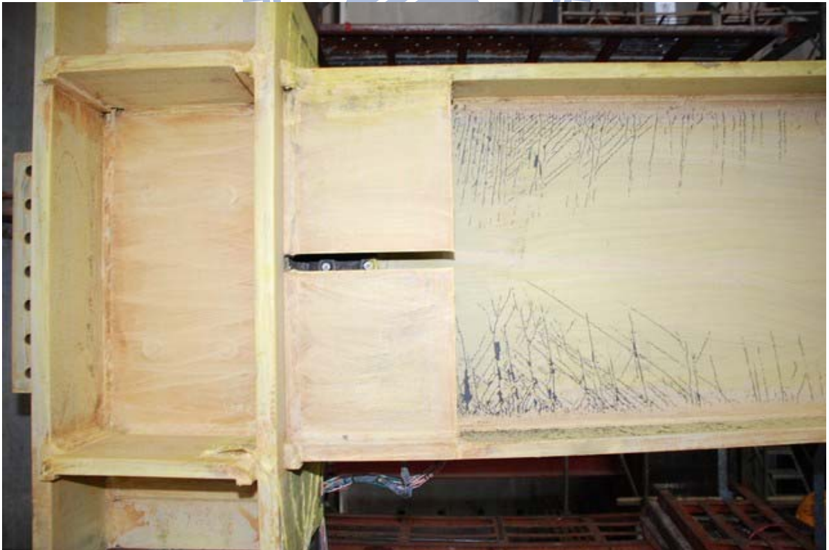
照片 3.38 試體 IFS1 加勁板及交會區保持彈性 ( \theta = +2\% 弧度)
