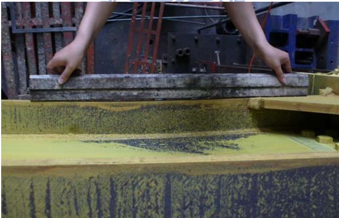
照片 3.118 試體 IFS3 梁下翼板產生側向扭轉挫屈10mm ( \theta = -4\% 弧度)
