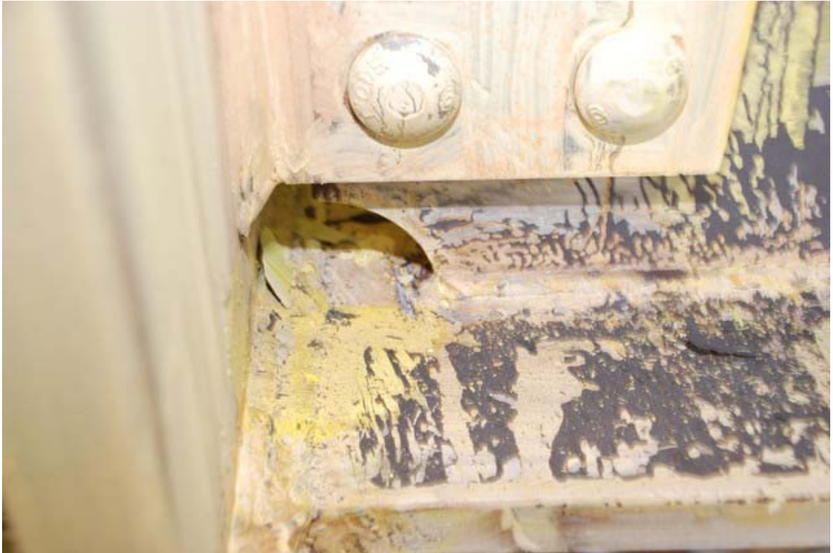
照片 3.23 試體 UR 下翼板與腹板於扇形開口處開裂( \theta = +4\% 弧度第一圈)
