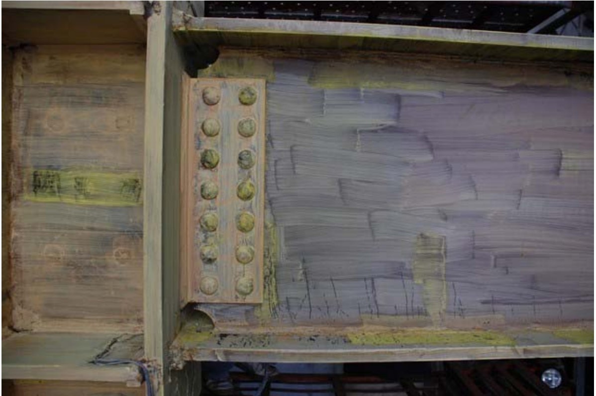
照片 3.11 試體 UR 梁下翼板內側及腹板降伏擴大 ( \theta = +1.5\% 弧度)
