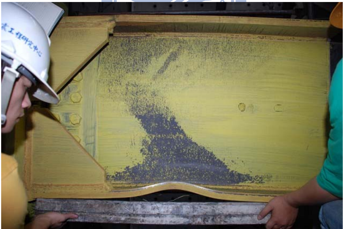
照片 3.132 試體 IFS3 梁下翼於加勁板端部產生 50mm 挫屈 ( \theta = -6\% 弧度)
