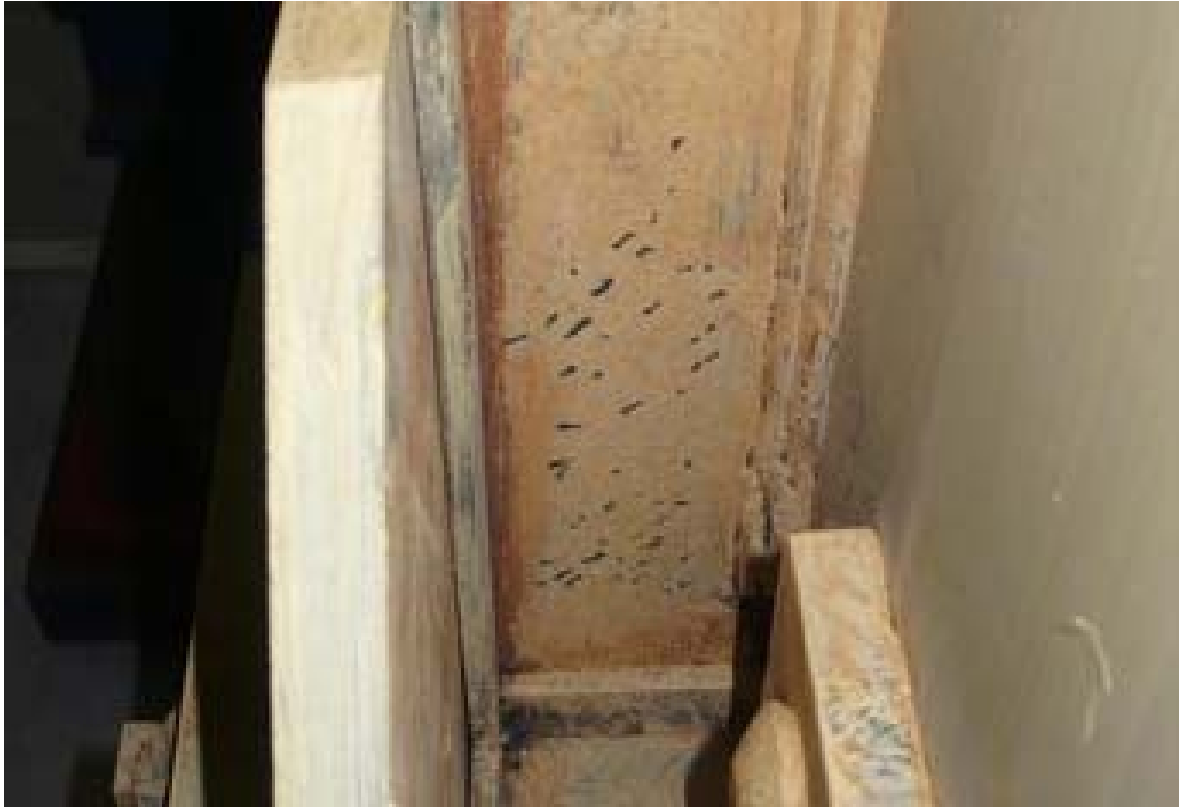
照片 3.59 試體 IFS2 梁上翼板內側出現降伏( \theta = -0.5\% 弧度)
