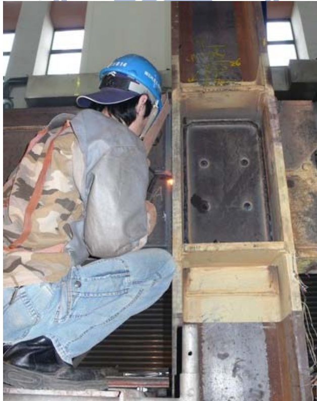
照片 2.2 試體 IFS3 加勁板與梁翼板及柱板焊接情形
