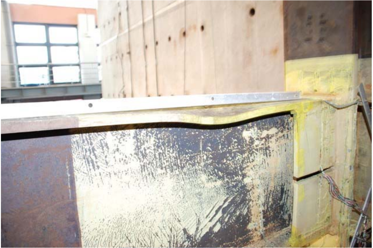
照片 3.53 試體 IFS1 梁上翼板局部挫屈情形 ( \theta=5\% 弧度結束)
