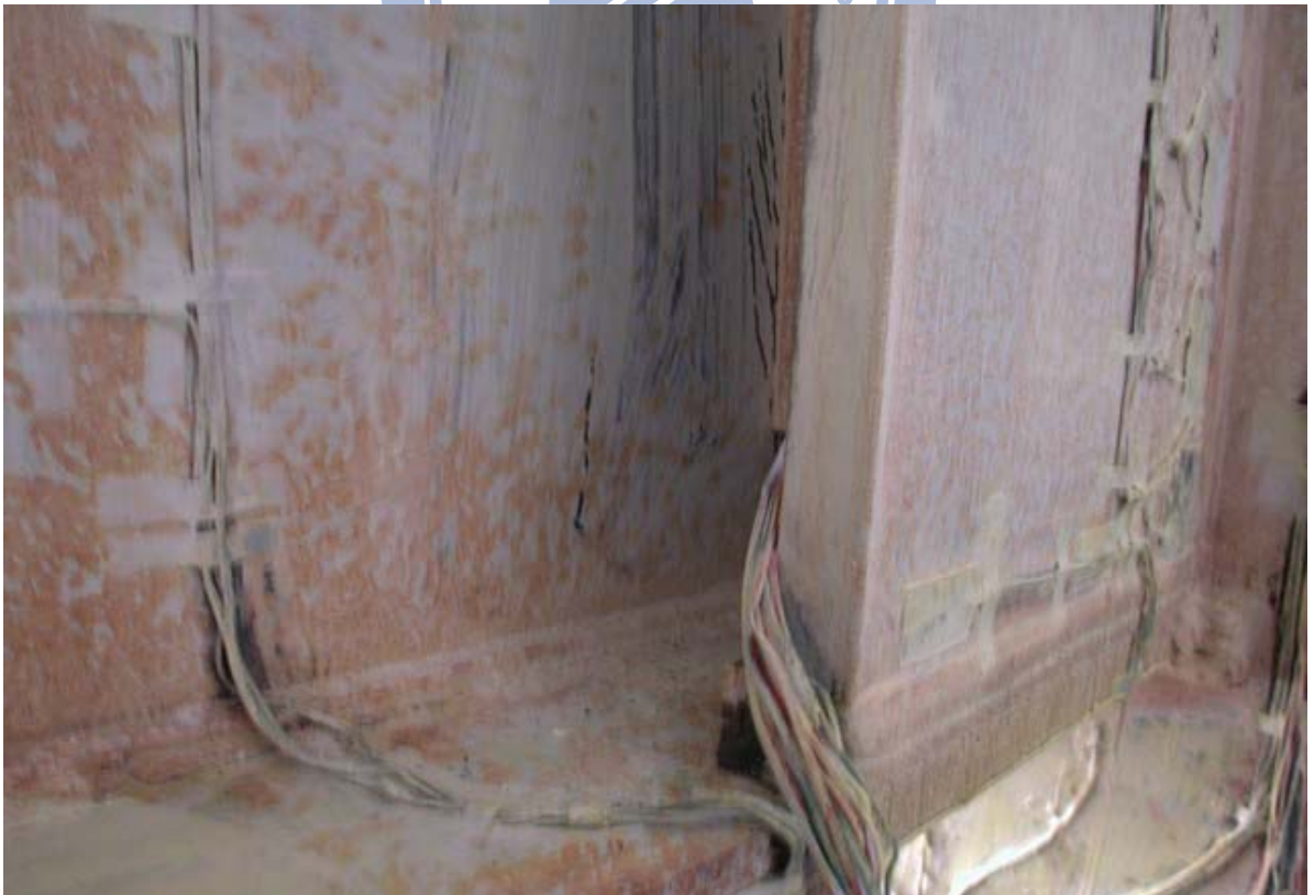
照片 3.30 試體 IFS1 梁腹板於近剪力板處降伏 ( \theta = +0.75\% 弧度)
