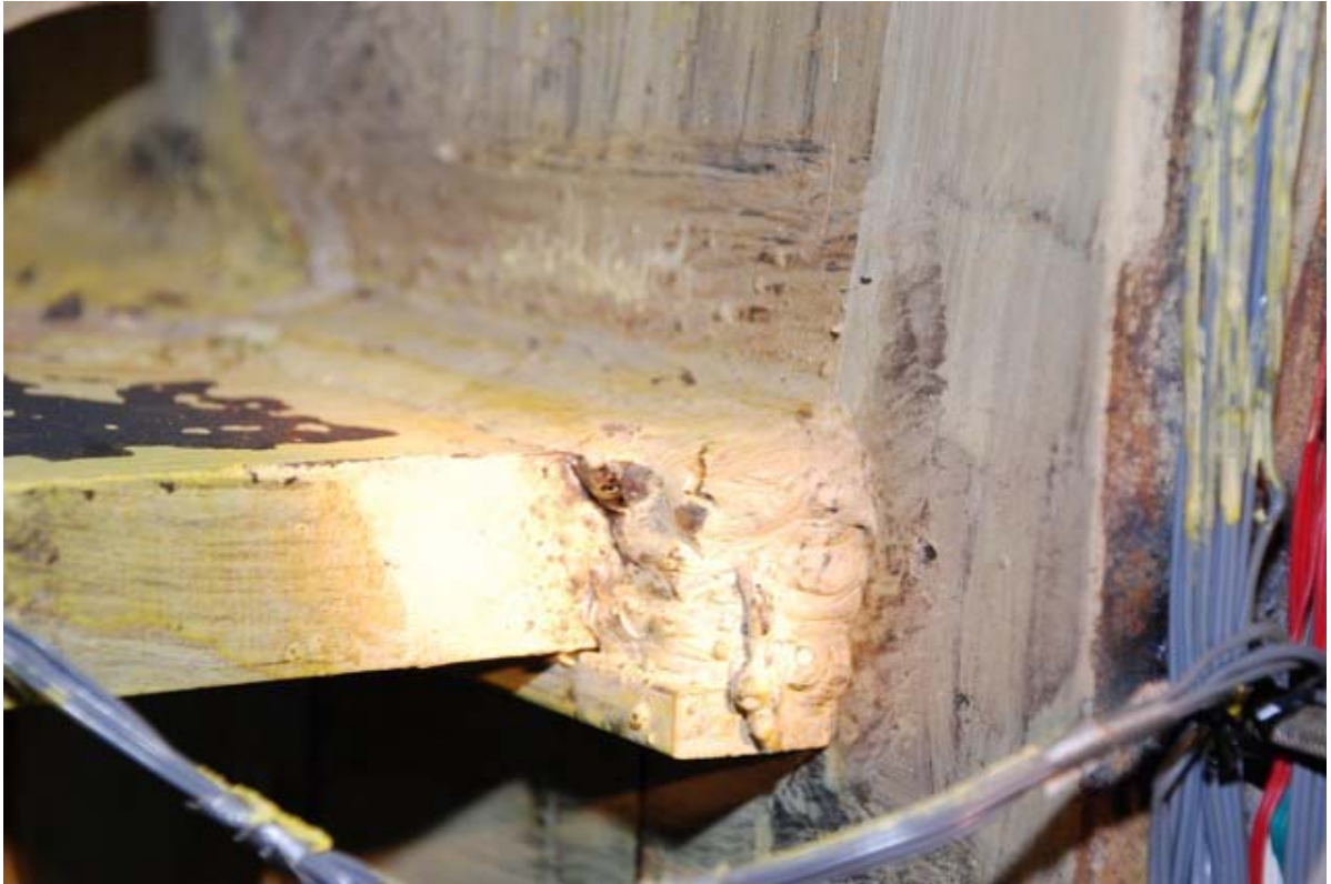
照片 3.25 試體 UR 下翼板右側與焊道交界處裂縫 ( \theta = +4\% 弧度第一圈)
