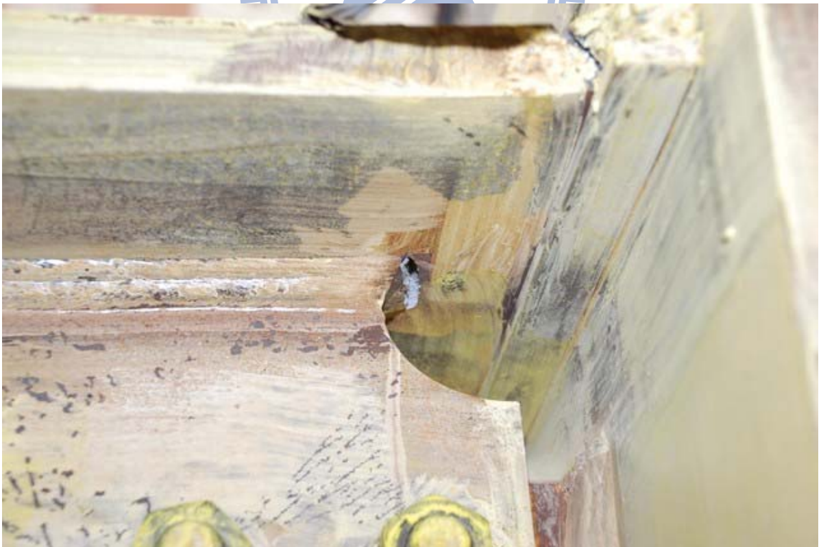
照片 3.22 試體 UR 上翼板與腹板於扇形開口處開裂( \theta = -4\% 弧度第一圈)
