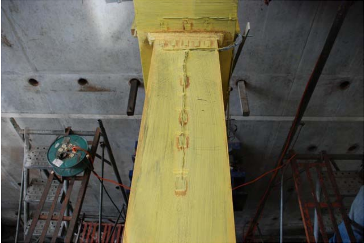
照片 3.93 試體 IFS3 梁上翼板降伏範圍增加 ( \theta = -2\% 弧度)
