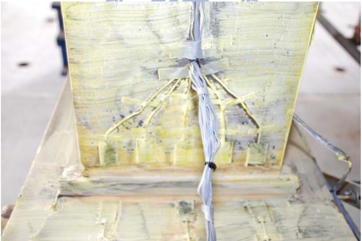
照片 3.6 試體 UR 梁下翼板降伏 ( \theta = +1\% 弧度)
