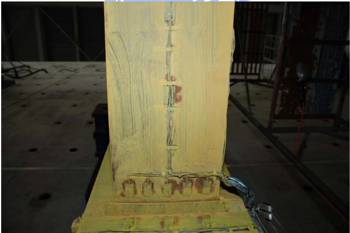
照片 3.90 試體 IFS3 梁下翼板降伏範圍增加 ( \theta=0.5\% 弧度結束)
