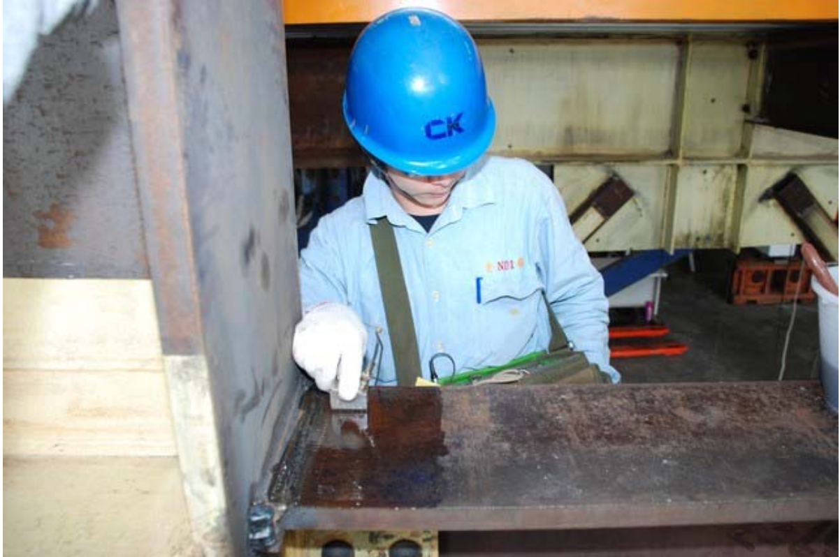
照片 3.1 試體 UR 梁翼板 UT 檢測
