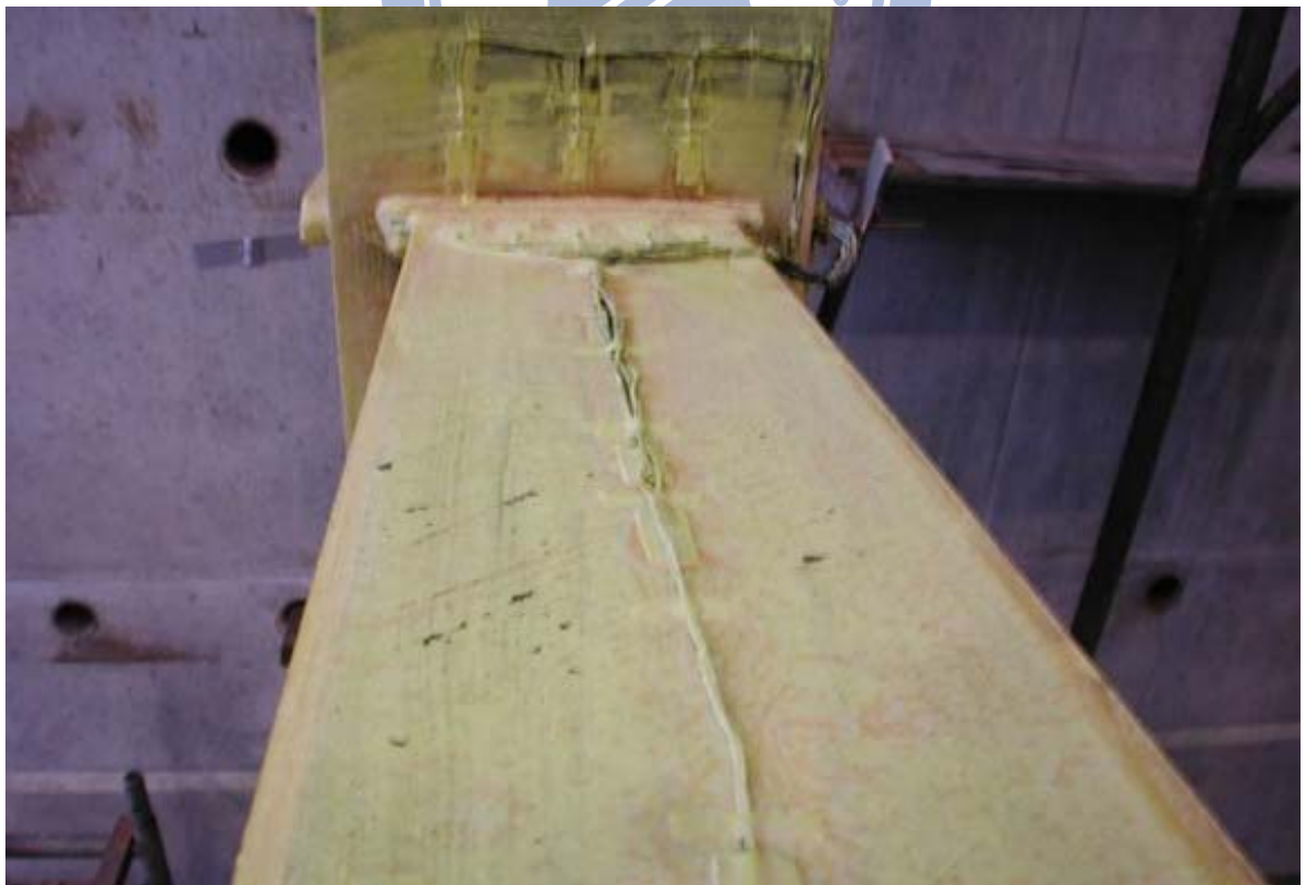
照片 3.36 試體 IFS1 梁上翼板出現降伏 ( \theta = +1.5\% 弧度)
