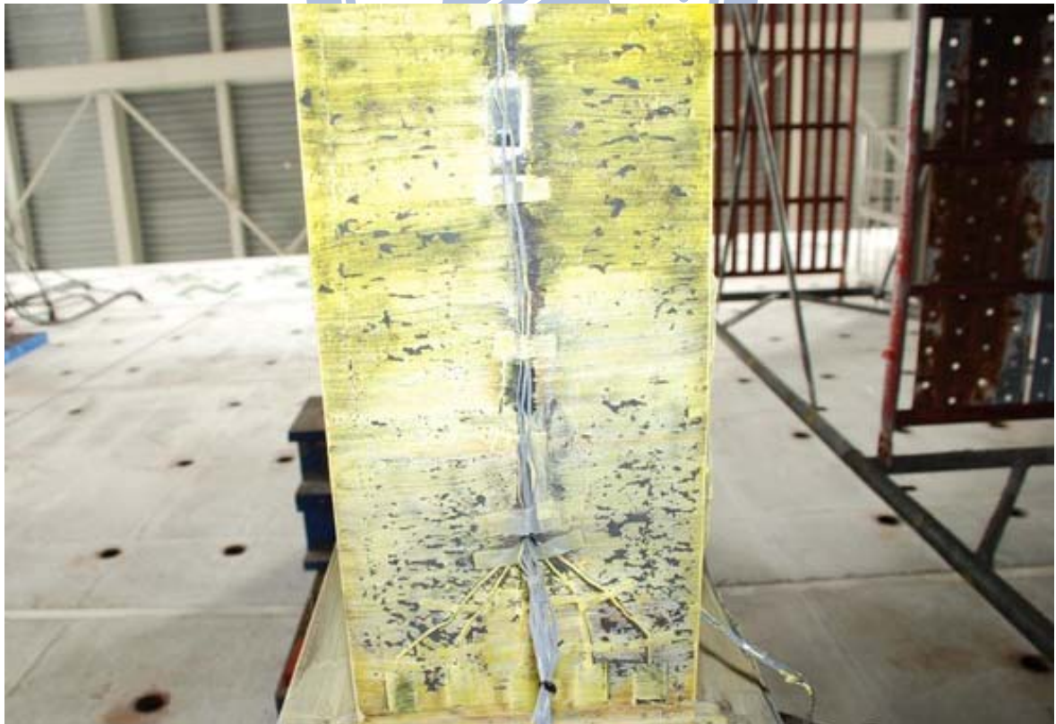
照片 3.10 試體 UR 梁下翼板降伏範圍擴大 ( \theta = +1.5\% 弧度)
