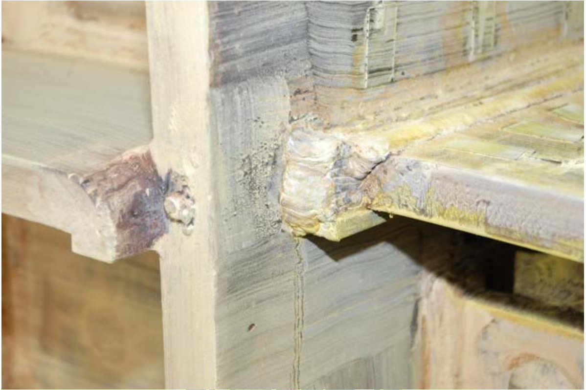
照片 3.19 試體 UR 上翼板左側與焊道交界處裂縫( \theta = -4\% 弧度第一圈)
