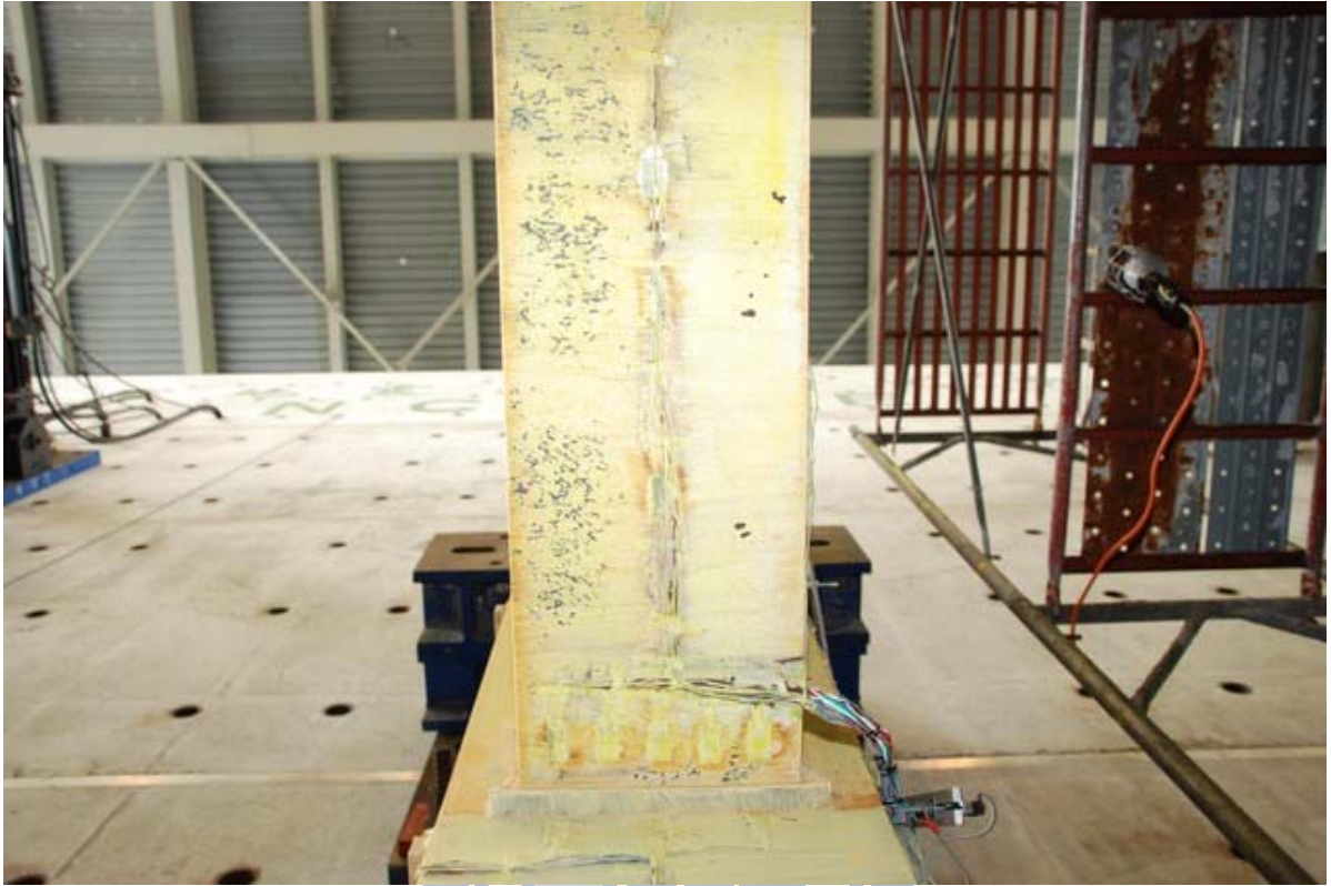
照片 3.63 試體 IFS2 梁下翼板降伏範圍擴大 ( \theta = -2\% 弧度)
