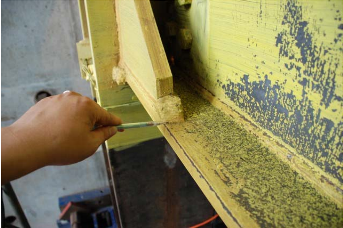
照片 3.115 試體 IFS3 加勁板焊道端部出現小裂痕 ( \theta = -3\% 弧度)
