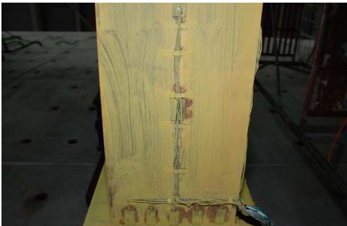
照片 3.87 試體 IFS3 梁下翼板輕微降伏 ( \theta=0.375\% 弧度結束)
