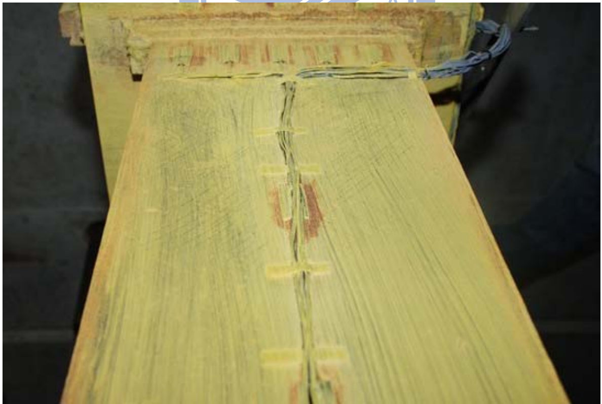
照片 3.86 試體 IFS3 梁上翼板輕微降伏 ( \theta=0.375\% 弧度結束)
