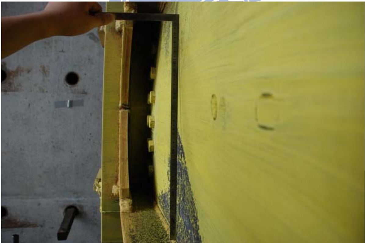
照片 3.122 試體 IFS3 梁腹板於塑鉸處產生15mm挫屈 ( \theta = -5\% 弧度)
