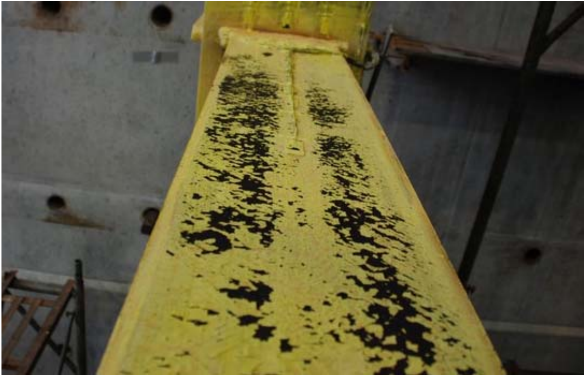
照片 3.41 試體 IFS1 梁上翼板降伏擴大 ( \theta = -4\% 弧度)
