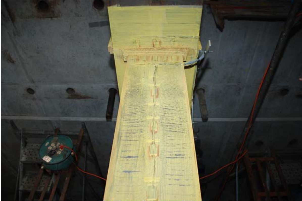
照片 3.97 試體 IFS3 梁上翼板降伏情形 ( \theta = -3\% 弧度)
