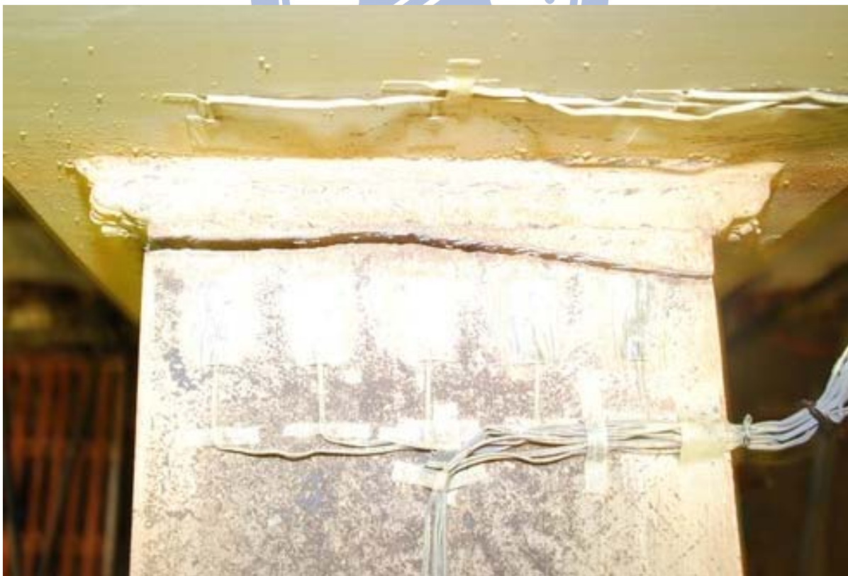
照片 3.82 試體 IFS2 梁上翼板母材斷裂 ( \theta = -5\% 弧度第二圈)
