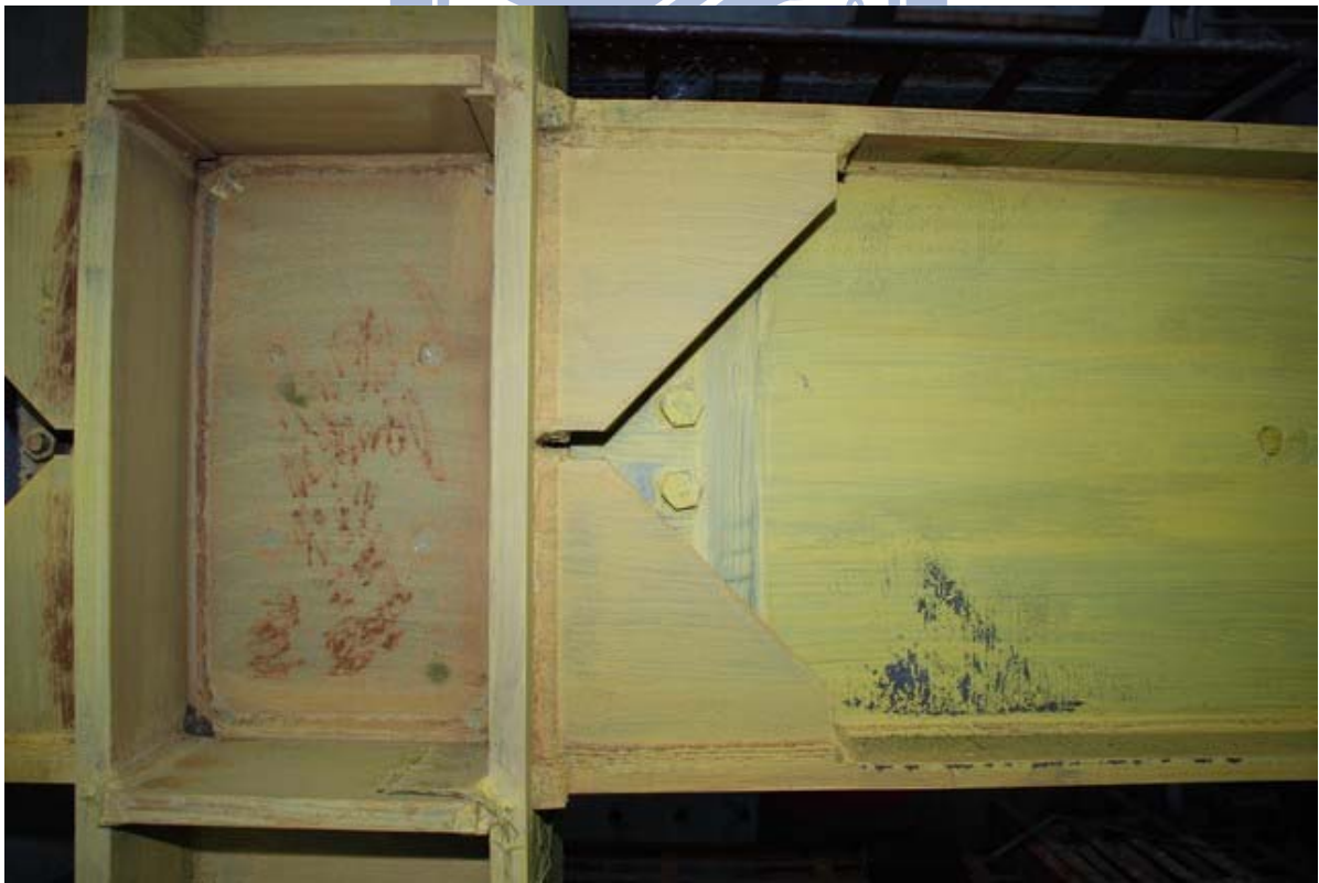
照片 3.98 試體 IFS3 梁塑鉸處降伏嚴重 ( \theta = -3\% 弧度)
