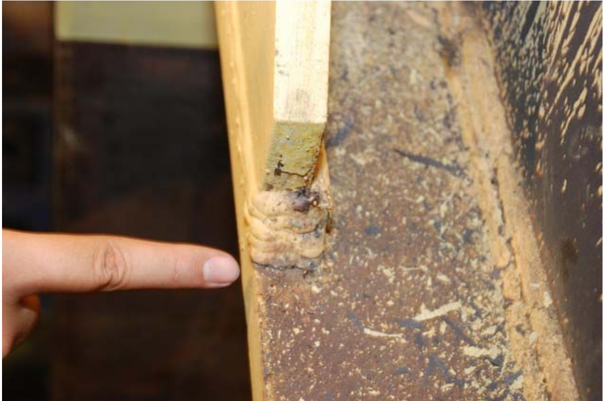
照片 3.81 試體 IFS2 加勁板端部產生 20mm 裂縫 ( \theta = -5\% 弧度第一圈)
