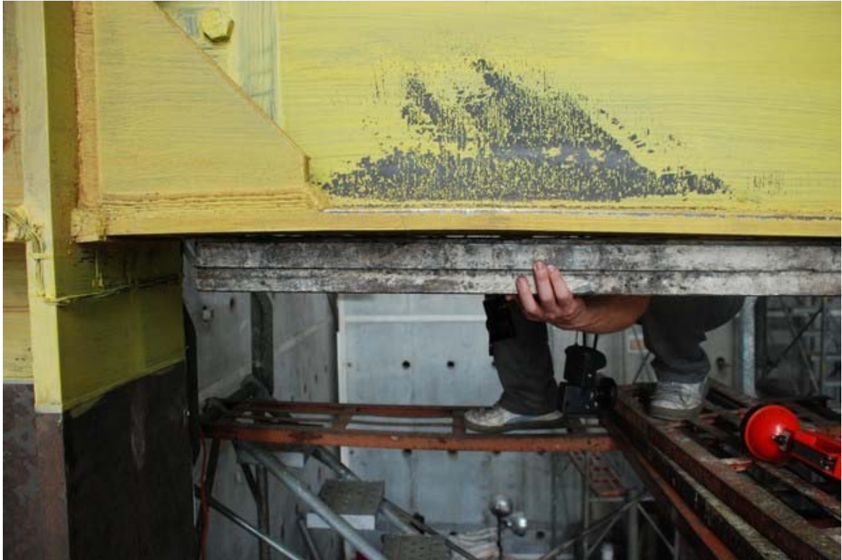
照片 3.117 試體 IFS3 梁下翼板產生10mm 撓曲變形 ( \theta = -4\% 弧度)
