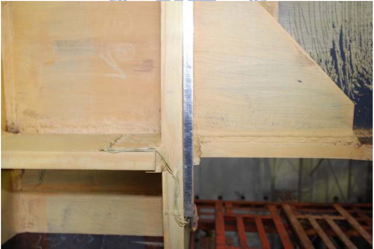
照片 3.76 試體 IFS2 柱板產生輕微變形 ( \theta = -4\% 弧度)
