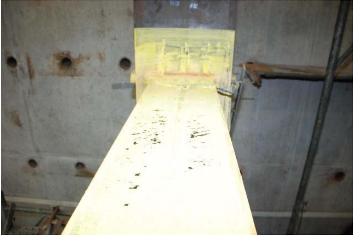
照片 3.37 試體 IFS1 梁上翼板降伏擴大 ( \theta = -2\% 弧度)
