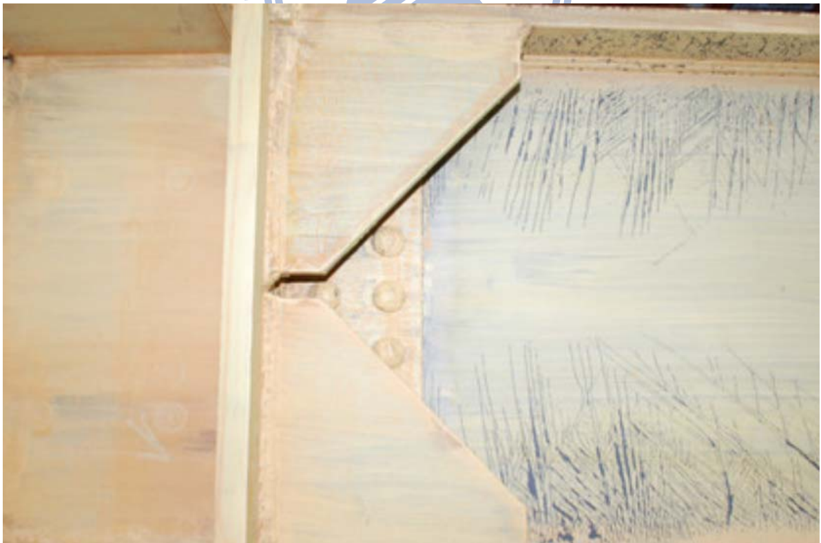
照片 3.64 試體 IFS2 梁腹板與剪力板出現相對位移 ( \theta = -3\% 弧度)
