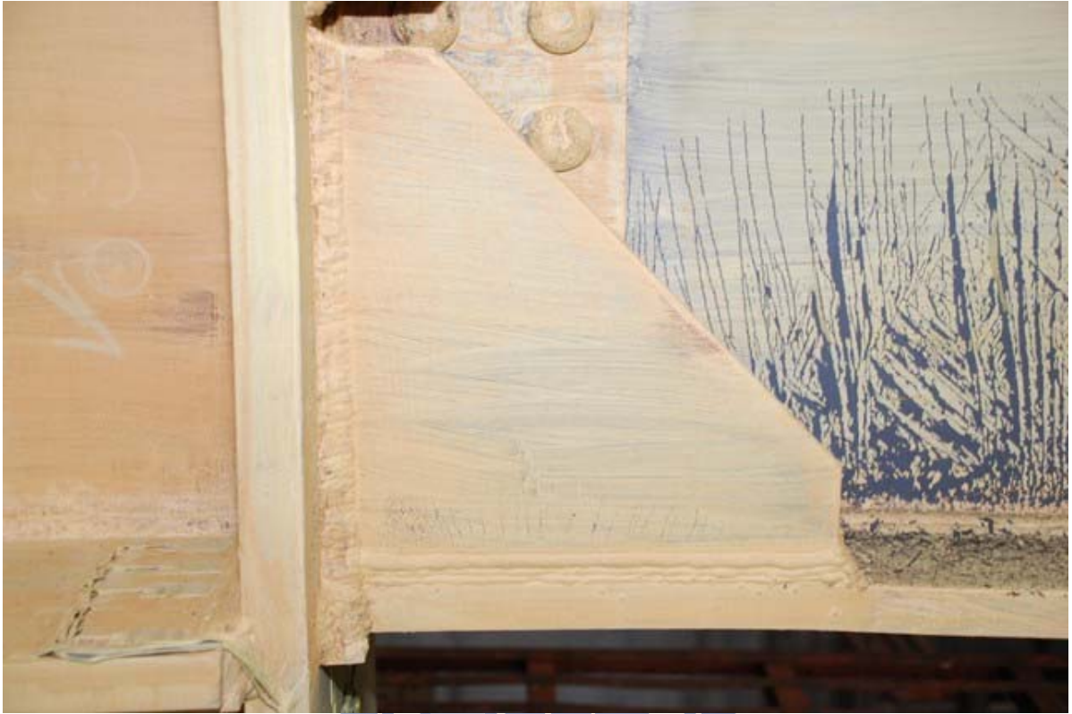
照片 3.69 試體 IFS2 加勁板降伏情形 ( \theta = -4\% 弧度)
