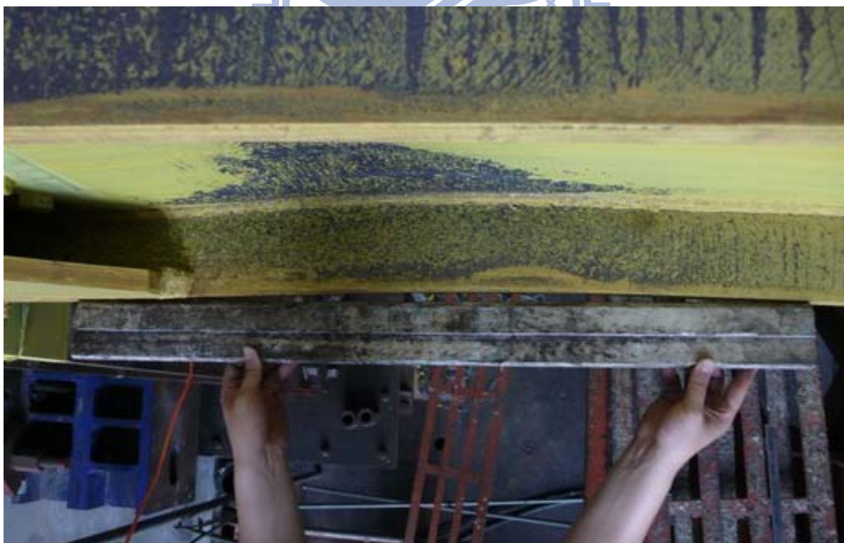
照片 3.124 試體 IFS3 梁下翼板產生側向扭轉挫屈15mm ( \theta = -5\% 弧度)
