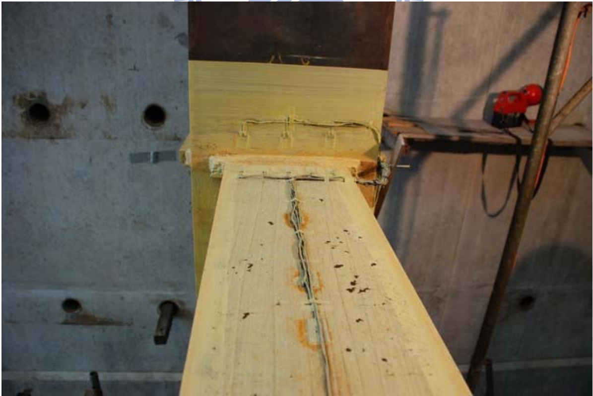
照片 3.60 試體 IFS2 梁上翼板降伏範圍擴大( \theta = -2\% 弧度)
