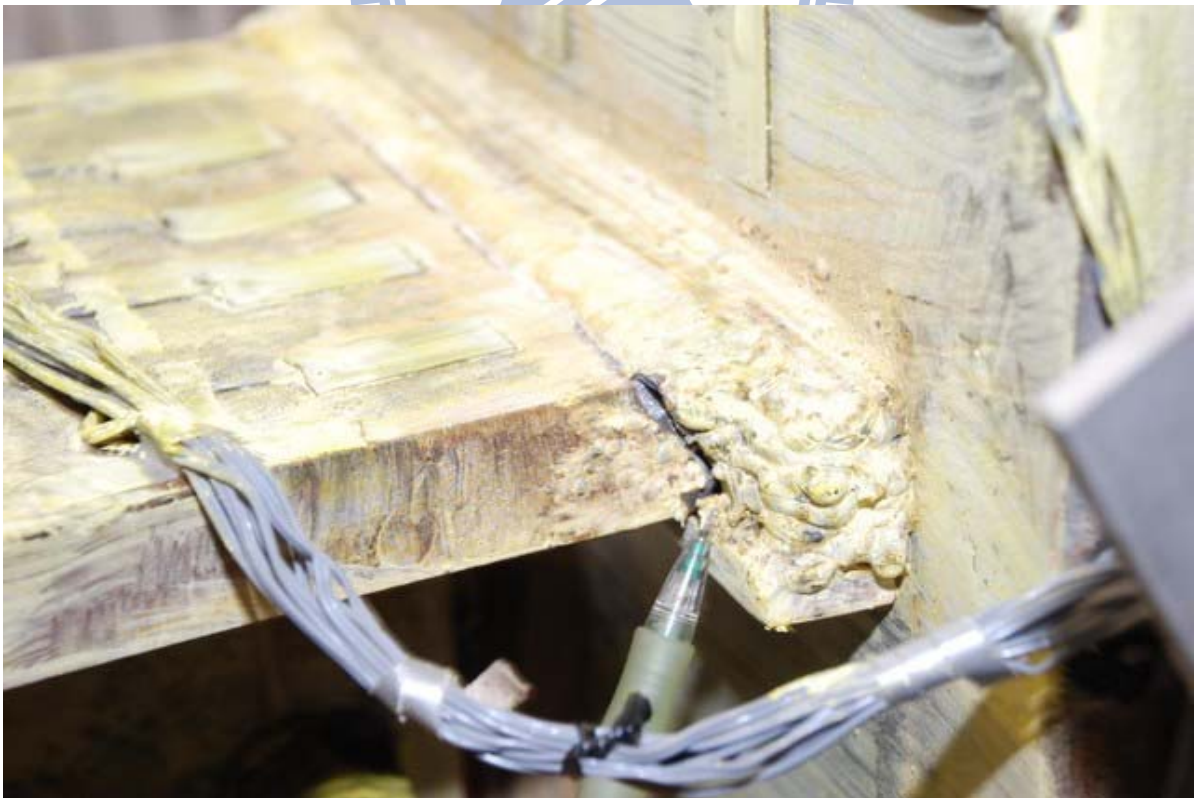
照片 3.20 試體 UR 上翼板右側與焊道交界處裂縫( \theta = -4\% 弧度第一圈)
