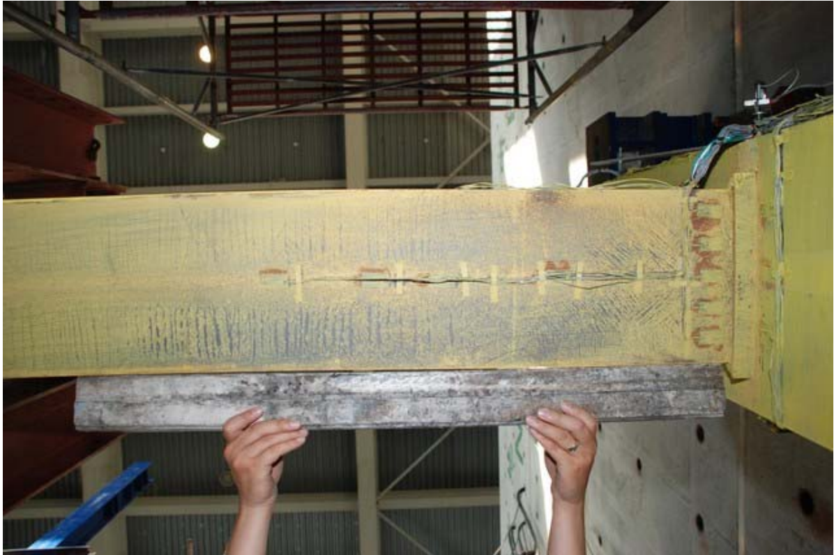
照片 3.103 試體 IFS3 梁下翼板產生輕微側向扭轉挫屈 ( \theta = -4\% 弧度)
