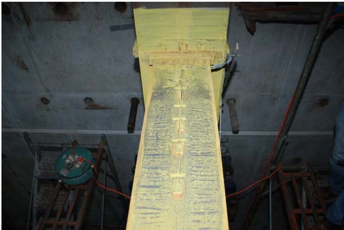
照片 3.101 試體 IFS3 梁上翼板降伏情形 ( \theta = -4\% 弧度)
