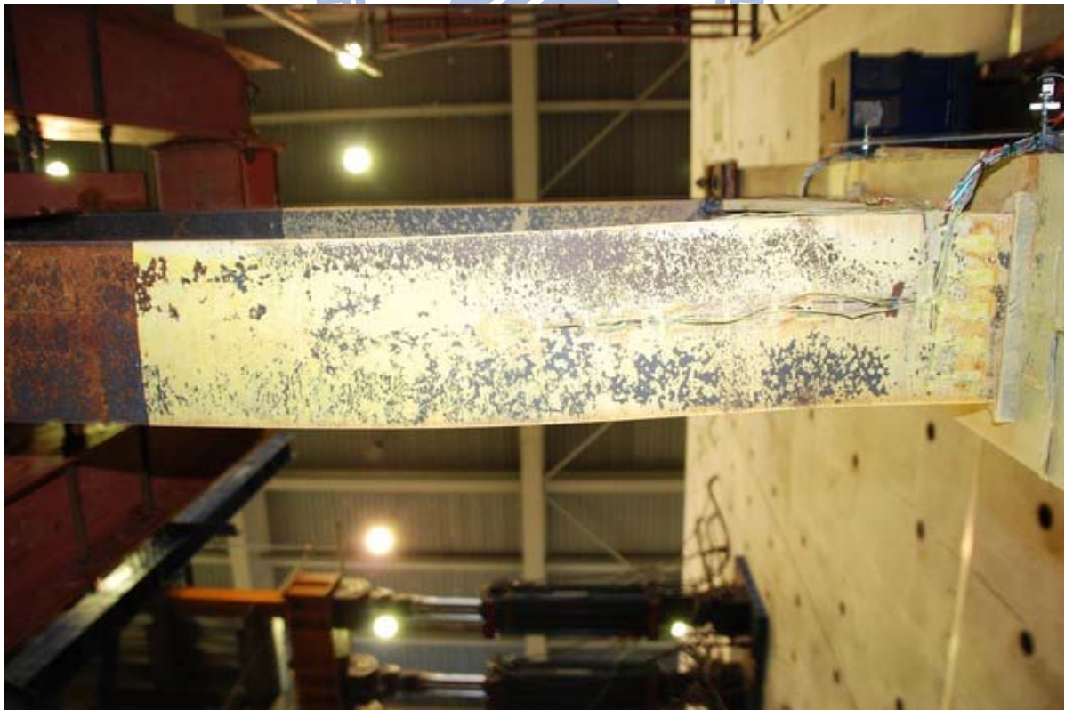
照片 3.80 試體 IFS2 梁下翼板產生側向扭轉挫屈 ( \theta = -5\% 弧度第一圈)
