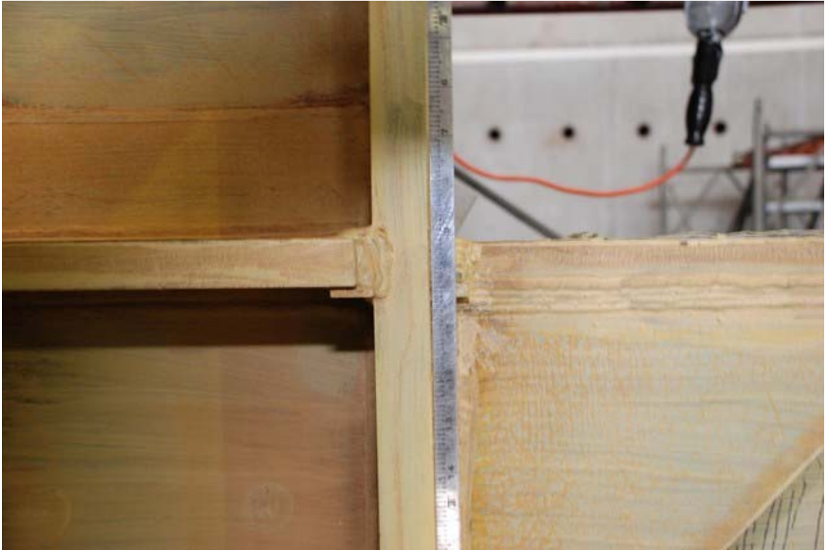
照片 3.67 試體 IFS2 柱翼板產生輕微之變形 ( \theta = +3\% 弧度)
