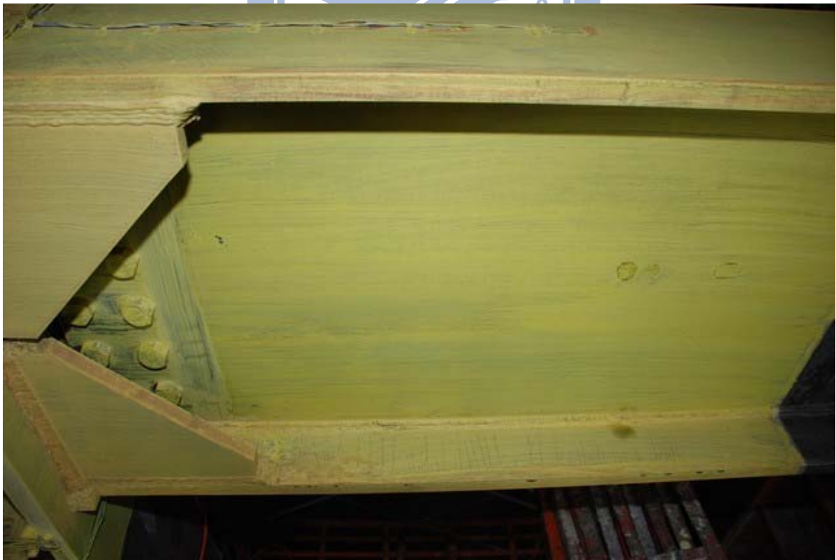
照片 3.92 試體 IFS3 梁下翼板內側降伏範圍增加 ( \theta=-1.5\% 弧度)
