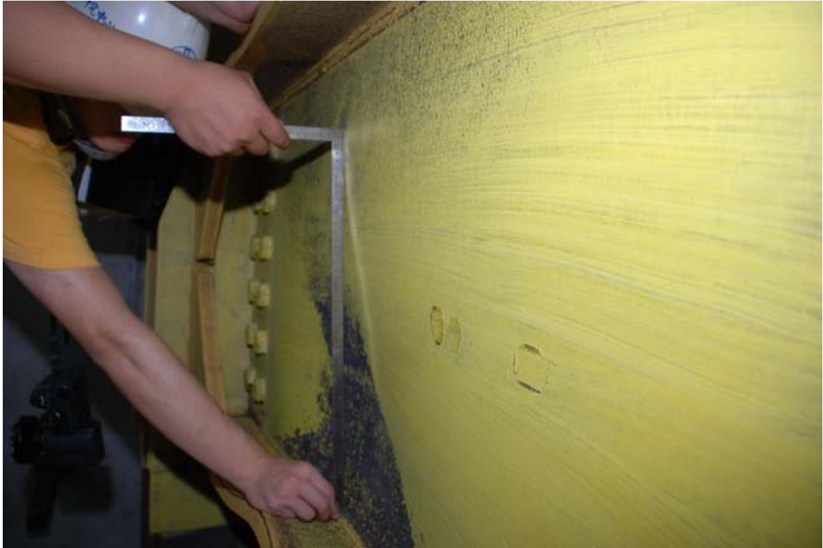
照片 3.131 試體 IFS3 梁腹板於塑鉸處產生 30mm 挫屈 ( \theta = -6\% 弧度)
