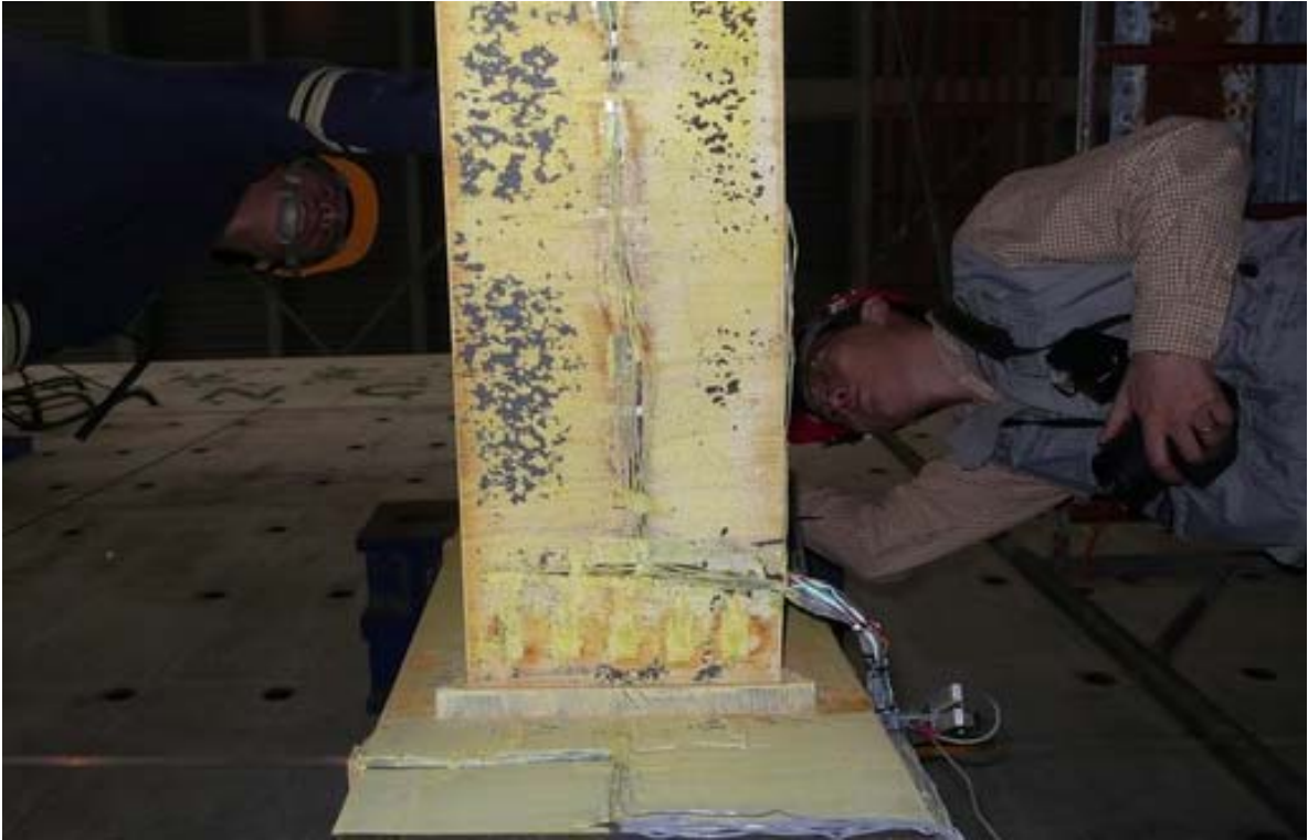
照片 3.71 試體 IFS2 下翼板之降伏情形 ( \theta = +4\% 弧度)
