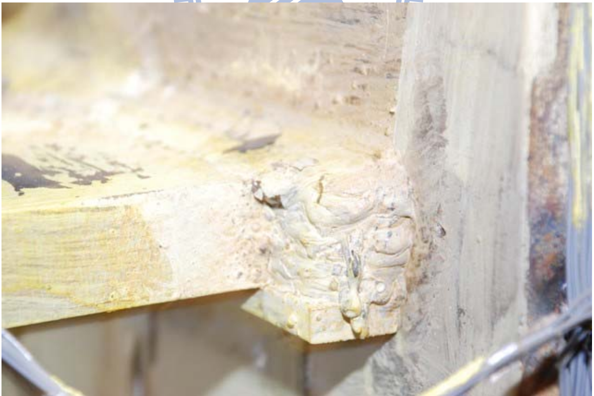
照片 3.14 試體 UR 梁下翼板與柱板接合之焊道產生裂縫 ( \theta = +2\% 弧度)
