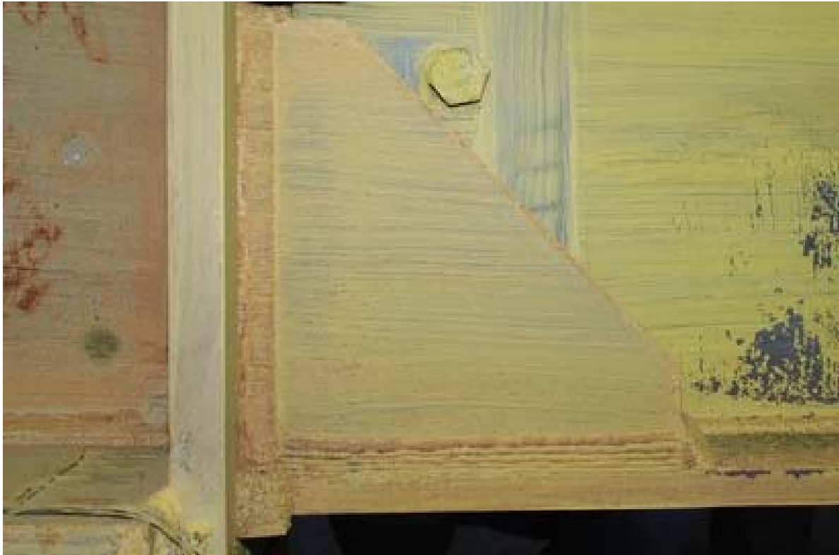
照片 3.99 試體 IFS3 加勁板降伏情形 ( \theta = +3\% 弧度)
