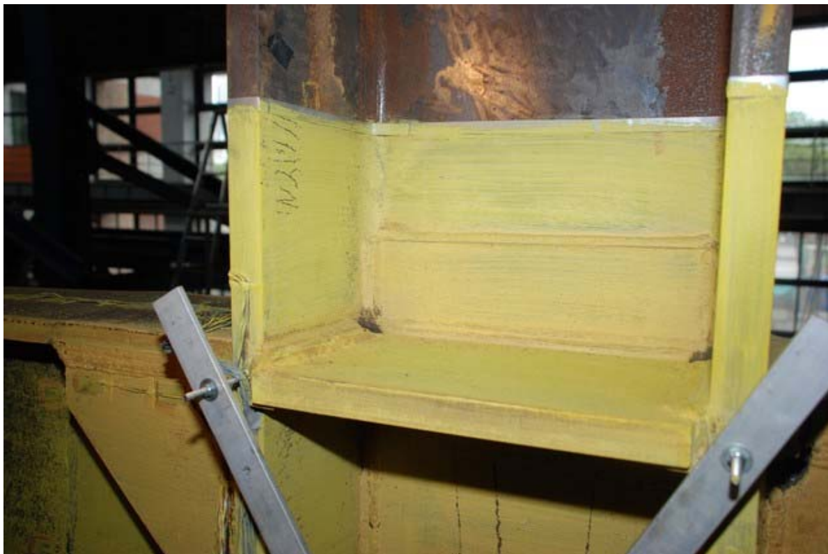
照片 3.135 試體 IFS3 上橫隔板上方內側柱板降伏 ( \theta = +6\% 弧度第一圈)
