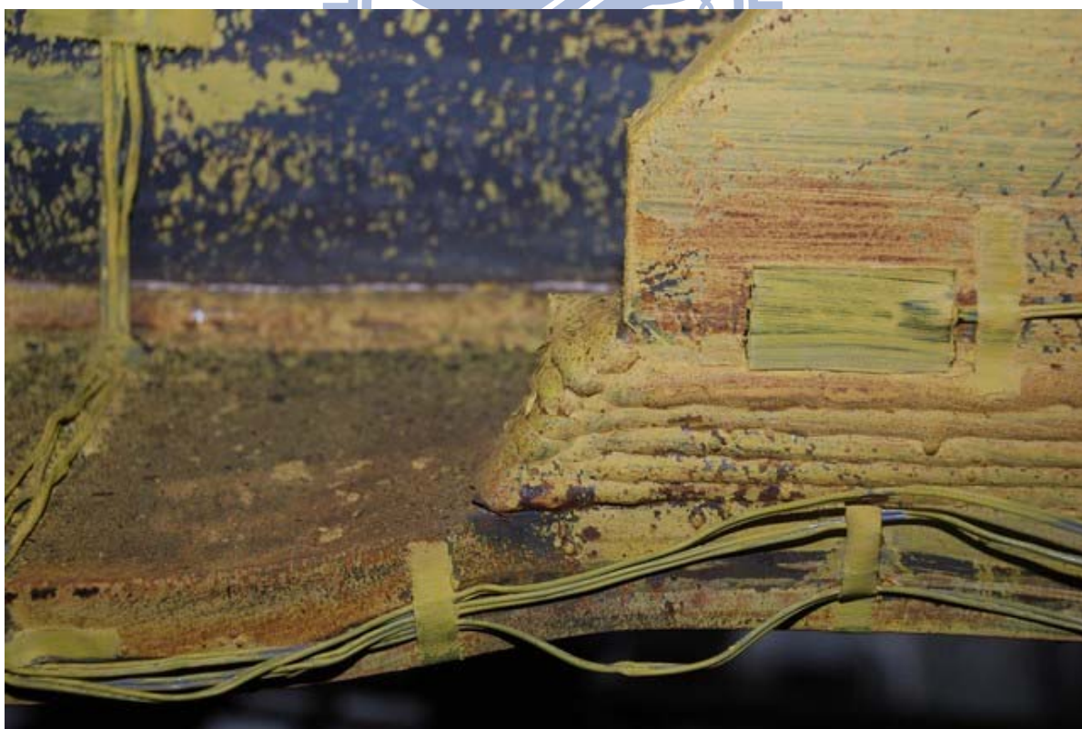
照片 3.130 試體 IFS3 加勁板焊道端部開裂情形 ( \theta = -6\% 弧度)
