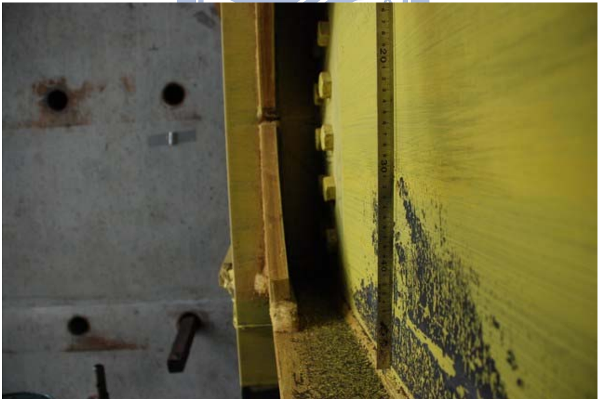
照片 3.112 試體 IFS3 梁腹板於塑鉸處產生 3mm 挫屈 ( \theta = -3\% 弧度)
