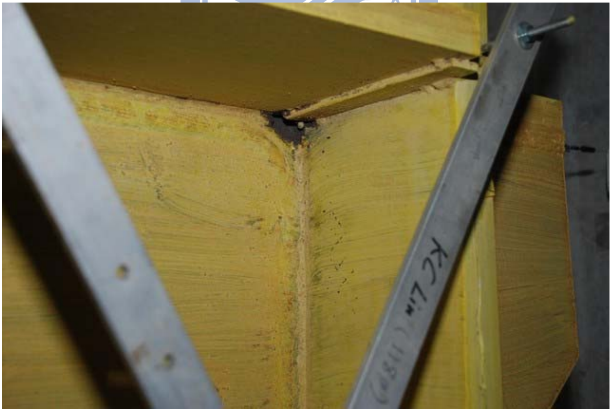
照片 3.96 試體 IFS3 交會區柱板內側出現降伏 ( \theta = +2\% 弧度)
