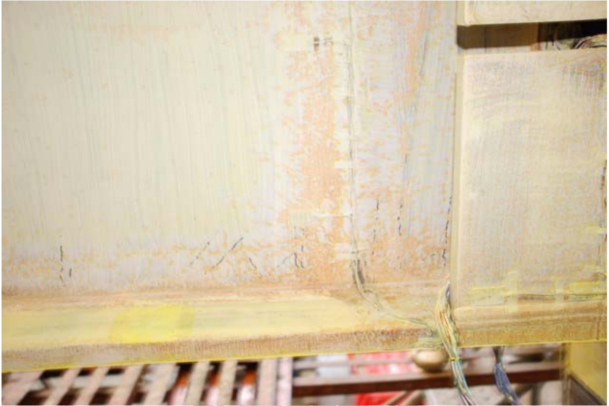
照片 3.33 試體 IFS1 梁腹板降伏範圍擴大 ( \theta = +1\% 弧度)
