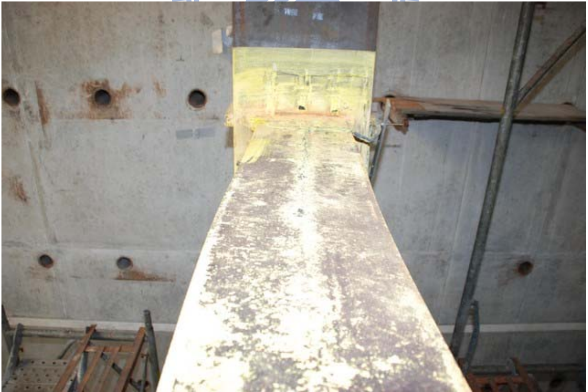
照片 3.50 試體 IFS1 梁上翼板挫屈情形 ( \theta=4\% 弧度結束)
