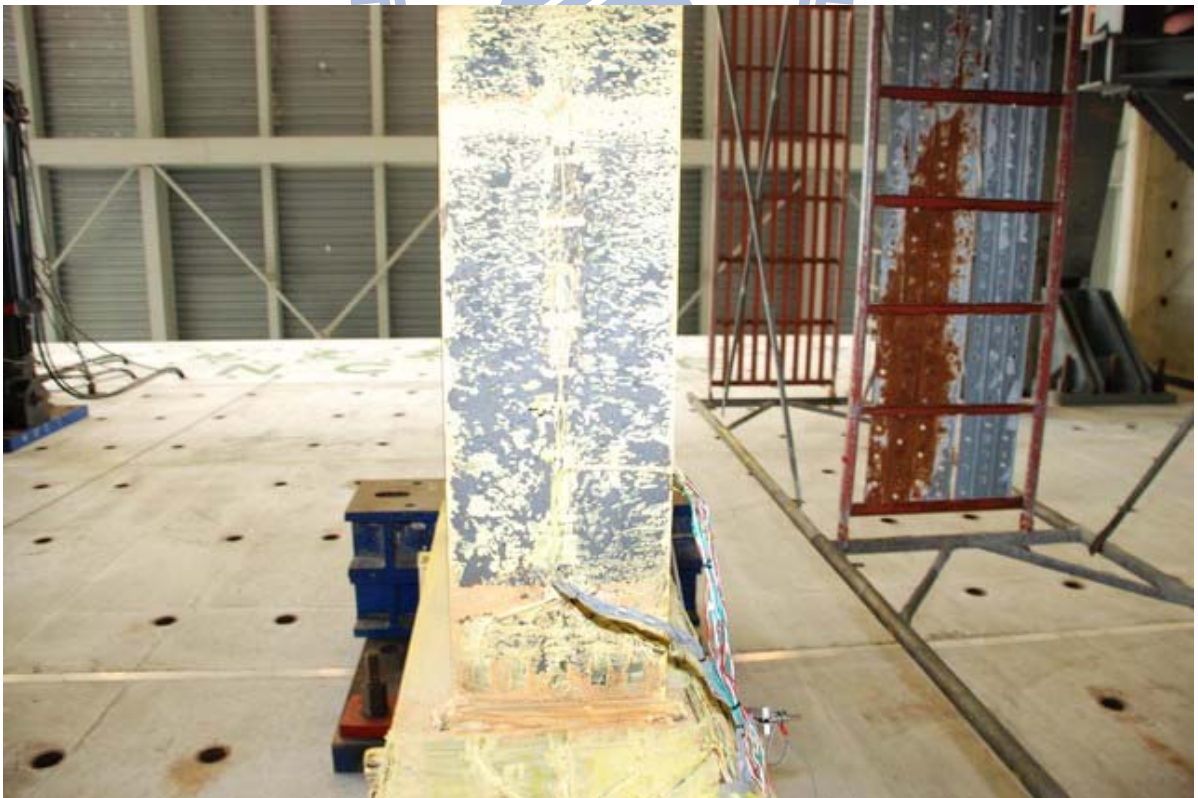
照片 3.40 試體 IFS1 梁下翼板降伏擴大 ( \theta = +3\% 弧度)
