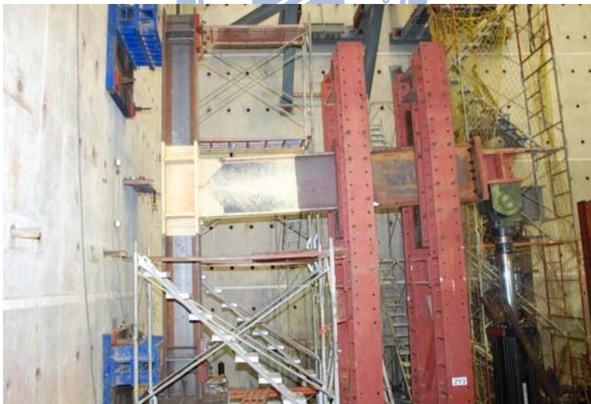
照片 3.84 試體 IFS2 最大位移角之全景 ( \theta = +5\% 弧度)
