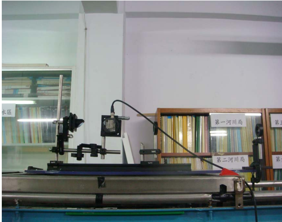
圖 3-1 C-PIV 儀器架設圖
