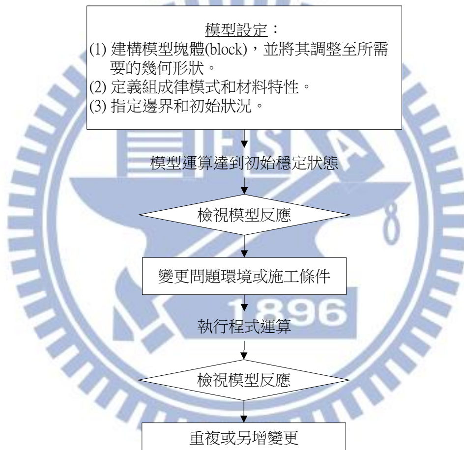
圖 3.6 UDEC 模型一般運算流程(Itasca, 2004)
