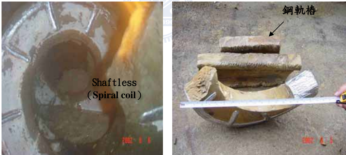
(a) 螺運機內無軸式螺旋葉片帶磨損
