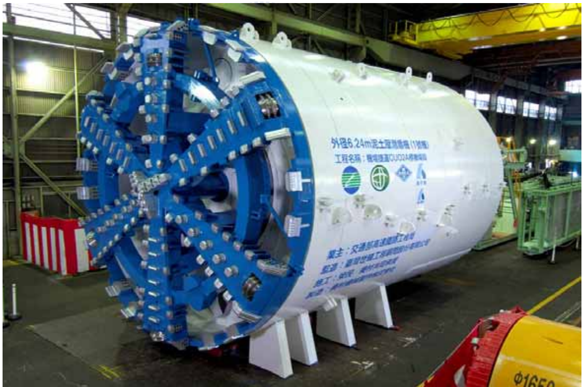
圖 6-7 桃園國際機場捷運 CU02A 標潛盾隧道施工採用之泥土壓潛盾機 (I 號機) (摘自台灣世曦顧問 2009)
