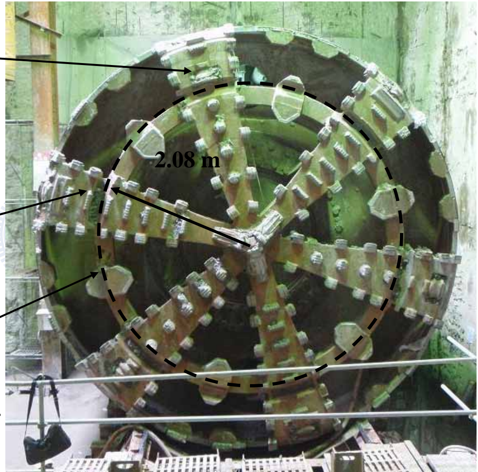
圖 6-17 1 號潛盾機出土時切刀轉盤磨損情形
