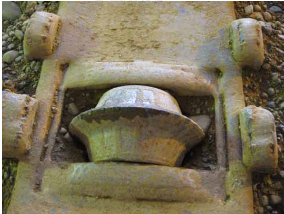
(b) 切刀轉盤上滾輪切刀之磨損
