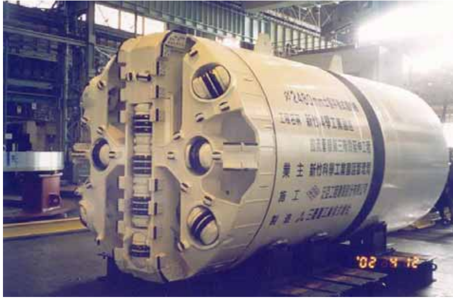
圖 4-18 竹科園區三期之三污水處理廠採用之土壓平衡式潛盾機 (中華顧問 2002)
