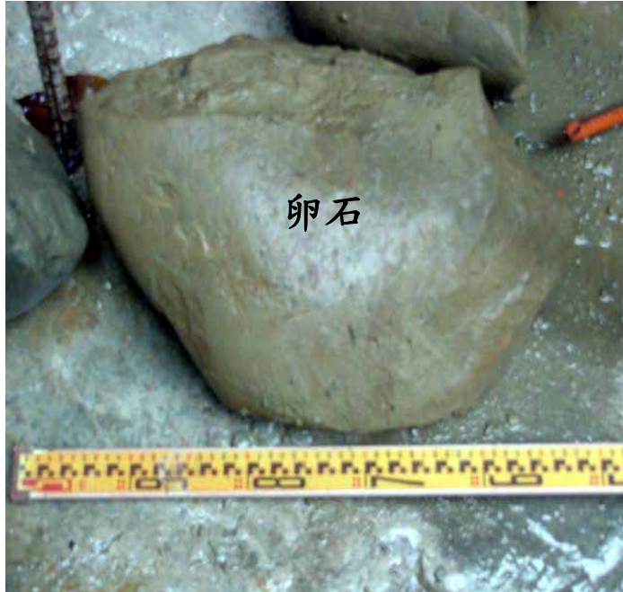
圖 4-14 潛盾施工遭遇之大顆粒卵礫石 ( \phi = 400 \text{ mm} ) (中華顧問 2003)
