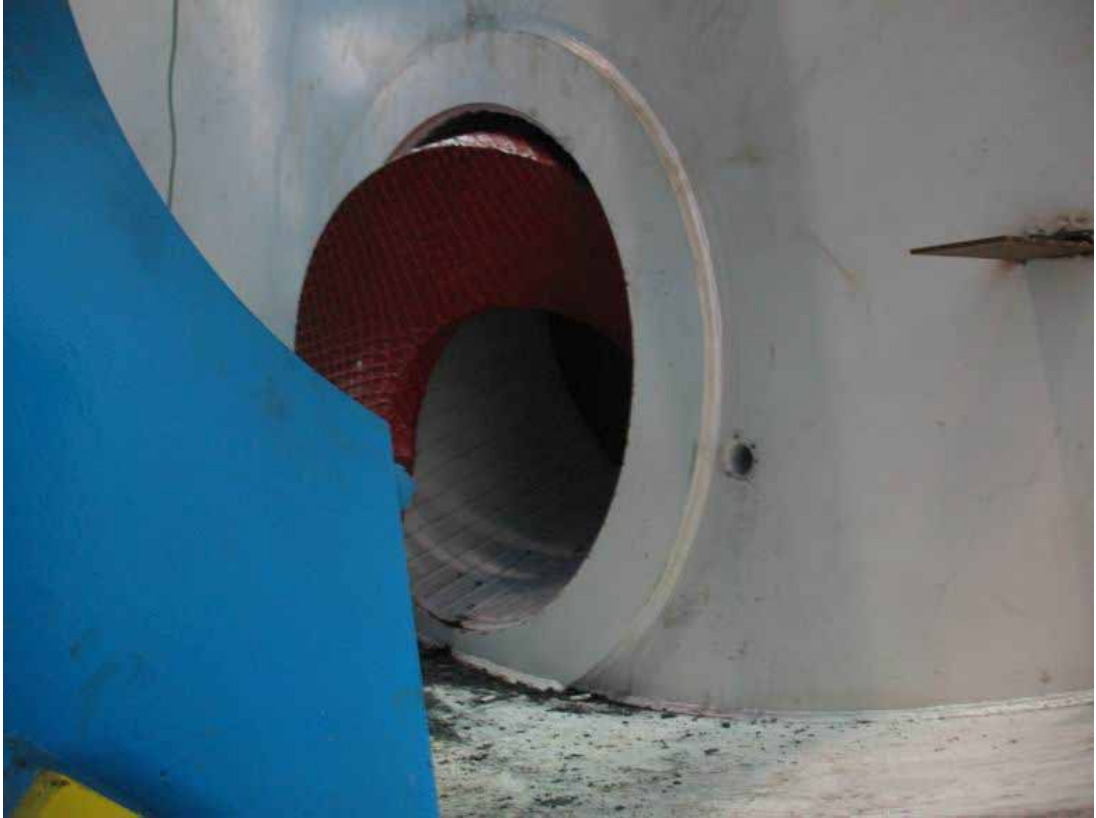
圖 5-10 潛盾機採用無軸式螺運機之土倉進土口 (介興/清水營造 2009)
