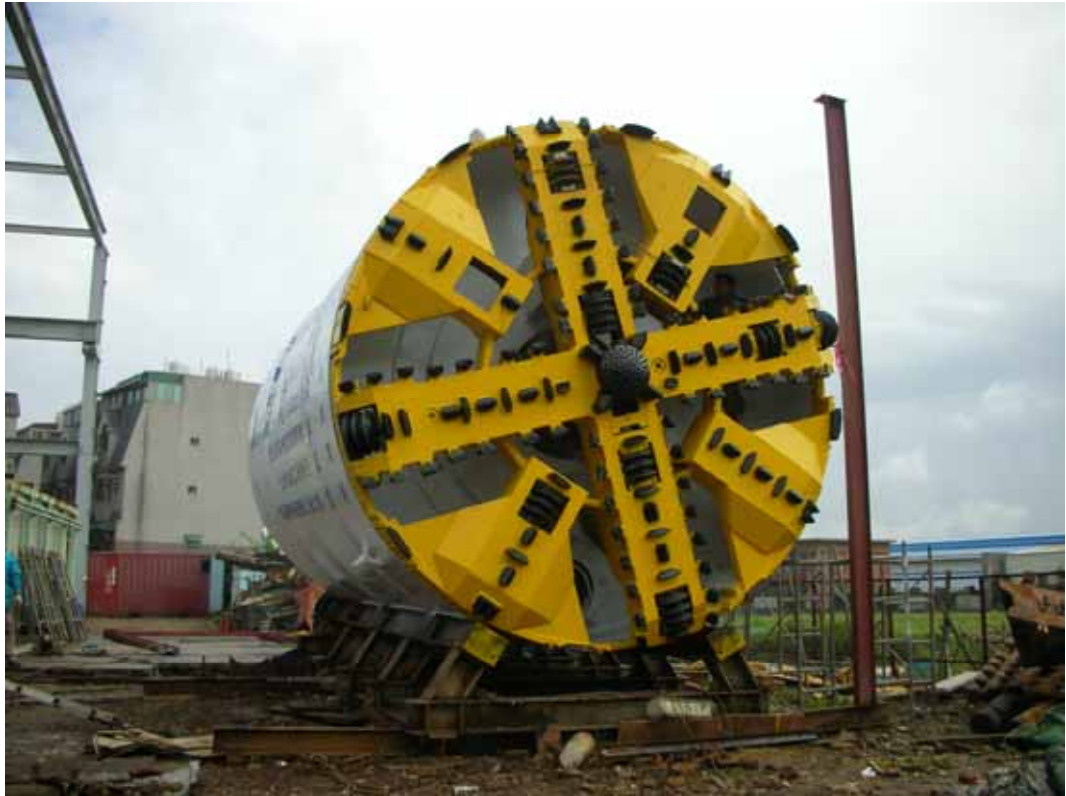
圖 5-3 新工～湖北電纜線路工程採用之加泥式土壓平衡潛盾機(中華顧問 2004)
