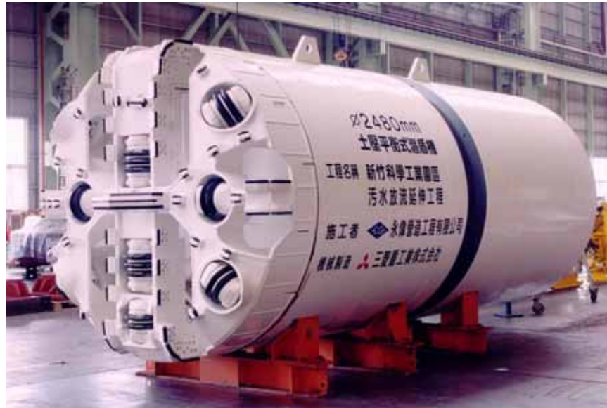
圖 4-9 園區三期之二污水處理廠採用之土壓平衡式潛盾機 (中華顧問 2003)
