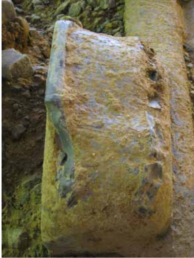
(a) 切刀轉盤上固定切刀之磨損
