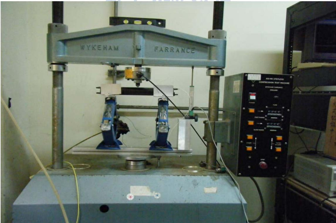
圖 4.20 三點彎曲試驗施加荷重狀況(一)
