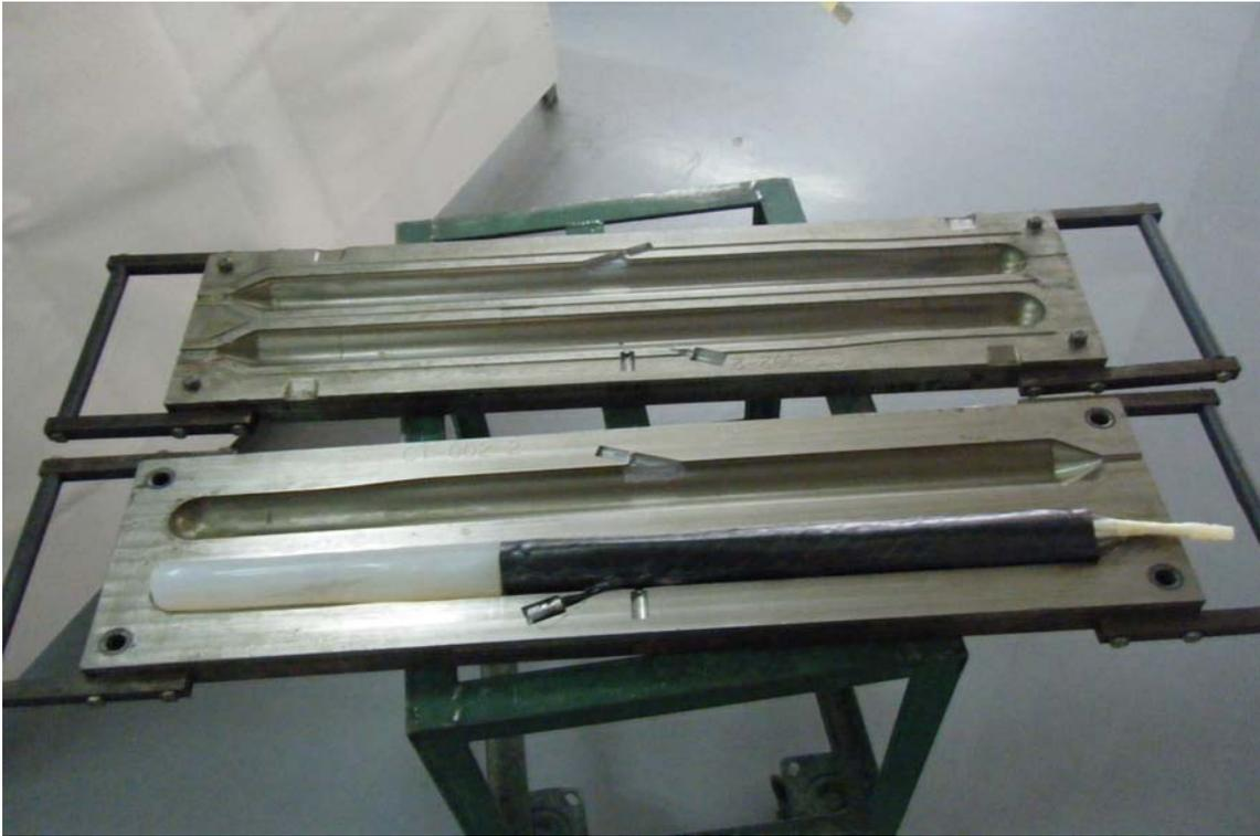
圖 3.14 碳纖管內埋設光纖線成型前
