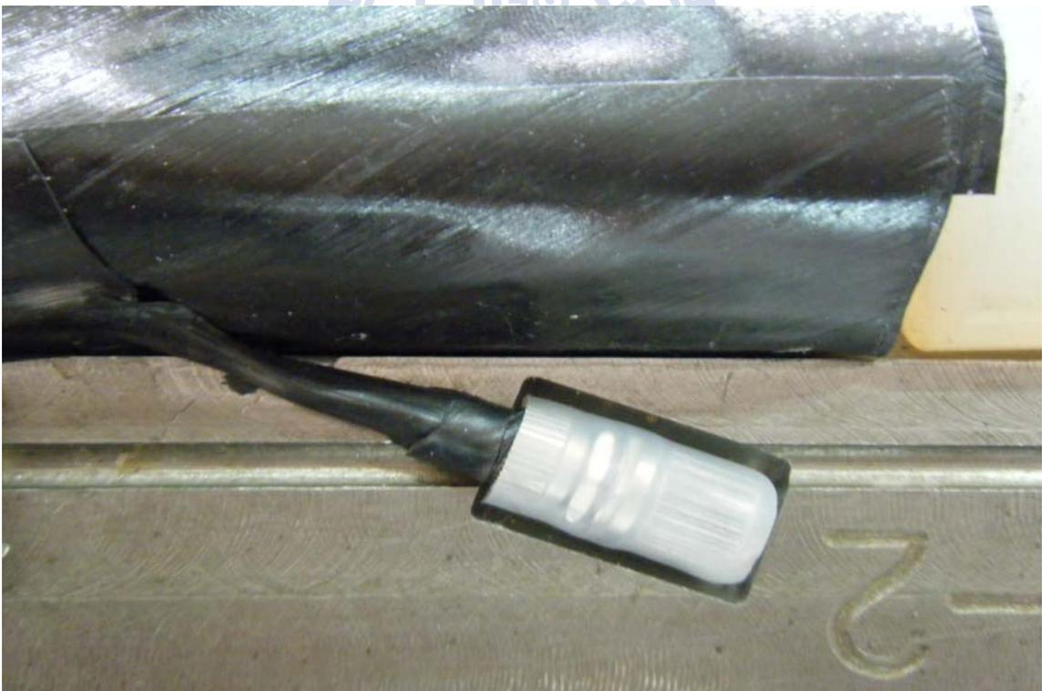
圖 3.13 接頭套上耐熱橡膠
