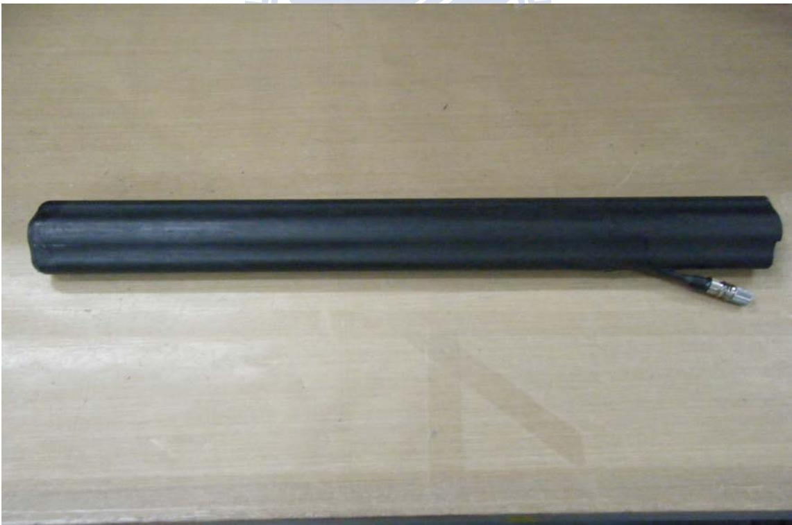
圖 3.15 碳纖管內埋設光纖線成型後
