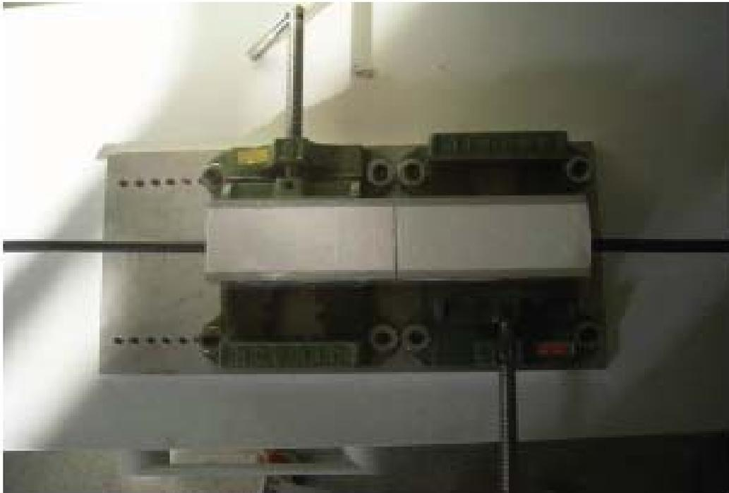
圖 2.12 光纖與 TDR 之錯動變型實驗剪動變形器
