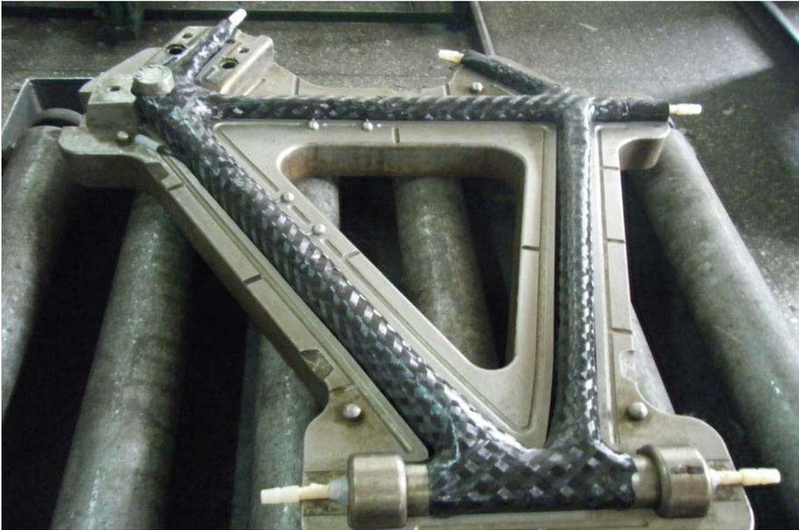
圖 3.26 貼好的車架放入模具內準備加熱成型
