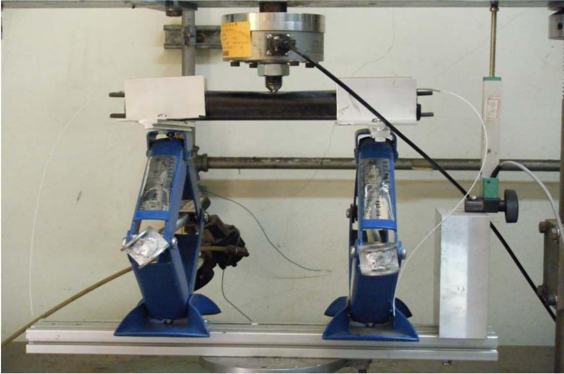
圖 4.21 三點彎曲試驗施加荷重狀況(二)
