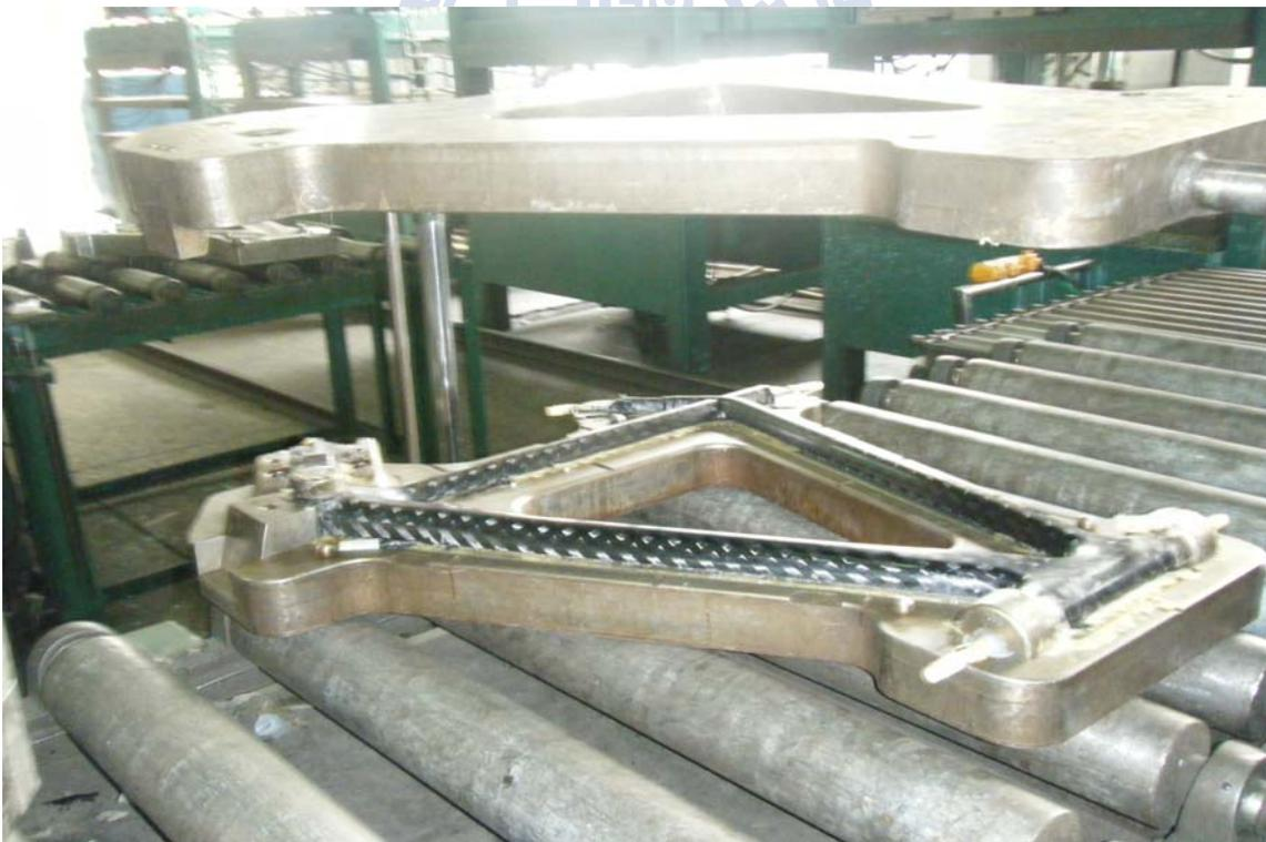
圖 3.27 車架成型後開模
