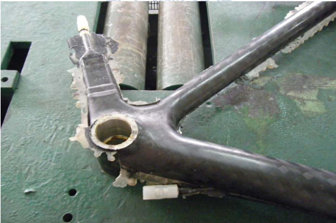
圖 3.29 車架取出模具後(尚未修邊處理)
