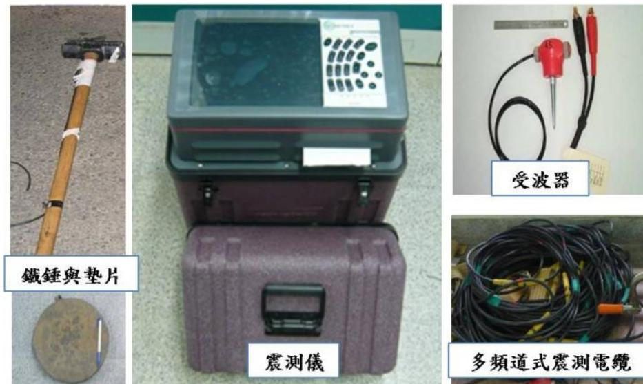
圖 3.2 表面波震測儀器
