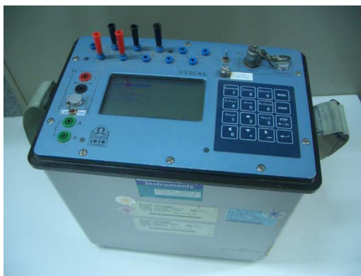
圖 3- 5 地電阻探測儀-SYSCAL PRO Switch 48
