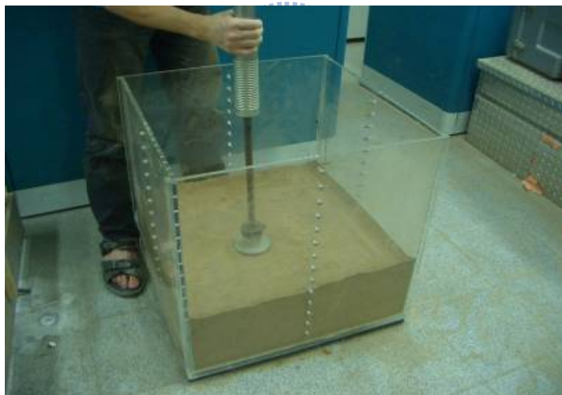
圖 3-3 大型夯錘將土樣分層夯入砂箱(姚奕全，2007)
