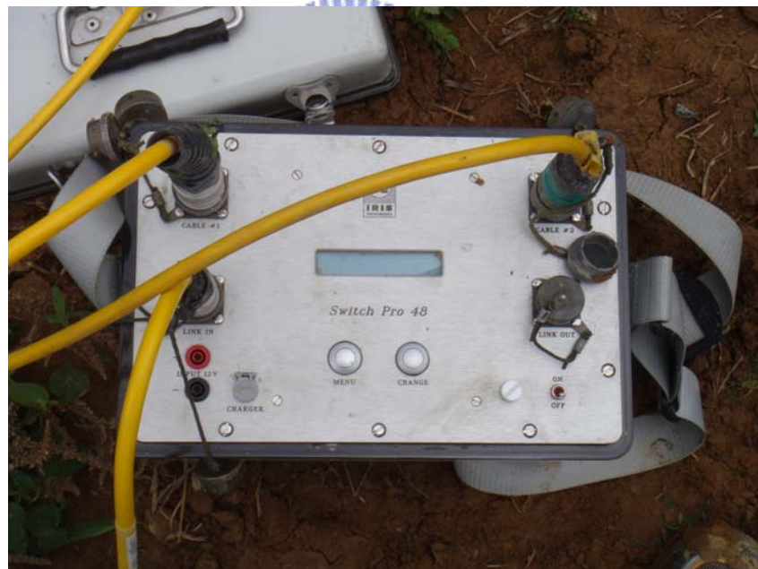
圖 4-2 試驗主機-SYSCAL PRO Switch Pro box
