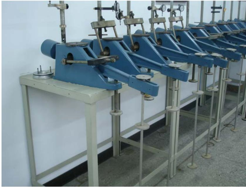
圖 2-2 壓密試驗儀
