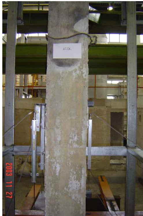
圖 28 LVDT 安裝相片
