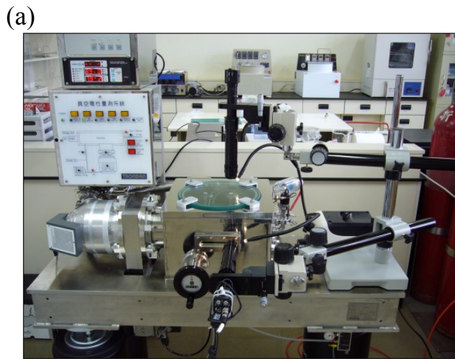
圖 3.8 真空電性量測系統 (a) 真空腔體與真空幫浦 (b) 真空腔體內部圖。
