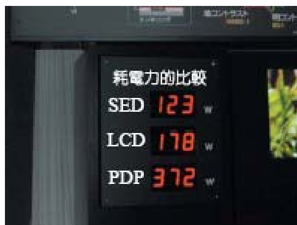
圖 1.9 三種不同顯示器耗能比較。
