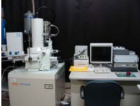
圖 3.4 交通大學材料系熱場發射式 JSM 6500F SEM。
