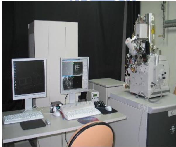
圖3.2 交通大學材料系的聚焦離子束機台。
