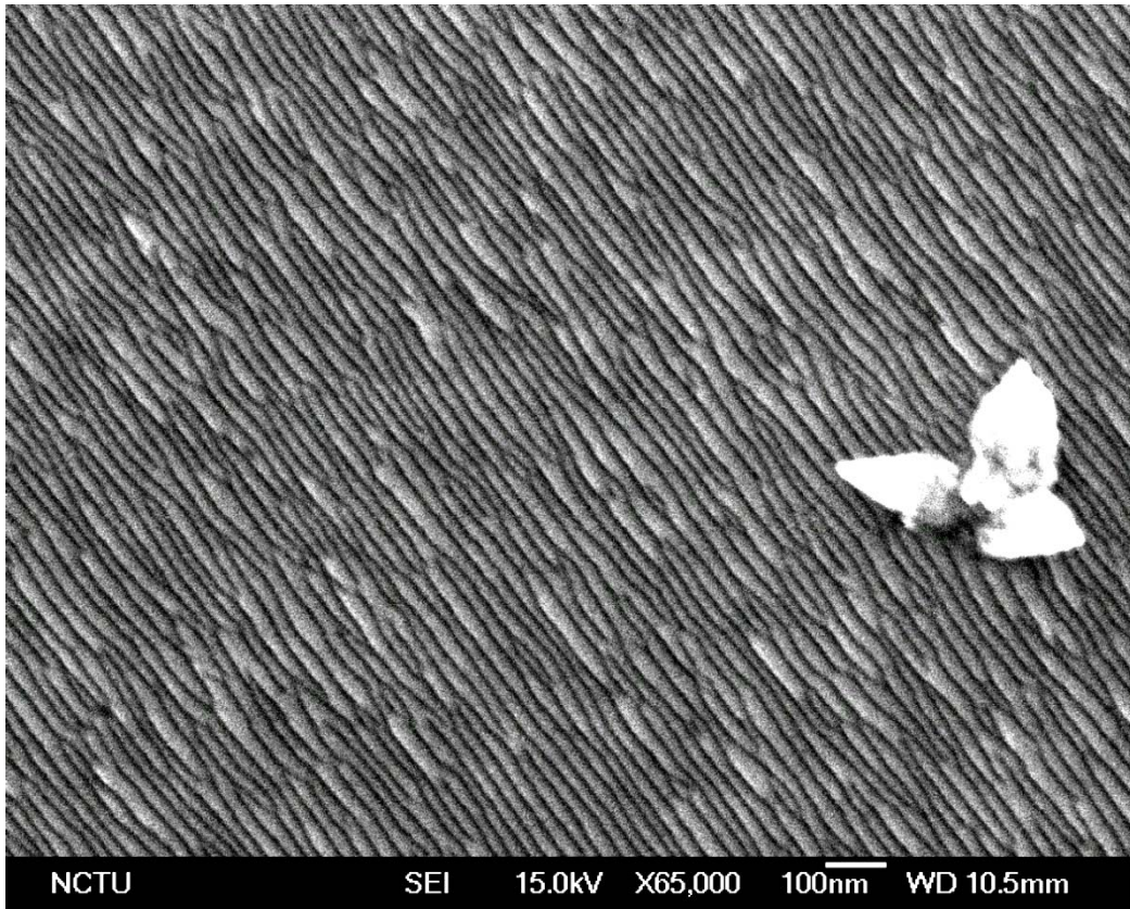
圖 4-18 基板溫度為 700°C，23 號試片的 SEM 影像。
