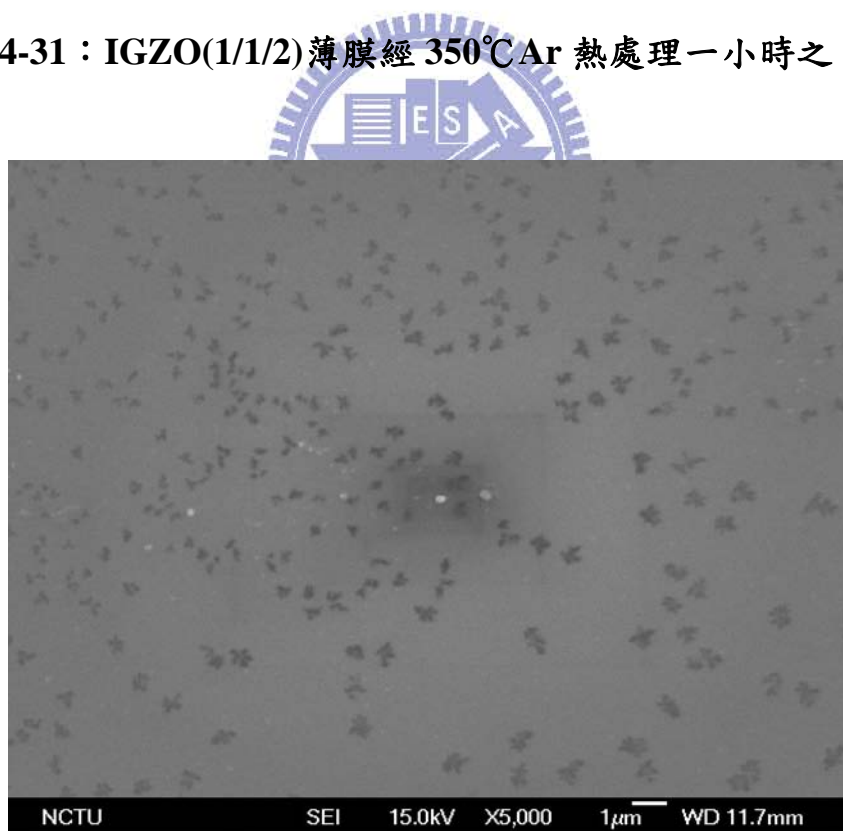
圖 4-32 : IGZO(1/1/2)薄膜經 400°C Ar 熱處理一小時之 SEM 圖
