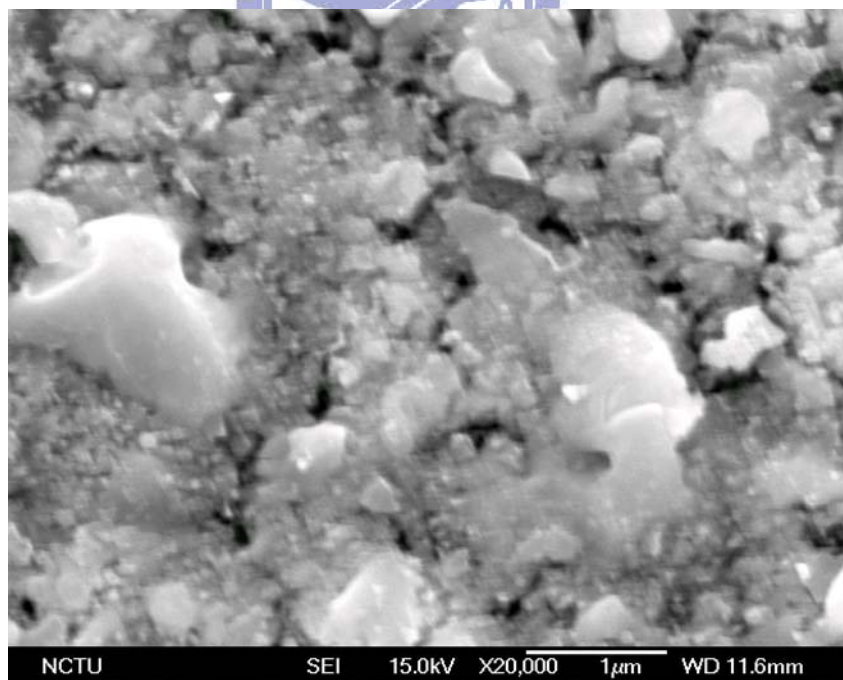
圖 4-25：經 400°C Ar 熱處理一小時後再經 450°C (10% H 2 +90% N 2 ) 熱處理後 IGZO(5/1/2) 薄膜的 SEM 圖
