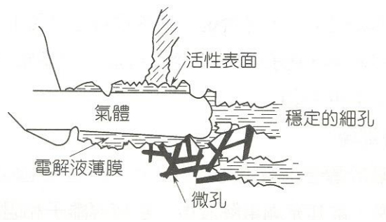
圖 2-11. PTFE 排水劑黏合型電極示意圖 [31]。
