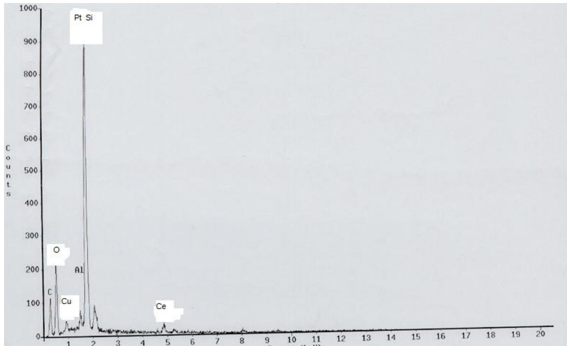
圖 4-2、Cu/Ce/ZSM-5(imp.)之 EDS 訊號圖譜
